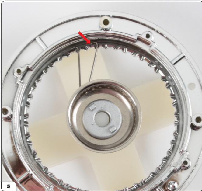
Fädle eine weitere Speiche durch das nächste Loch in der unteren Reihe und hake die Spitze um den nächsten breiten Zahn (Pfeil). Beim Einsetzen der restlichen Speichen kannst Du die Spannung durch Drehen der Radmitte mit dem Daumen vorsichtig einstellen.
