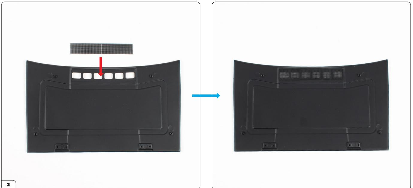
Coloca el capó (1-A) boca abajo y luego sitúa la rejilla de admisión de aire (1-C) en el hueco como se muestra. La rejilla se puede colocar de cualquier lado.
