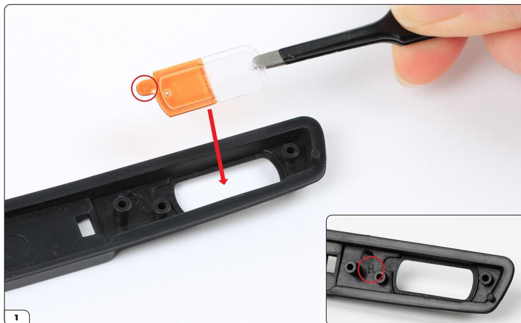
Toma la lente delantera derecha (2-D) y ajústala en el lado derecho del panel del parachoques delantero (2-B). La lente y el panel están marcados con una 'R' (encerrada en un círculo).
