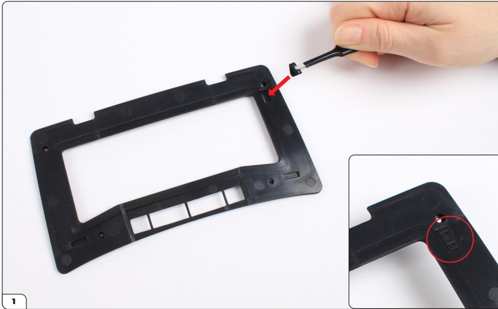
Toma el bastidor auxiliar del capó (1-B) y coloca el soporte de la suspensión (1-D) sobre los dos pernos como se muestra.
