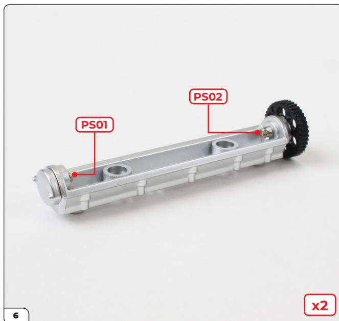
Repite los pasos del 1 al 5 con la otra tapa inferior del árbol de levas, fijando la tapa y el engranaje restantes con un tornillo PS01 y PS02 como se muestra.
