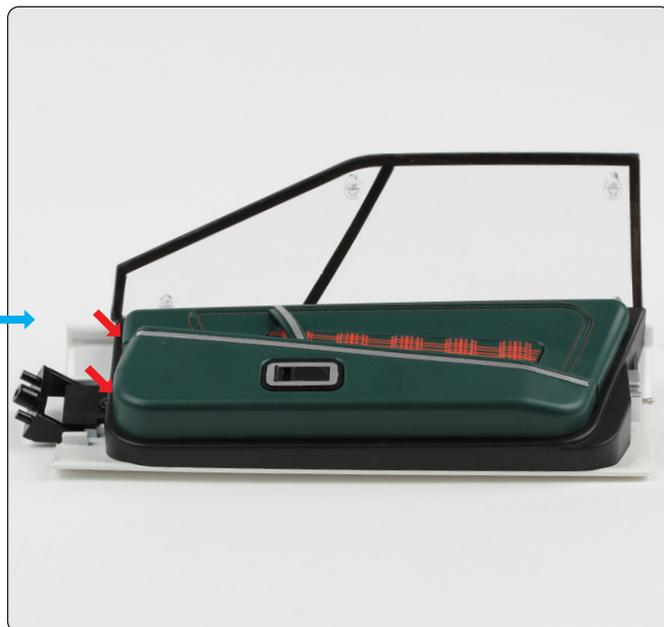
Collega il pannello interno (fase 005) al telaio inserendo le linguette nelle fessure e quindi premendo saldamente sull'estremità opposta fino a quando non si blocca in posizione.
