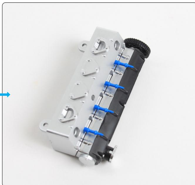
Allinea il coperchio dell'albero a camme destro (con il tappo dell'olio) e la testata del cilindro del motore come mostrato, poi monta il coperchio in posizione. La posizione del perno nero significa che c'è solo un modo in cui le parti possono incastrarsi.
