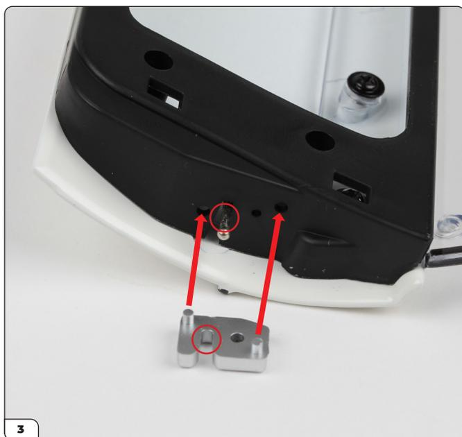
Posiziona la serratura della porta destra (6-B) in posizione, premendo i suoi perni nei fori. Allo stesso tempo, infila l'apertura a forma di U sotto il perno sporgente (cerchiato).
