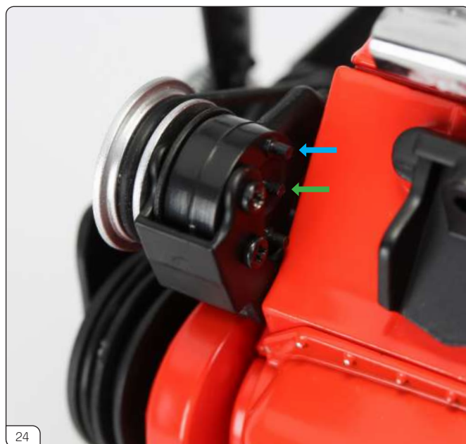
エンジンアセンブリを取り出します。ステアリングポンプキャップの2本の突起を確認してください。
