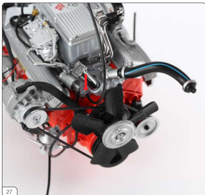
ケーブル (127mm) をファン後方にある突起に差し込みます (赤矢印)。
