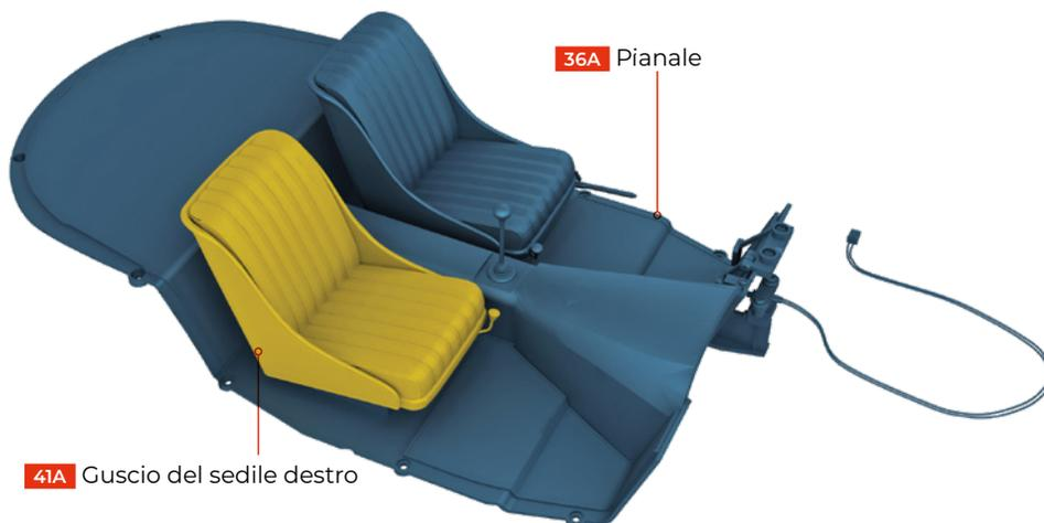
Posiziona il guscio del sedile destro **41A** sul lato sinistro del pianale **36A**, assicurandoti che le linguette al di sotto del sedile si inseriscano nelle scanalature ricavate nella parte rialzata del pianale. Capovolgi il pianale e posiziona la rondella **41D** sopra la bussola centrale presente sotto il sedile. Fissa il sedile con una vite **NP** calzata attraverso la rondella. (fig. 1)
