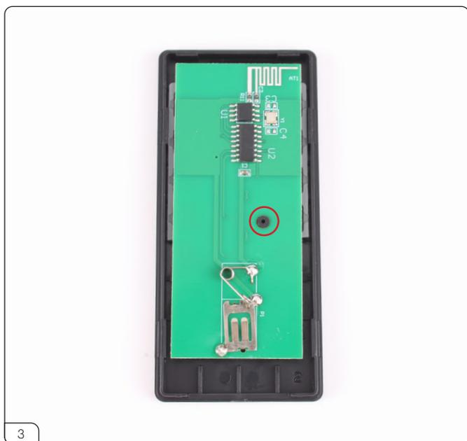
画像のように、リモコンフロントケースの支柱 (赤丸印) にサーキットボードの穴を合わせて配置します。
