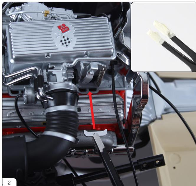
ピンセットを使い、画像のように片方のエンジンマウントプラグをはめ込みます (赤矢印)。エンジンマウントプラグに傷がつがないように、ピンセットの先にマスキングテープを巻いて作業をしましょう (右上小写真)。
