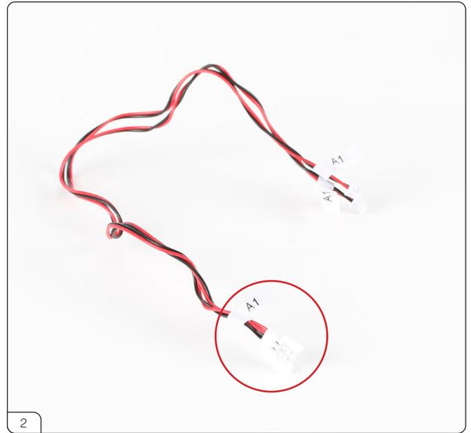
ケーブルの接続は、同じタグの付いた延長ケーブルのソケットを、対応するスプリッターケーブルのプラグに接続します。まずは「A1」です。
