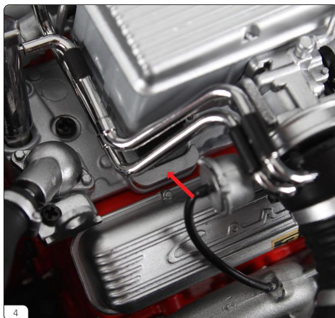
残りのエンジンマウントプラグを所定の位置に押し込みます。
