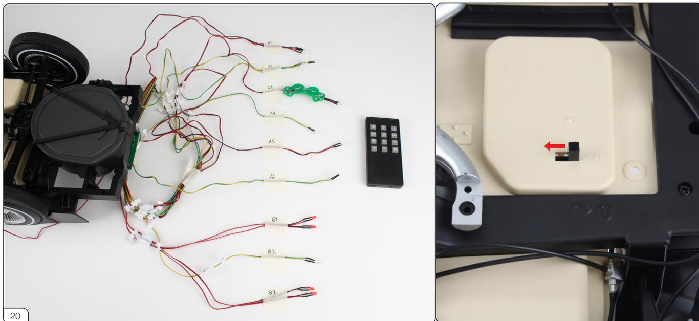
LEDライトなどの点灯を確認します。画像のように、マスキングテープなどにLEDのタグ記号を書いてLEDの近くに貼ります。室内照明を落とすと確認しやすくなります。電源スイッチをオンにしてください(赤矢印)。
