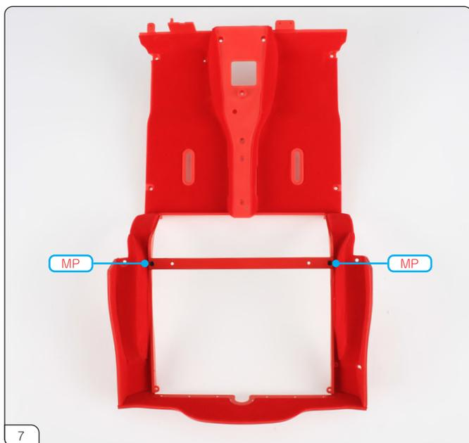
MPネジ2本でクロスメンバーを固定します。
