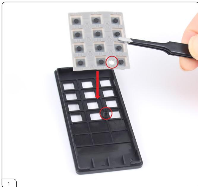
リモコンフロントケースの支柱 (赤丸印) とキーパッドの穴を合わせて、キーパッドをリモコンフロントケースにはめ込みます。
