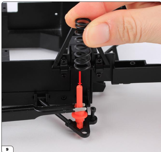
Coloque el muelle (23-C) sobre el eje.
