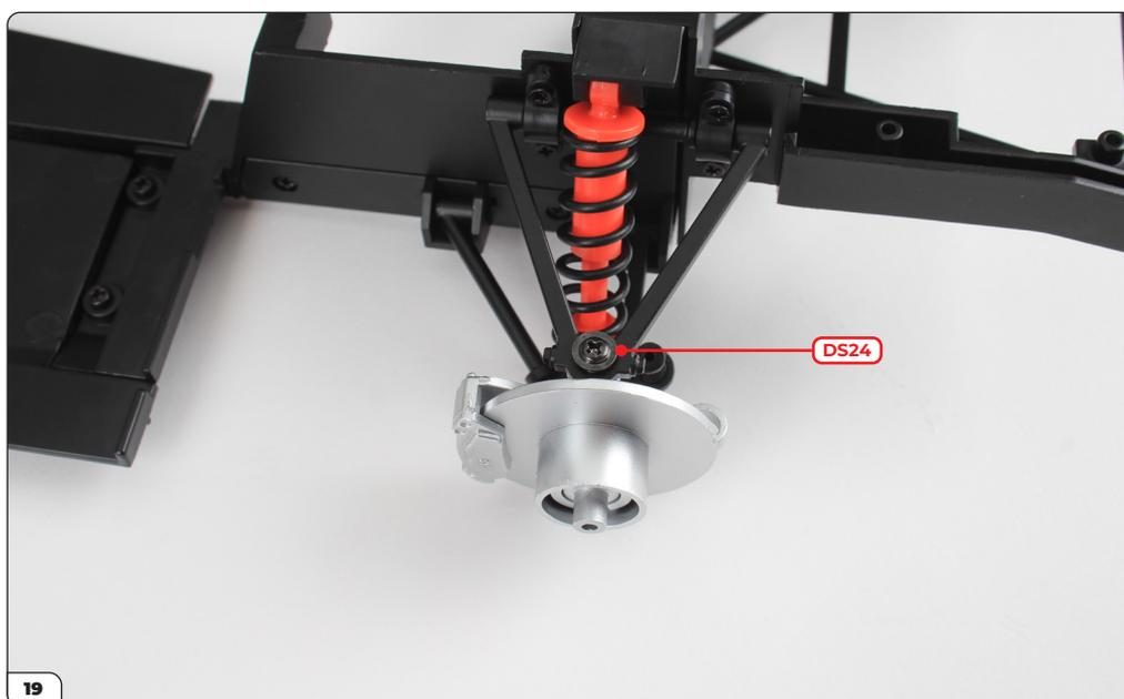
Asegure el brazo de control superior con otro tornillo DS24.
