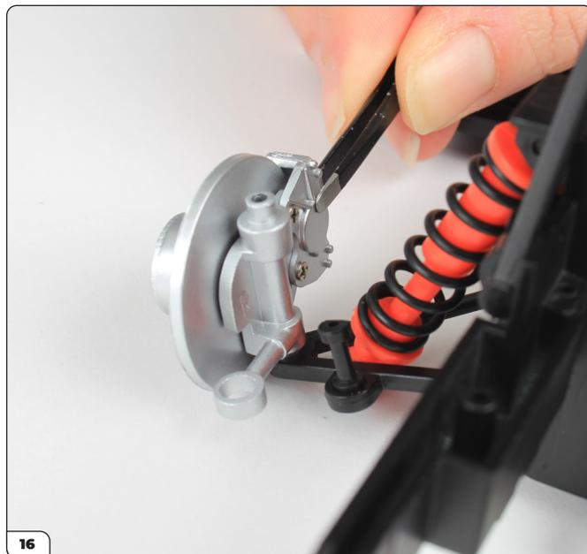
Levante el brazo de control superior. Encaje el buje de la rueda derecha en el brazo de control inferior.
