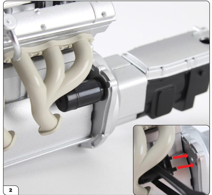
Introduzca los pasadores de la bomba del aceite (17-B) en los dos orificios pequeños del montaje del motor (recuadro).
