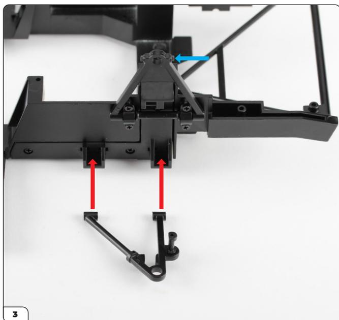
Alinee el brazo de control inferior con el lado derecho del chasis delantero. Levante el brazo de control superior para apartarlo (flecha azul).
