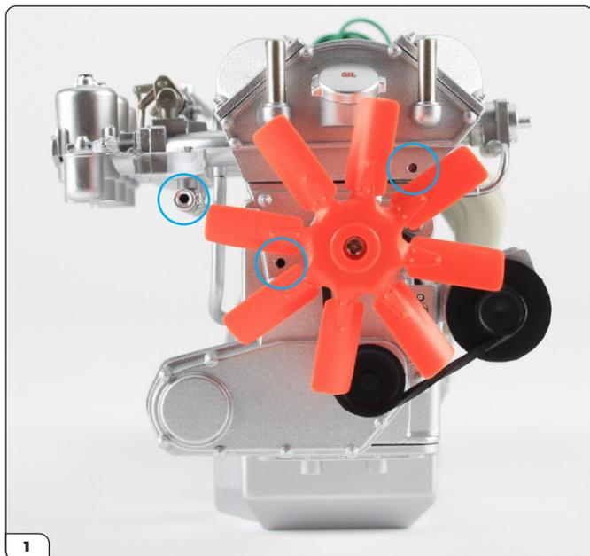
Posicione el montaje del motor con la parte frontal mirando hacia usted y localice los tres orificios para montar el tubo de distribución del aceite.
