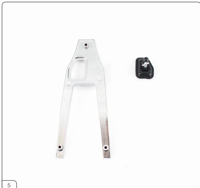
画像のように、センターコンソールパネルを裏返して置きます。これにギアスティックカバーを取り付けます。
