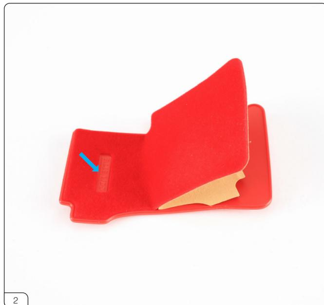
左フットウェルカーペットの開口部（青矢印）を、左フットウェルマットの口ゴに合わせて配置します。
