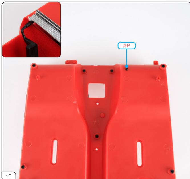
フロアアッセンブリーを裏返し、APネジでアクセルペダルを固定します。ペダルの先の細い部分の配置は、左上小写真を参考にしてください。
