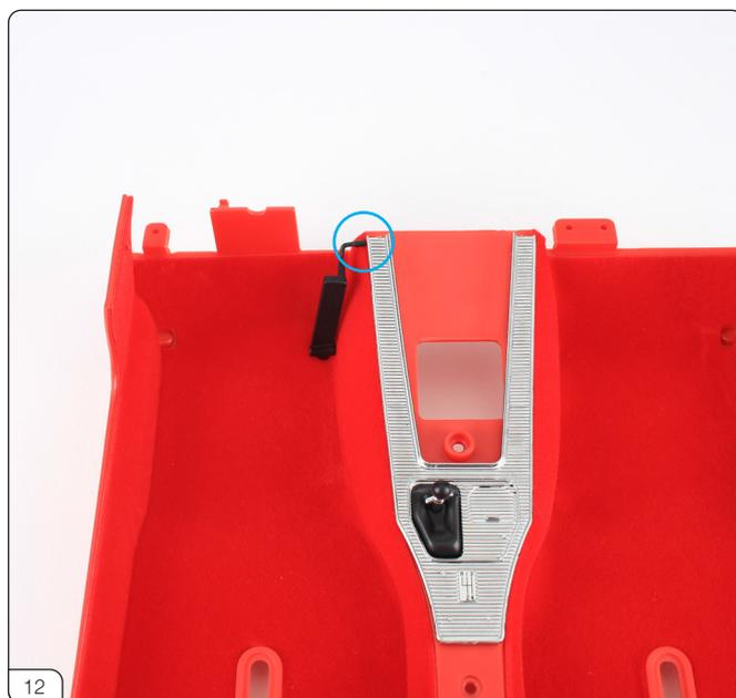
アクセルペダルを穴に押し込みます。ペダルの先の細い部分がセンターコンソールパネルに触れるようにしてください。
