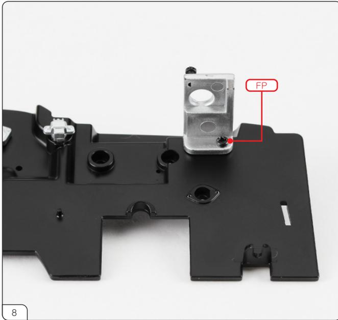
フードヒンジの1つをファイアウォールに配置し、FPネジで固定します。
