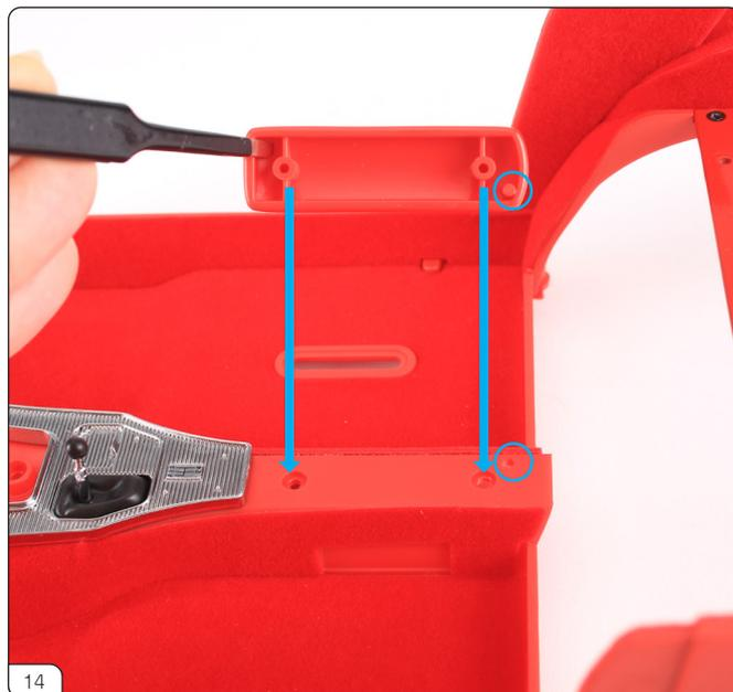
ハンドレストをフロアアッセンブリーに取り付けます。小さな突起と穴を合わせて取り付けます（青丸印）。
