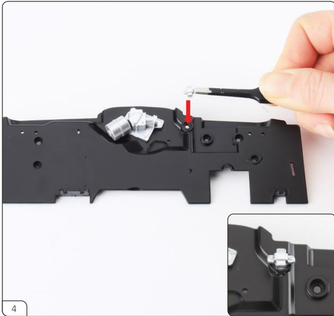
画像のように、ボルテージレギュレーターを穴に押し込みます。
