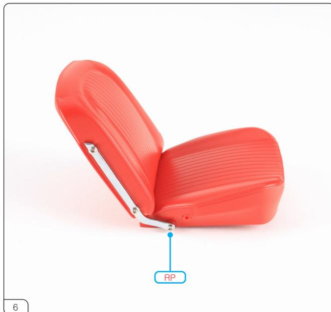
右ヒートヒンジをRPネジで固定します。
