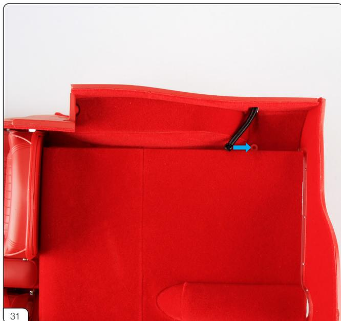
燃料タンクカバーの横にあるネジ穴を確認してください。スプリングのネジはここに固定します。
