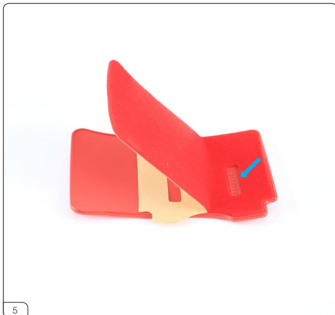
右フットウェルカーペットの開口部（青矢印）を、右フットウェルマットのロゴに合わせて配置します。
