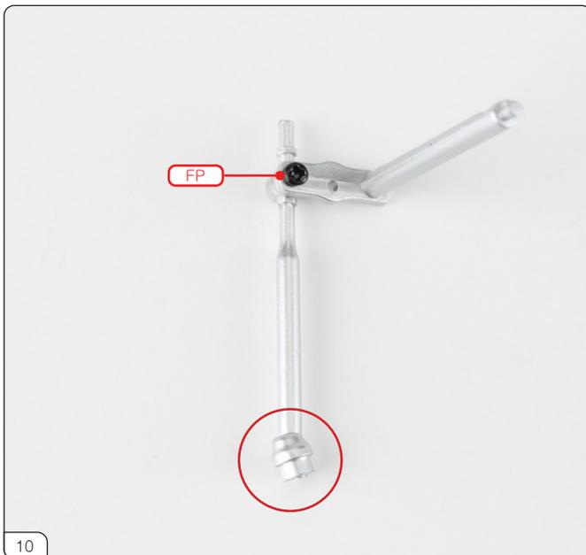
画像のように、プッシュロッドとクロスシャフトをFPネジで接続します。プッシュロッドの向きに注意してください(赤丸印)。また、ネジを締めすぎないでください。
