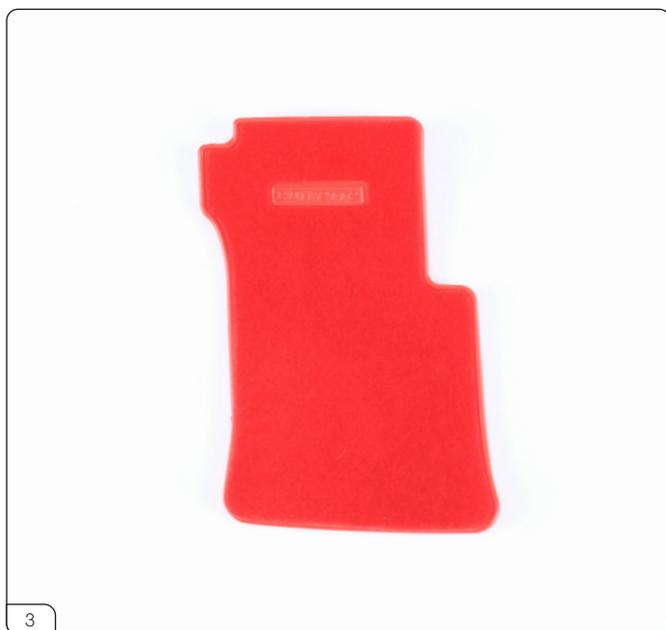
左フットウェルカーペットの裏紙を剥がしながら、左フットウェルマットに合わせてぴったりと貼ります。端をしっかりと押さえて、フィットさせてください。
