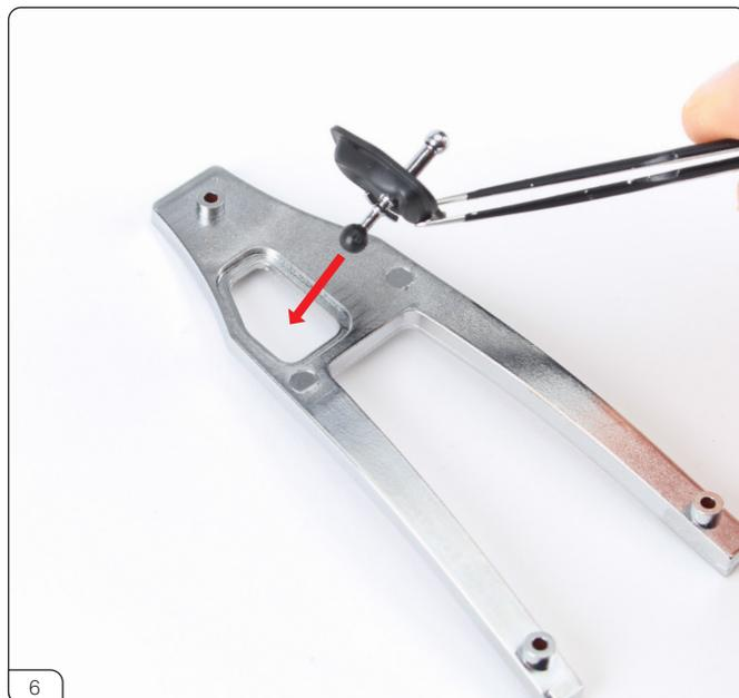
ギアスティックカバーを、センターコンソールパネルの穴にはめ込みます（赤矢印）。
