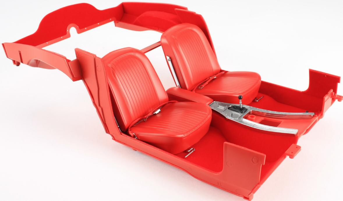
シートベルトバックルは、ドライバースシート（左側）は右サイドから、パッセンジャーズシート（右側）は左サイドから出るのが正しいセッティングです。この画像ではパッセンジャーズシート（右側）のセッティングが間違っています。本ステージの工程29の写真も、パッセンジャーズシート（右側）のセッティングが間違っています。組み立ての際には注意してください。これ以降の説明では、正しくセッティングされた写真を使っています。
