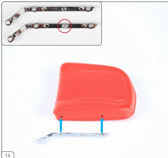
右側のシートについても、同様の手順を繰り返します。残ったシートバックレストに、「L2」（左上小写真）と記された左シートヒンジを合わせます（青矢印）。
