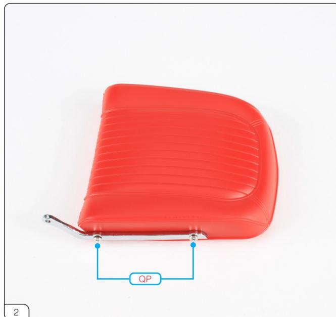
左シートヒンジをQPネジ2本でシートバックレストに固定します。
