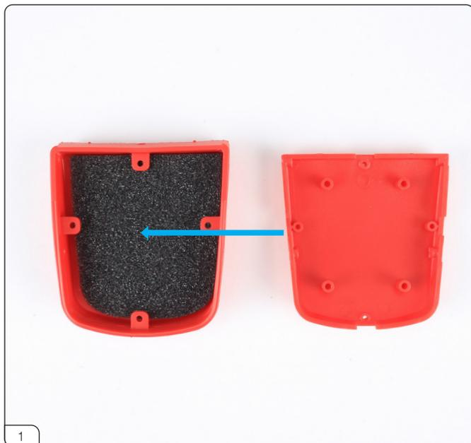
画像のように、ステージ®で組み立てたアッセンブリーにシートバックレストベースを配置します (青矢印)。
