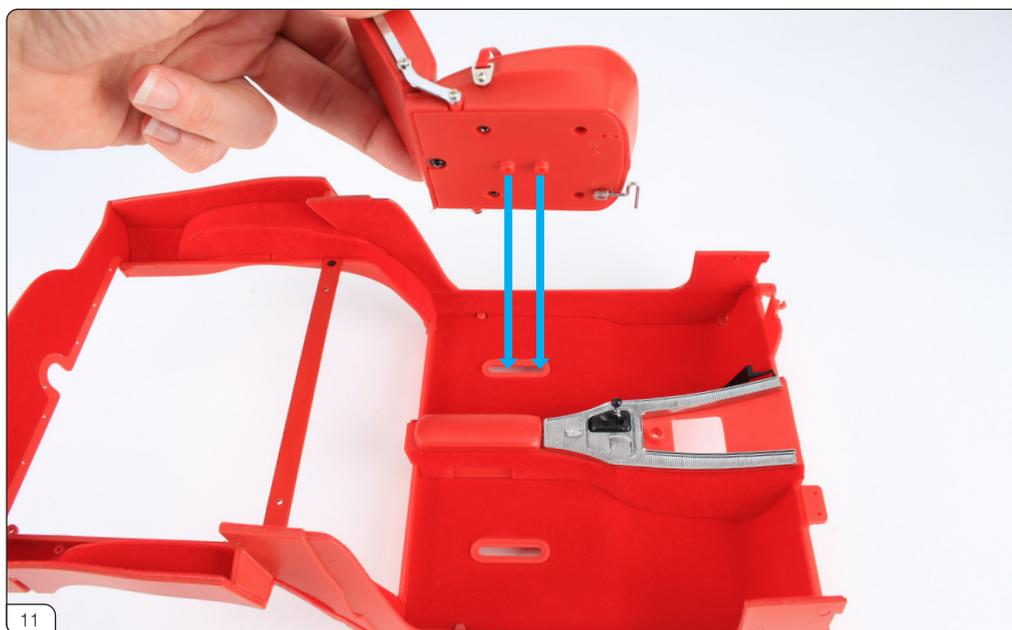
フロアアセンブリーの左側にシートを合わせます。シートベースのネジポストが、開口部に収まるように配置してください (青矢印)。
