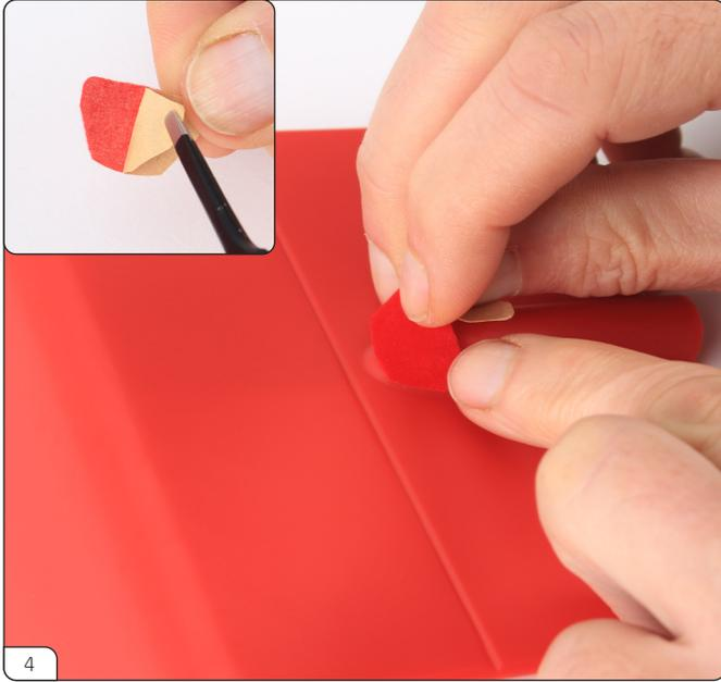
カーペット5の裏紙を半分剥がし(左上小写真)、燃料タンクカバーに貼り付けます。工程3のスペーシングを意識してください。
