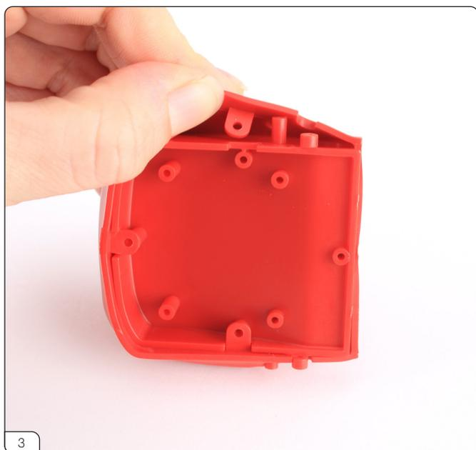
シートクッションのタブを調整して、シートクッションベースのネジ穴に合わせていきます。
