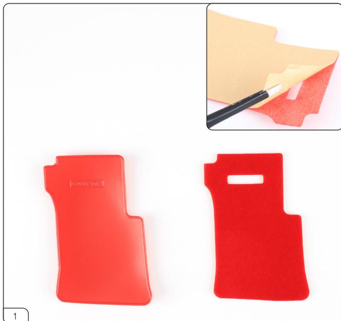
左フットウェルマットと左フットウェルカーペットを合わせます。まず、左フットウェルカーペットの裏紙を剥がします。剥がすのは、右上小写真程度です。まだ全部は剥がさないでください。
