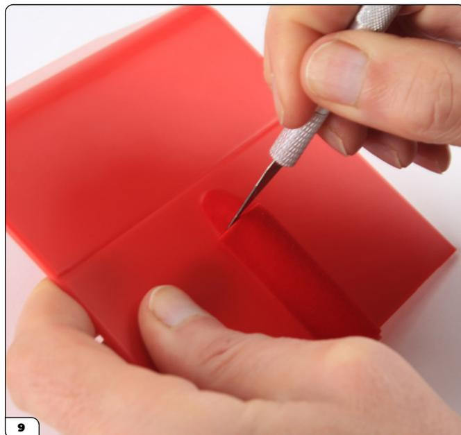
Es posible que las dos piezas de alfombra se sobrepongan. En este caso, puede usar una navaja para cortar delicadamente parte de la alfombra 5, utilizando el borde para guiar la cuchilla y obtener una unión homogénea entre las piezas.
