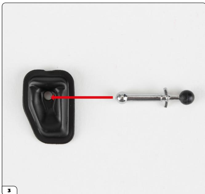
Alinee la base de la palanca de cambios con la palanca, como se muestra en la imagen. La rótula de la palanca encaja a través de la abertura de la base.
