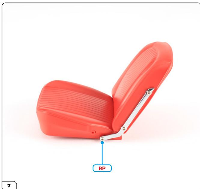
En el otro lado, fije la bisagra izquierda usando un tornillo RP.
