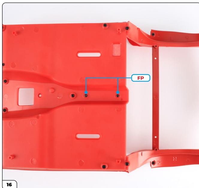
Dé la vuelta al montaje y asegure el apoyabrazos usando 2 tornillos FP.
