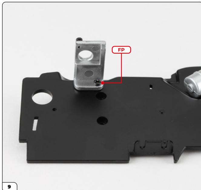
Encaje la bisagra restante en el otro lado del cortafuegos y asegúrela con un tornillo FP.
