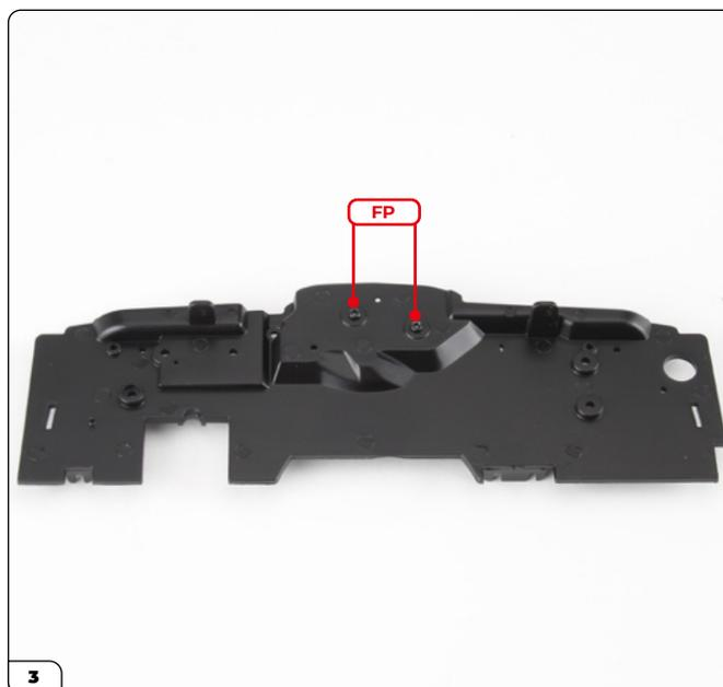
Dé la vuelta al cortafuegos y asegure el motor del limpiaparabrisas con 2 tornillos FP.
