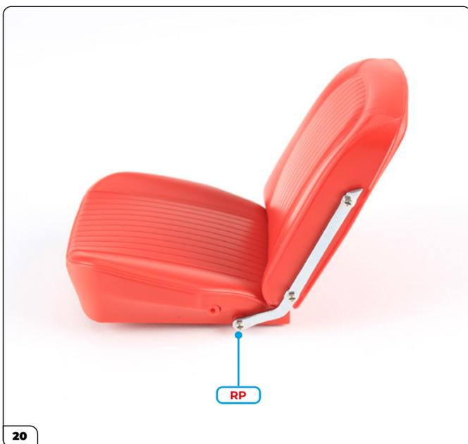
Fije la bisagra izquierda usando un tornillo RP.
