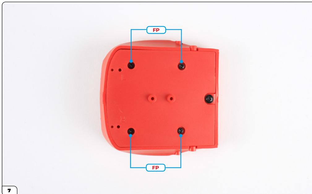
Encaje la cubierta y asegúrela con 4 tornillos FP.
