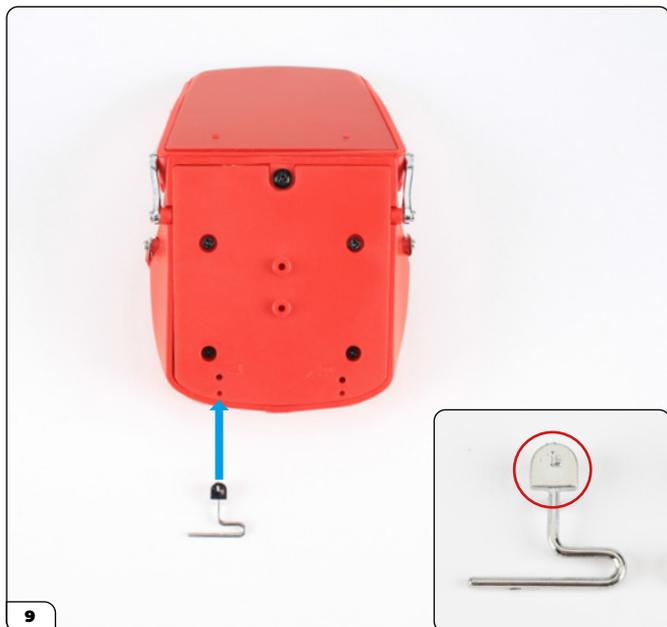
Tome la palanca de ajuste del asiento izquierdo (marcada con una "L", recuadro) y alinéela con la parte de abajo del asiento, como se muestra en la imagen.
