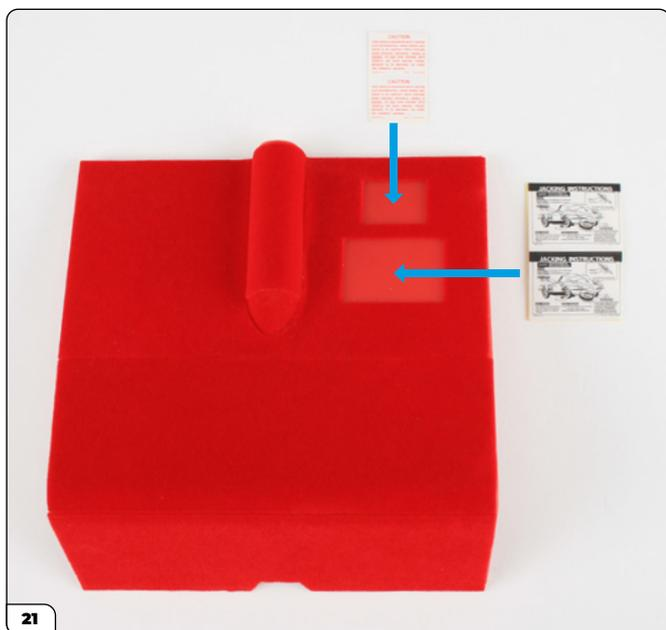
Tome los adhesivos de instrucciones del gato y de advertencia, los cuales encajan en las aberturas rectangulares en la orientación que se muestra en la imagen. Por cada adhesivo se ha proporcionado uno de repuesto.
