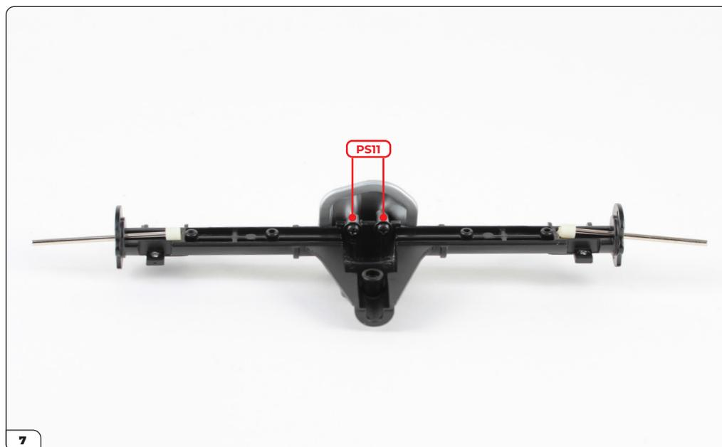
Halte die Abdeckung fest und befestige sie mit 2x Schrauben PS11.
