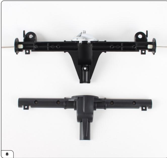
Fluchte die Hinterachse-Oberseite (32-B) mit der Baugruppe.
