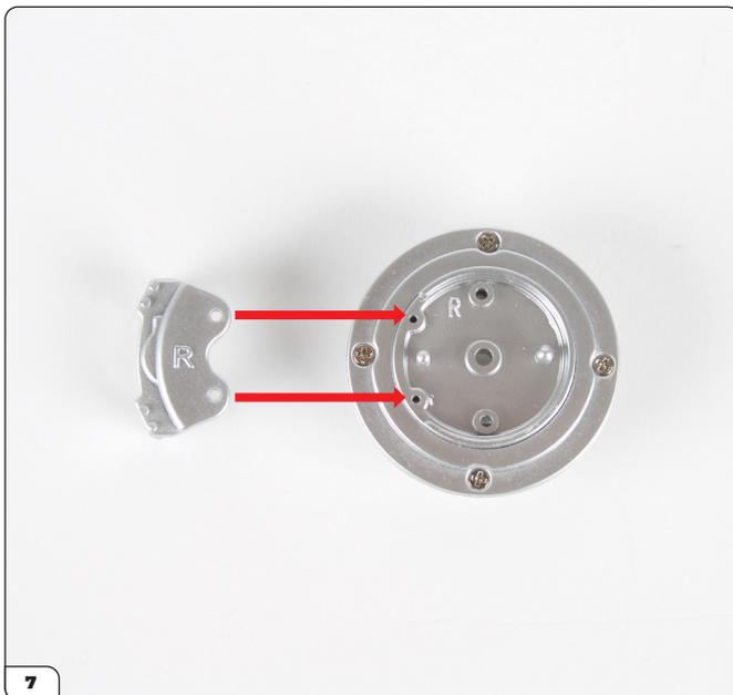
Richte den Bremssattel hinten (33-E) an den beiden Schraubenlöchern auf dem Innenblech aus.
