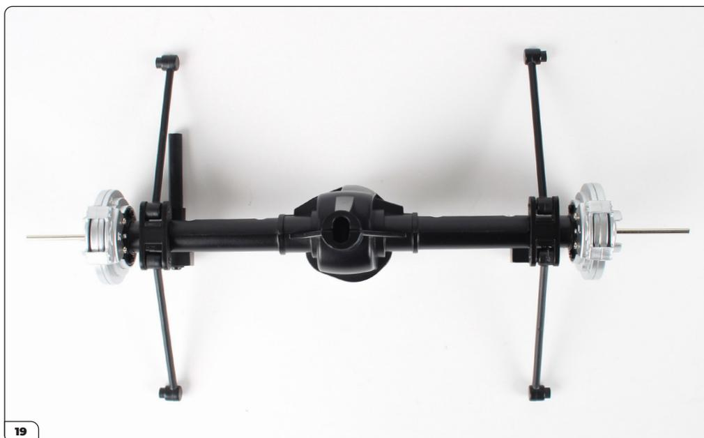
Die Lenker der Hinterachse sollten nach dem Einbau wie oben abgebildet aussehen.
