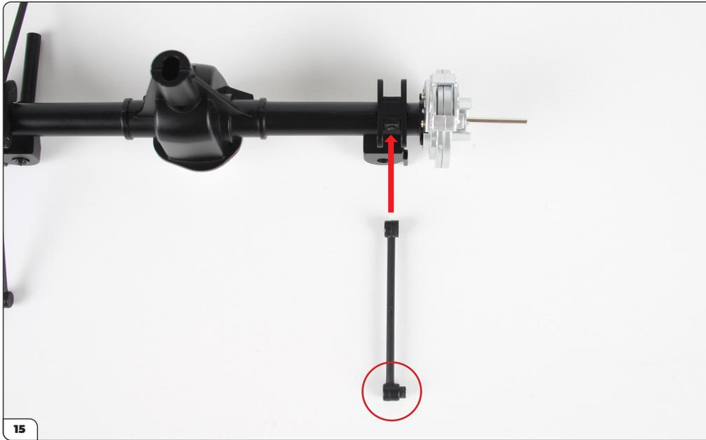
Richte den Unterlenker (34-I) wie abgebildet an der Baugruppe aus. Achte darauf, dass der Schraubbolzen in die richtige Richtung ausgerichtet ist (eingekreist).
