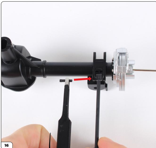
Positioniere den Lenker in der Halterung und führe das glatte Ende des Stifts wie abgebildet durch.
