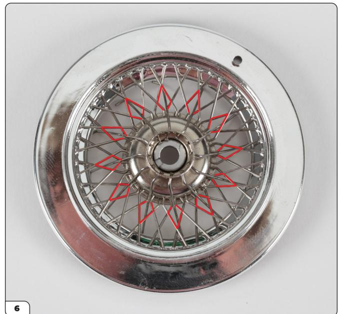
Ist die erste Speiche korrekt eingesetzt, fädle eine weitere Speiche Typ A in das nächsttiefere Loch und durch die übernächste Raute, wie auf der Abbildung gezeigt. In dieser Phase können die Spitzen auf der gegenüberliegenden Seite lose gelassen werden.
