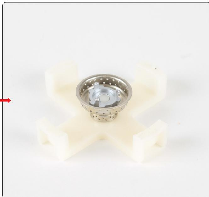
Richte das geformte Loch in der Radmitte (36-B) mit der Vorrichtung (aus Phase 002) aus und setze sie dann ein.
