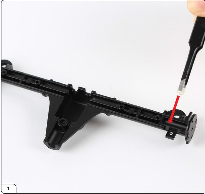
Nimm Hinterachse-Unterseite (32-A) und setze eine der Stiftkappen (32-D) in die Aussparung.
