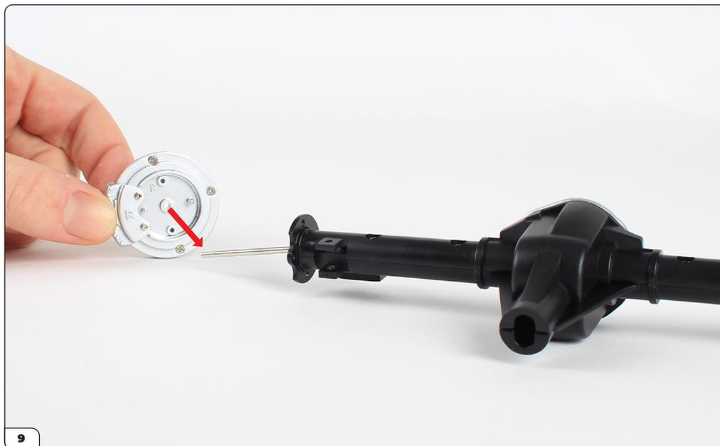
Richte die Bremsscheibe wie abgebildet an der Hinterachsen-Baugruppe (Phase 32) aus.
