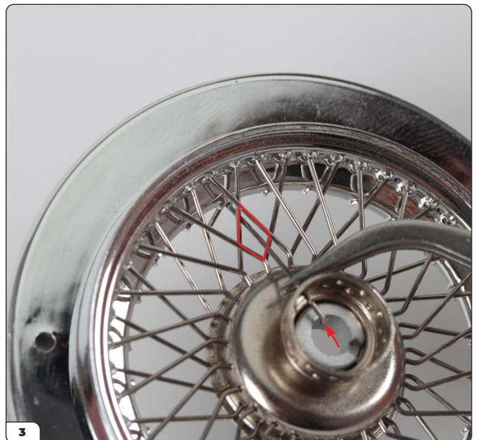
Drehe die Baugruppe um und stecke die Spitze einer Speiche vom Typ A (37-C) durch eines der Löcher der unteren Reihe.
