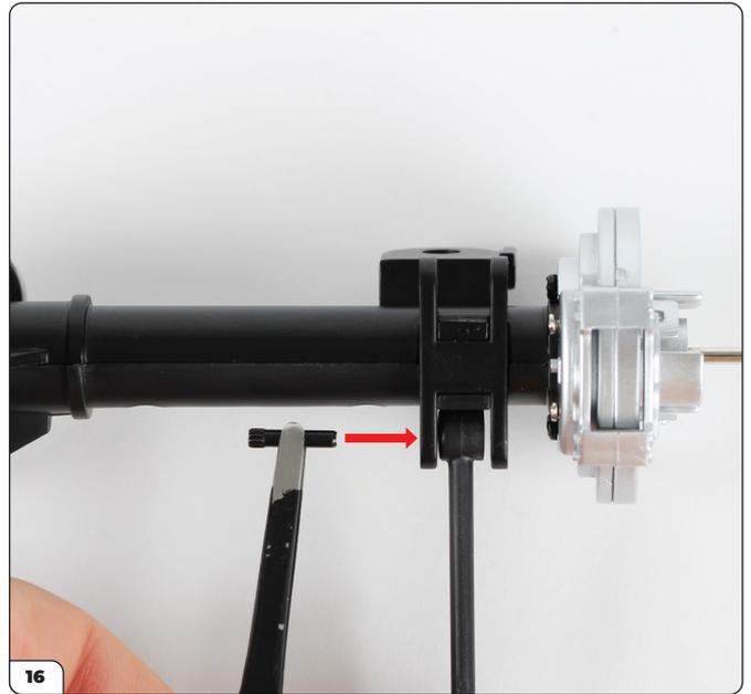
Positioniere den Lenker in der Halterung und führe das glatte Ende des Stifts wie abgebildet durch.
