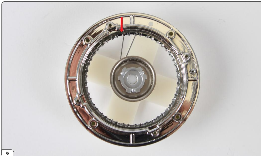
Fädle eine weitere Speiche durch das nächste Loch in der unteren Reihe und hake die Spitze um den nächsten breiten Zahn (Pfeil). Beim Einsetzen der restlichen Speichen kannst Du die Spannung durch Drehen der Radmitte mit dem Daumen vorsichtig einstellen.
