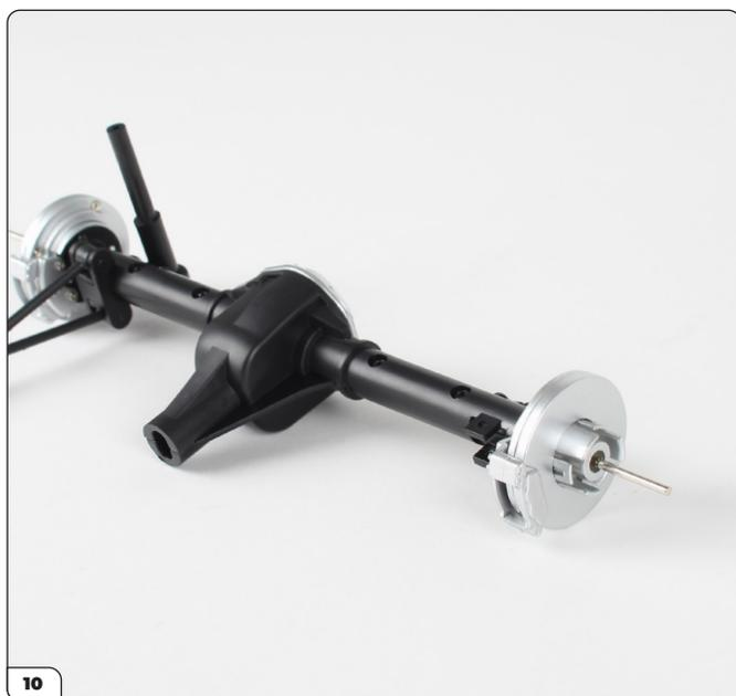
Stecke die Scheibe über den Stift und schiebe sie auf die Achse.
