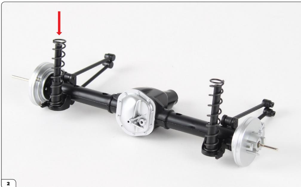
Setze die andere Feder auf die gleiche Weise auf den Stoßdämpfer hinten links.
