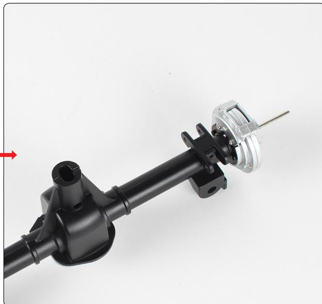
Setze die Lenker-Halterung (34-F) wie abgebildet zwischen den beiden Nasen ein.
