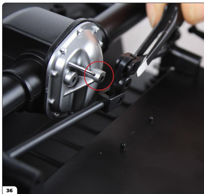
Positioniere das Verbindungsstück mit dem Formstück auf dem Differentialgehäusedeckel.
