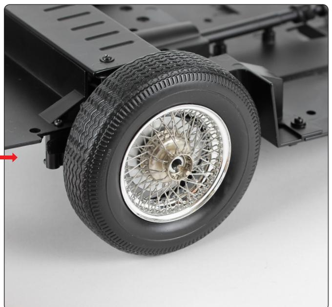
Befestige das Rad an der Radnabe hinten rechts und achte darauf, dass die Stifte mit den Aufnahmen fluchten (in den Schritten 4 und 5 gekennzeichnet). Drücke das Rad fest, bis die Stifte einschnappen.
