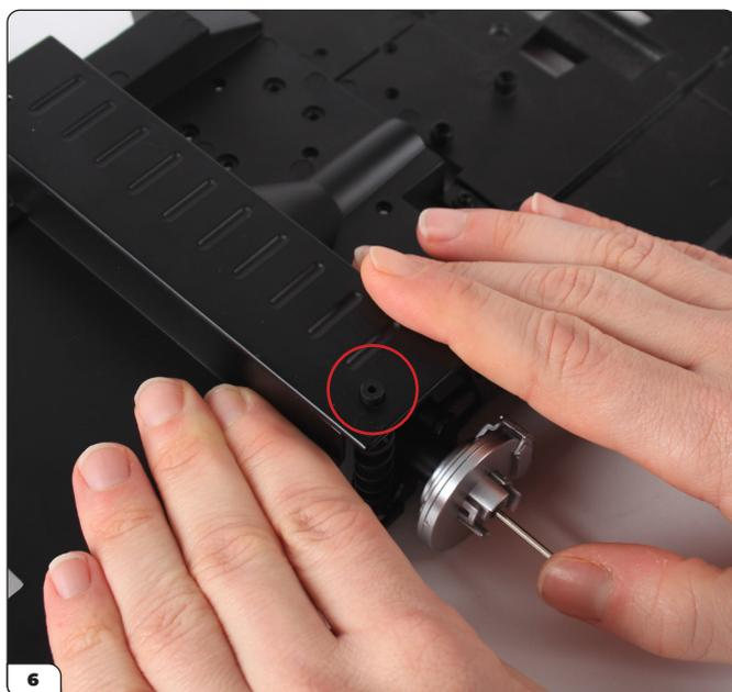
Drücke das Fahrgestell nach unten, so dass der Schraubbolzen des Stoßdämpfers durch das Loch ragt.
