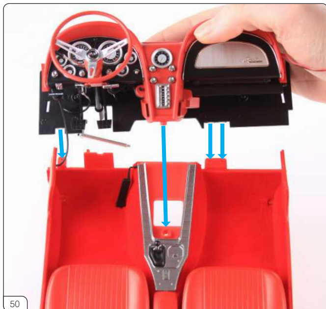
画像のように、ダッシュボードをコックピットフロアに合わせます。
