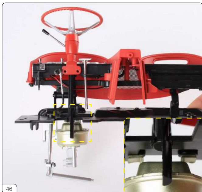
ステアリングシャフトをファイアウォールのくぼみにはめ込みます。右下の 拡大写真を参考にしてください。
