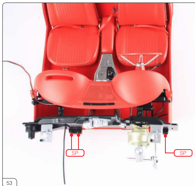
アッセンブリーを直立させ、ファイアウォールをSPネジ3本でコックピットに固定します。
