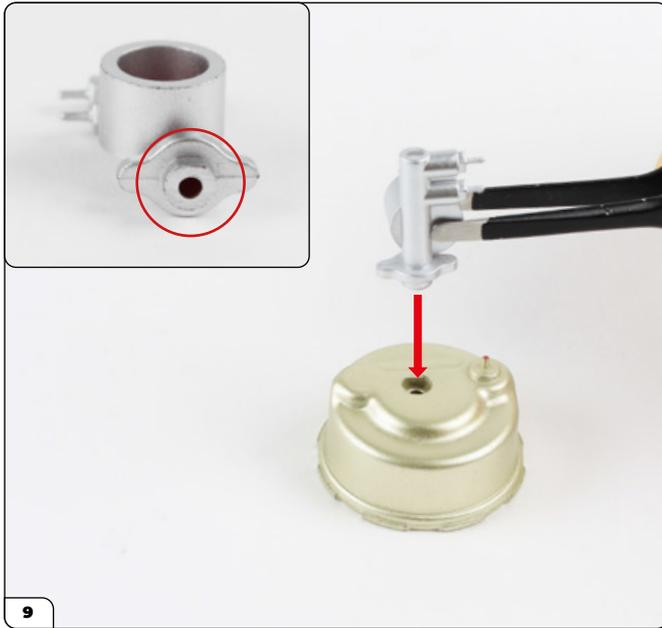
Monta la pompa della frizione sulla parte 1 del servofreno tramite il foro per la vite sagomato, indicato dal cerchio nel particolare.
