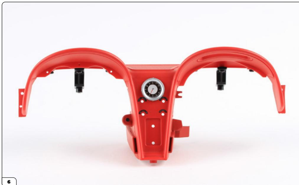
Una volta perfezionato l'allineamento dell'orologio, inseriscilo nel foro premendo con decisione.
