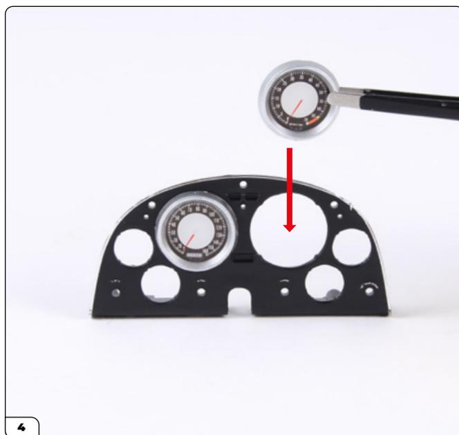
Allinealo sul quadro strumenti, come mostrato nella foto, e montalo, premendo, nel relativo foro.
