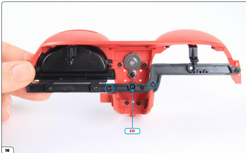
Avvita una vite FP nel foro al centro del telaio di supporto della plancia e poi fissalo stabilmente colando due gocce di colla sui perni indicati dai cerchi.
