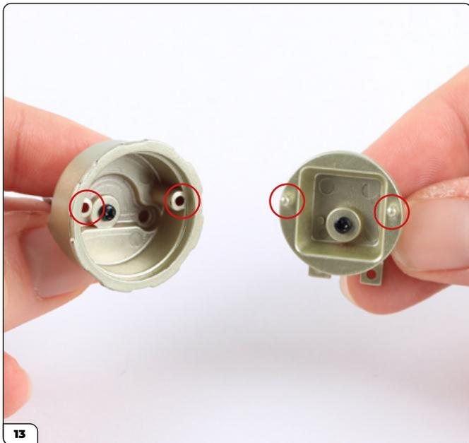
Monta le due parti del servofreno pressando i perni della parte 2 nei fori della parte 1.
