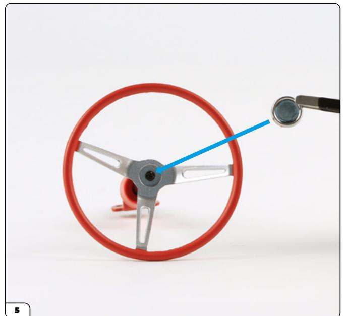
Monta sul volante, pressandolo, il pulsante del volante, che così copre la vite.
