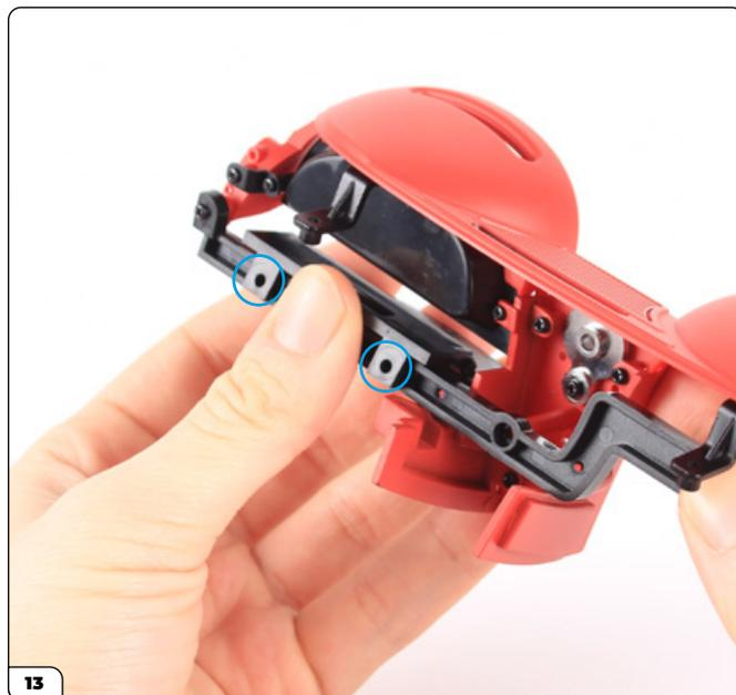
Allinea i fori per le viti presenti sul supporto del coperchio e sul telaio di supporto della plancia.
