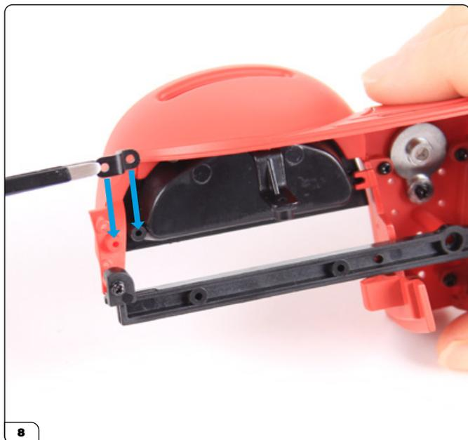
Mantenendolo poi in posizione, ruota la plancia e posiziona, con l'aiuto di una pinzetta, la squadretta in corrispondenza dei fori indicati dalle frecce.
