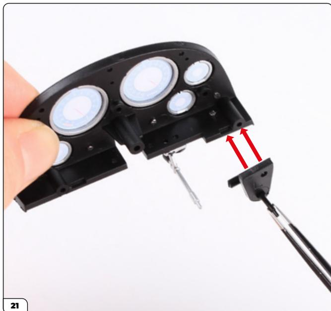
Monta quel supporto sul retro del quadro strumenti tramite la linguetta e allinea i fori per la vite presenti sui due pezzi.
