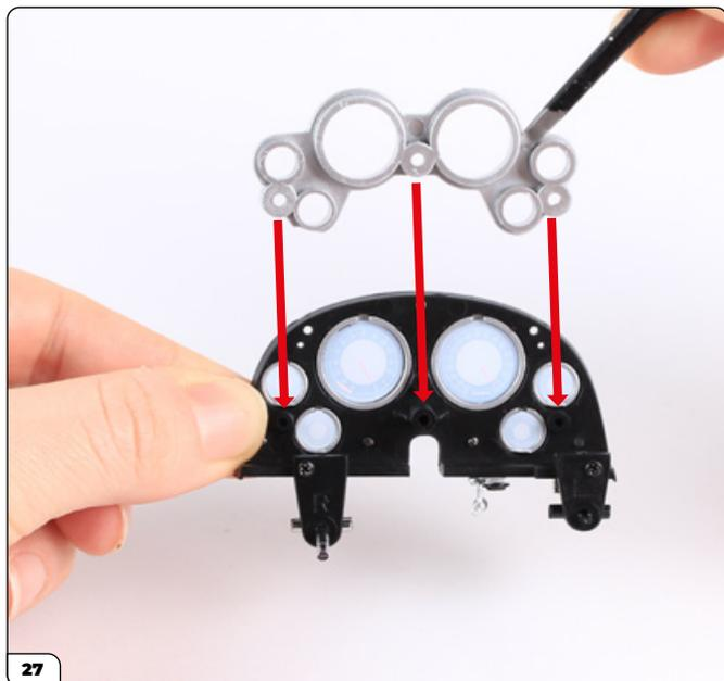
Allinea il pannello posteriore col quadro strumenti, come mostrato nella foto, e poi montalo sulle tre bussole filettate.
