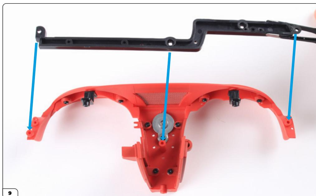
Allinea il telaio di supporto della plancia con l'assieme appena montato.
