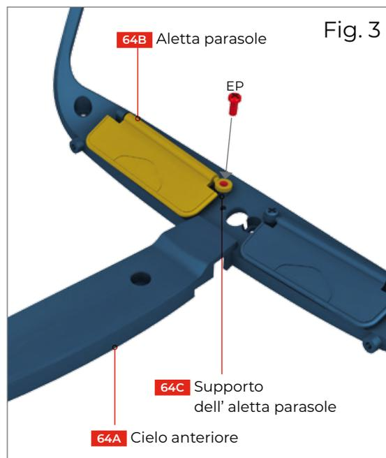
«Sinistro» e «destra» nelle istruzioni indicano i lati effettivi del modello, che però sono invertiti nelle figure nelle quali il cielo è mostrato necessariamente capovolto per lavorarci dall'interno.
