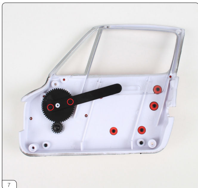
7 ギヤアームの穴 (赤丸印) をウィンドウギヤ (大) の突起にはめ込みます。
