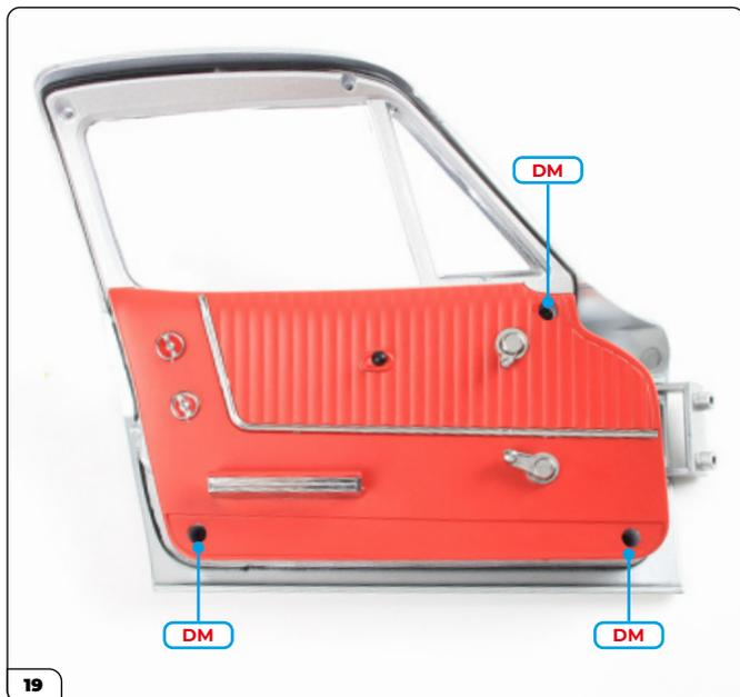
Utilice 3 tornillos DM para fijar las piezas entre sí.
