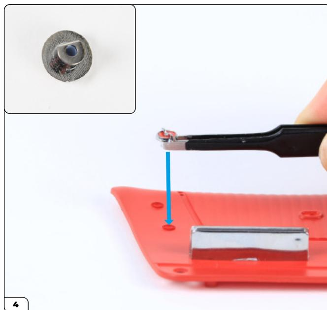
Tome los pomos reflectores de la cerradura de la puerta que disponen de orificios para tornillos modelados (recuadro). Introduzca uno de ellos en el orificio modelado, tal y como se muestra.
