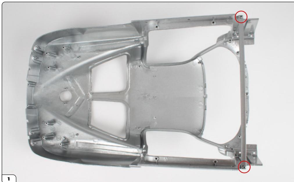
Empiece tomando la carrocería principal y retirando los tornillos (rodeados con un círculo) que sostienen la barra de soporte.
