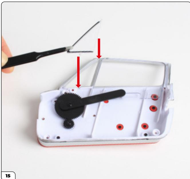
Coloque el conjunto de la puerta a un lado y tome el conjunto del panel interior. Alinee la ventanilla triangular izquierda tal y como se muestra.
