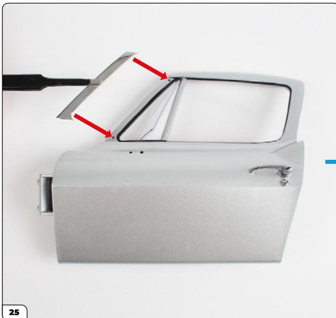
Tome el embellecedor cromado de la puerta izquierda y alinéelo con la sección situada junto a la ventanilla triangular, tal y como se muestra. Presione firmemente el embellecedor en los dos orificios.
