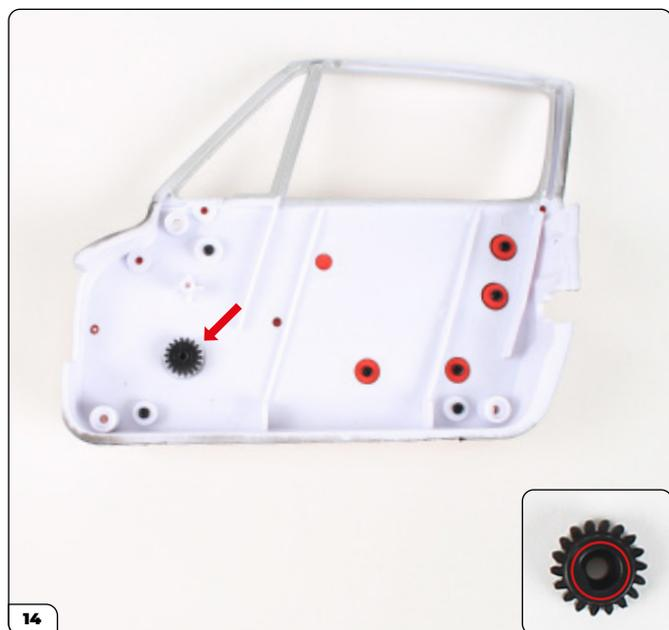
Desde el lado opuesto, encaje el pequeño engranaje de la ventanilla en la manivela, utilizando el orificio modelado (recuadro).
