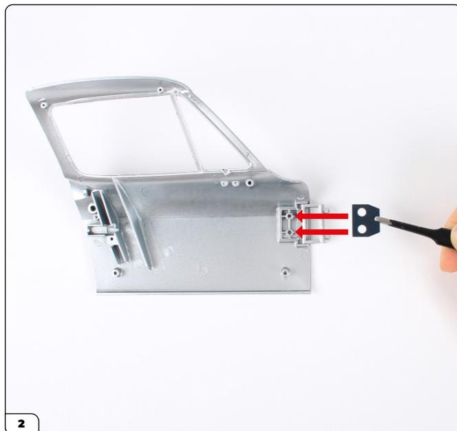
Coloque el soporte de la bisagra en su posición y, a continuación, alinee la placa de la bisagra de la puerta como se muestra.
