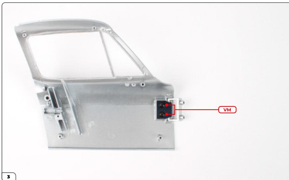
Asegure la placa de la bisagra con 2 tornillos VM.
