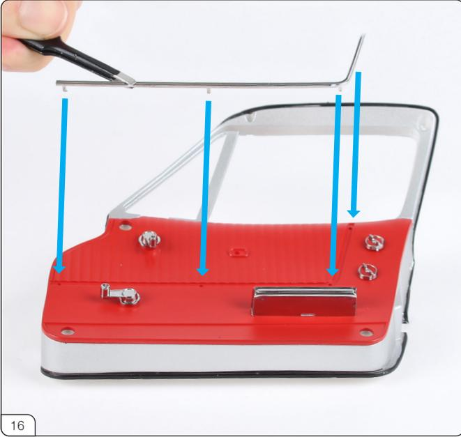
インテリアパネルトリムを取り付けます。青丸印の穴とインテリアパネルトリムの突起を合わせます。
