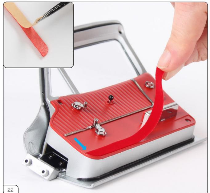
右ドアカーペットトリムの裏紙を剥がし、右ドアインテリアパネルの凹みに配置します。コーナーをアジャストさせてから貼り込みます (青矢印)。
