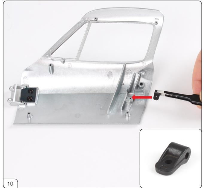
ステージ⑧で組み立てた右ドアにロックピンブッシュを合わせます。ロックピンブッシュは、右下小写真の向きにセットしてください。
