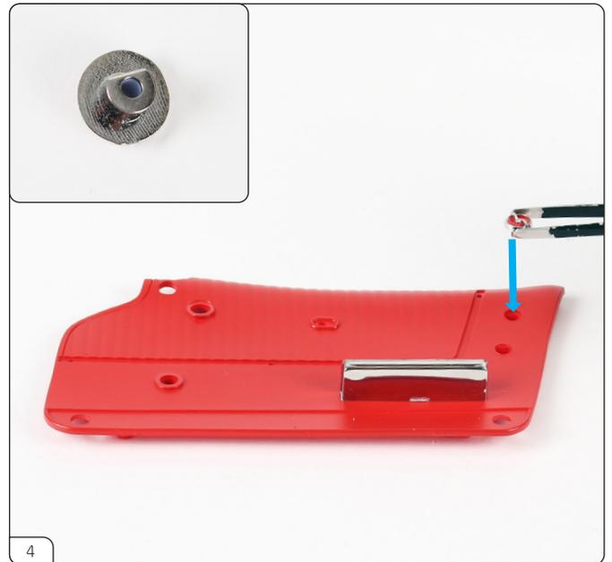
画像のように、ドアロックリフレクターノブを取り付けます(青矢印)。D字の切り欠き(左上小写真)に合わせて押し込みます。
