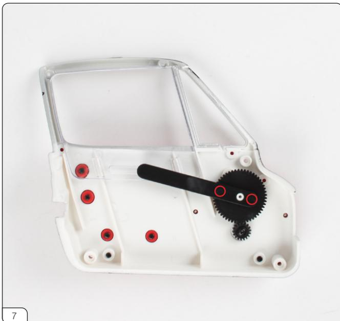
ギヤアームの穴 (赤丸印) をウィンドウギヤ (大) の突起にはめ込みます。
