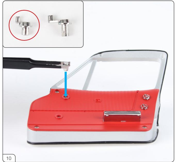
画像の位置に、ベントウインドウクランクをはめ込みます。ベントウインドウクランク(左/赤丸印)とウインドウクランク(右)は形状が似ています。注意してください(左上小写真)。
