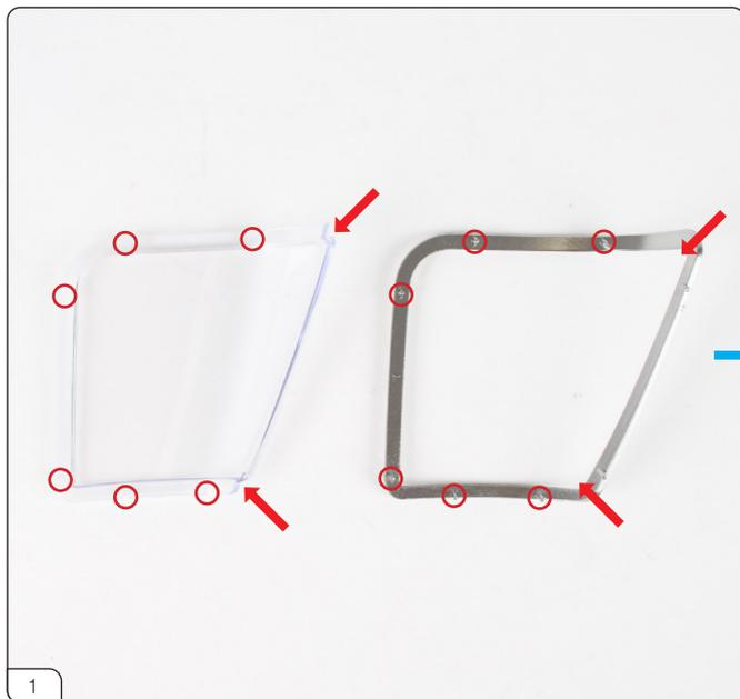
左リアウインドウフレームに左リアガラスをはめ込みます。赤矢印の角に合わせて左リアガラスをはめ、角を決めたら左リアウインドウフレームの突起を押し込みます (赤丸印)。
