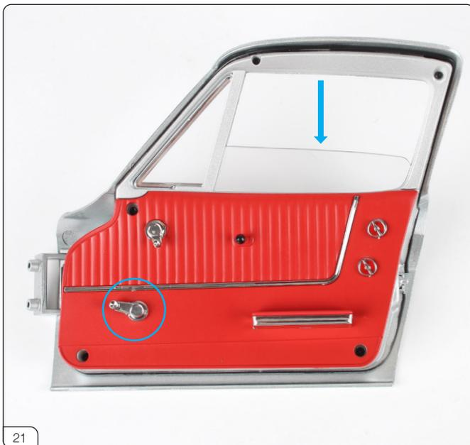
ウインドウ crank を回して開閉をテストします (青丸印)。
