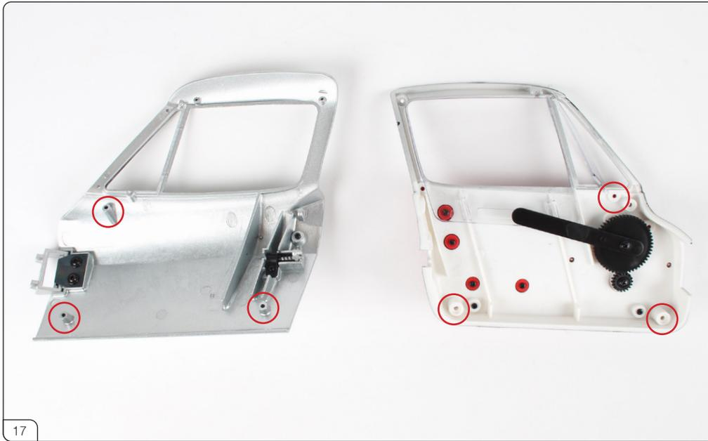
右ドアと右ドアインナーパネルを合体します。固定されるネジ穴は赤丸印の部分です。
