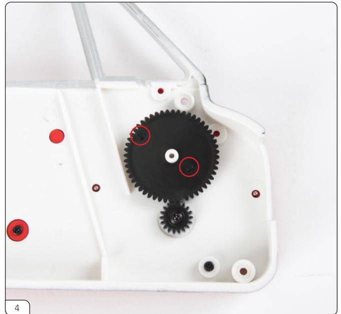
ギヤのかみ合いを確認し、ウインドウギヤ (大) の突起を画像の向きにします (赤丸印)。
