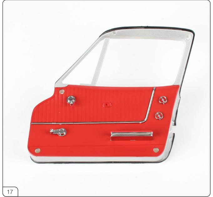
インテリアパネルトリムをパネルに押し込みます。
