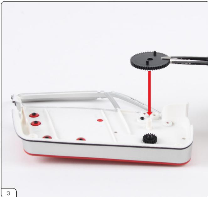
ステージ⑧で組み立てたアッセンブリーに、ウインドウギヤ (大) をはめ込みます (赤矢印)。ギヤの突起 (赤丸印) が上を向くようにセットします。
