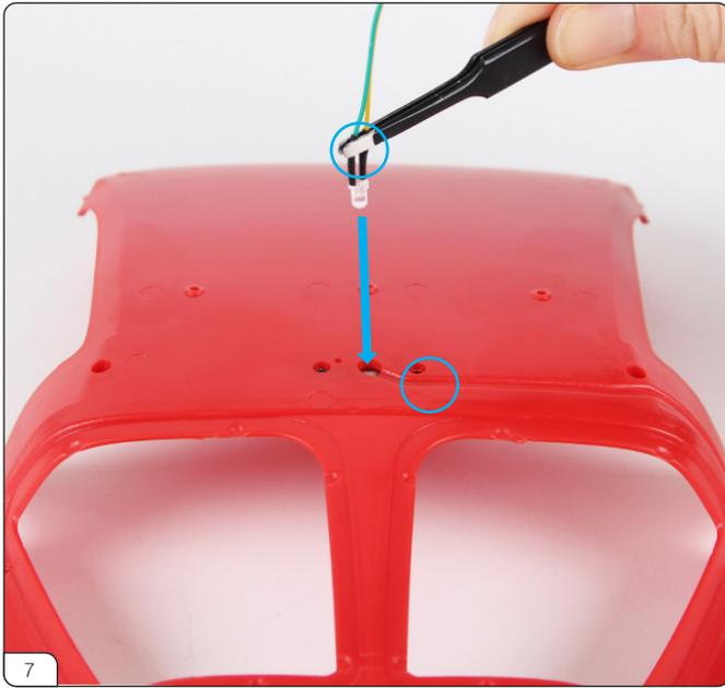
LEDをルーフライナーのトップの穴に差し込みます (青矢印)。ケーブルの溝を確認します (青丸印)。
