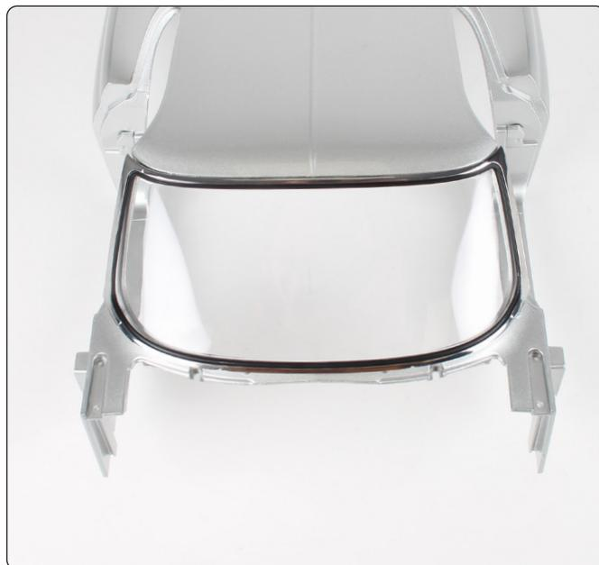
ステージ⑩で開梱したボディに、ウィンドスクリーンフレームを合わせます。ウィンドスクリーンフレームを、本体の4つのタブ(赤矢印)と4つのネジ穴(赤丸印)にはめ込みます。
