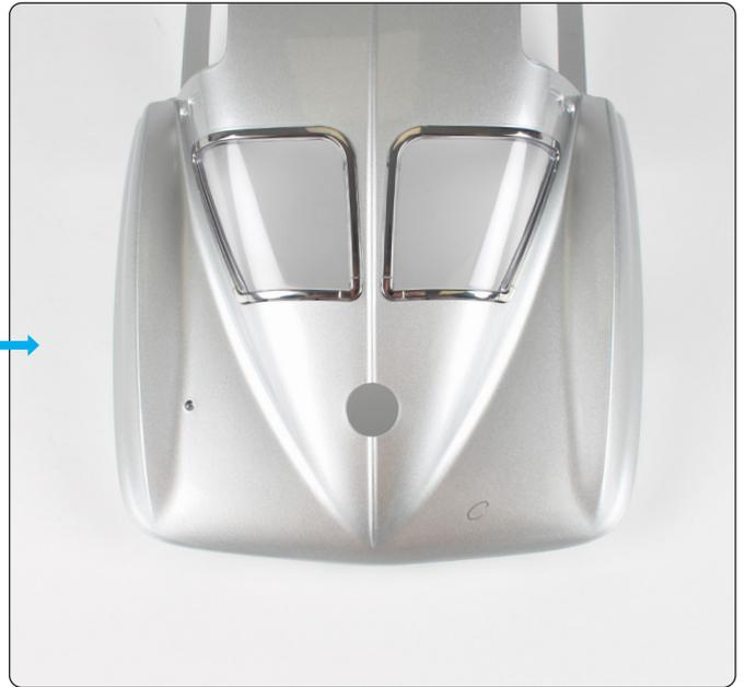
画像のように左右のリアウインドウを合わせます。フレームの突起をボディの穴（赤丸印）に押し込みます。
