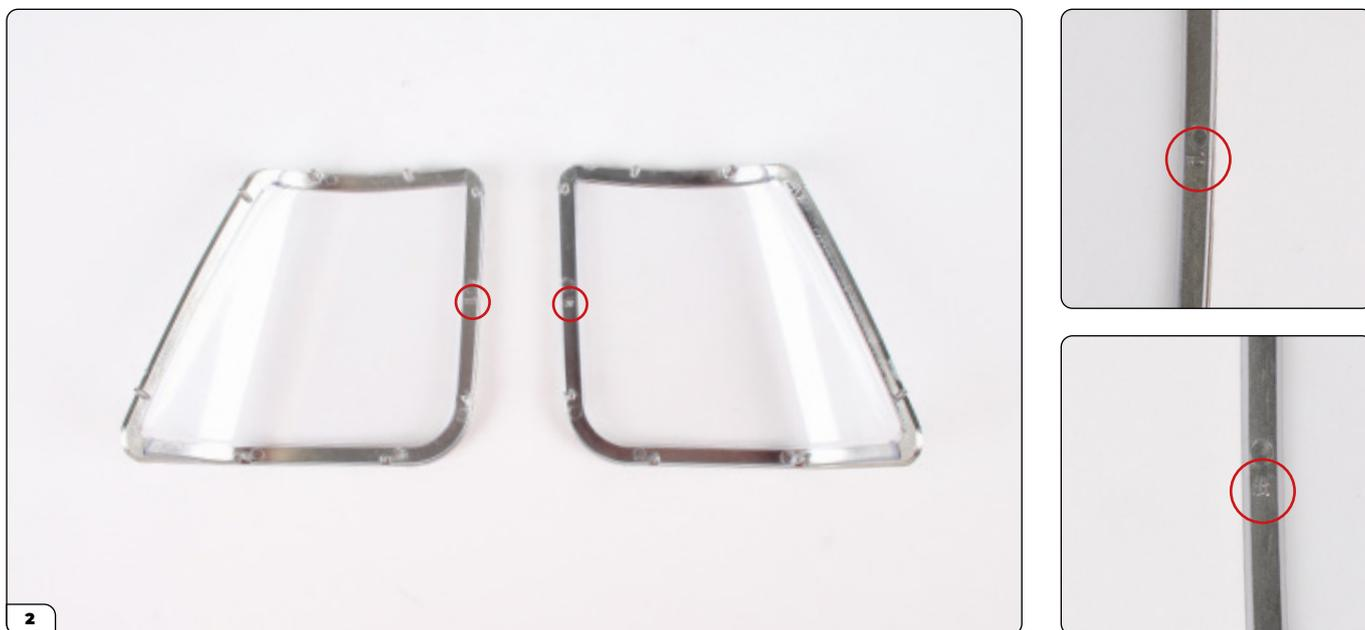
Assembla allo stesso modo il vetro destro con la relativa cornice. Nota che le due cornici sono contrassegnate con una "L" e con una "R", indicate dai cerchi nelle foto, per agevolare il montaggio del lunotto sulla carrozzeria.
