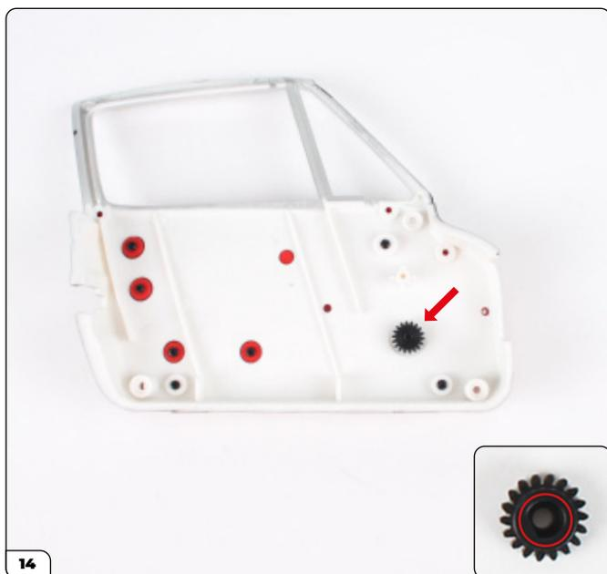
Lavorando sul retro della parte interna della porta, monta l'ingranaggio piccolo dell'alzavetro sul perno della manovella tramite il foro sagomato.
