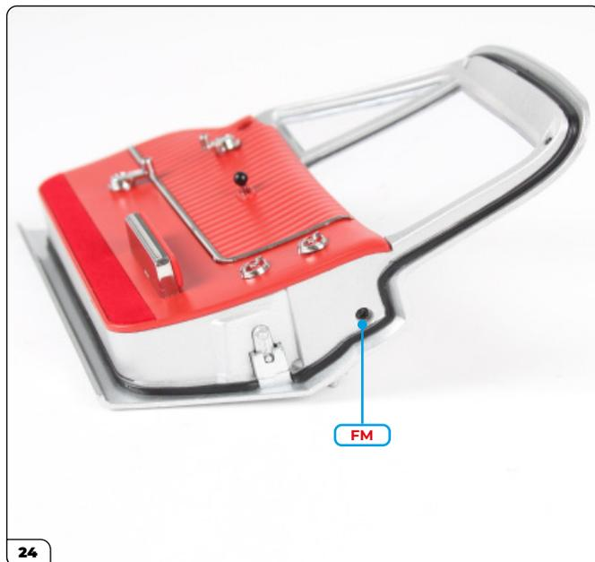
Ora monta una vite FM nel foro che si trova vicino al perno di blocco.
