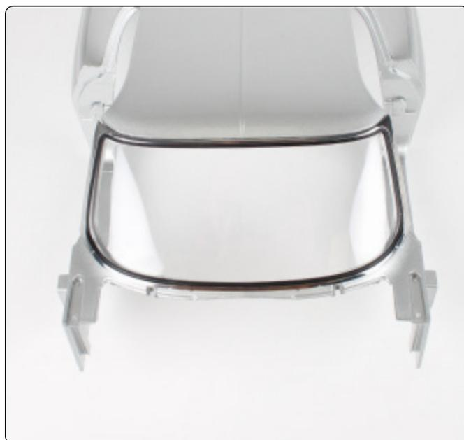
Allinea la cornice del parabrezza con la carrozzeria (fase 85), come mostrato nella foto. Montala quindi tramite le quattro linguette sul suo bordo superiore e le quattro sedi per le viti sul suo bordo inferiore.
