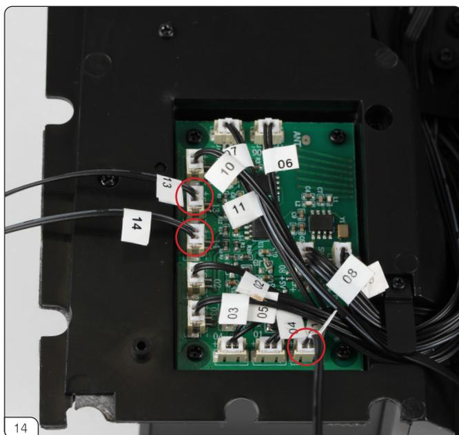
電源ケーブル（12）、リアライトケーブル（13）、リアライトケーブル（14）を、対応するソケットに差し込みます。
