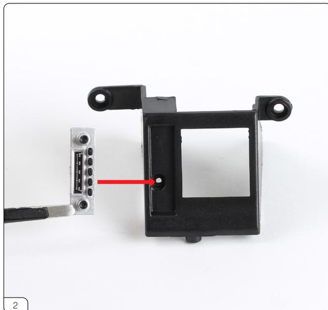
ラジオ (55-D) をGPSハウジング (55-A) にセットします (赤矢印)。
