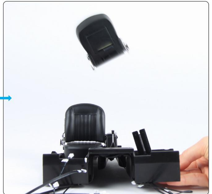
レバーを引くと、キャッチが解除され、シートが斜め上に飛び出します。
