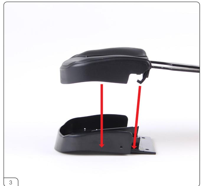
パッセンジャーズシートバックレストカバー(49-A)を、パッセンジャーズシートバックレスト(49-B)に合わせます。
