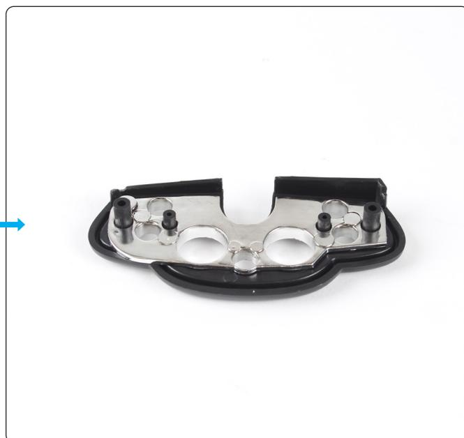
ダイヤルトリム (56-E) をダイヤルハウジング (56-A) に押し込みます。
