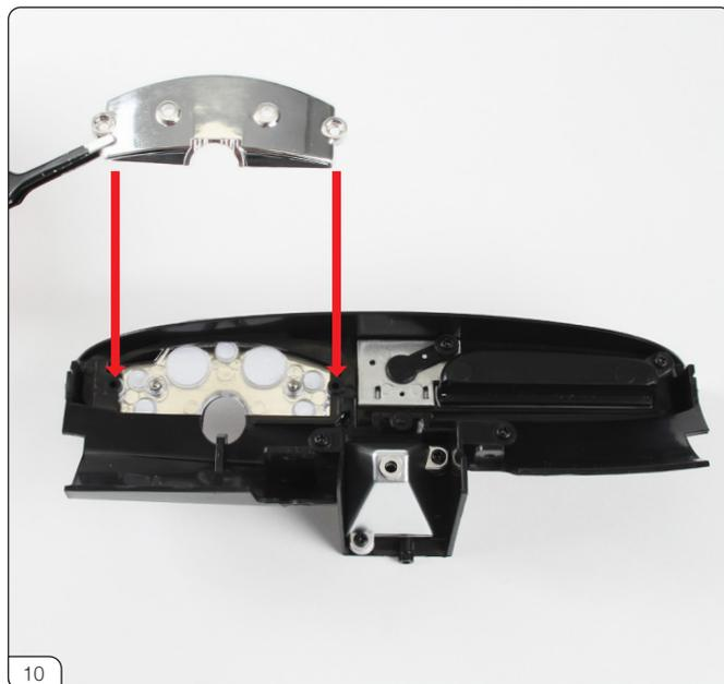
画像のように、ダッシュボードアセンブリーの裏側からダイヤルリフレクター (56-C) のネジ穴を合わせます。
