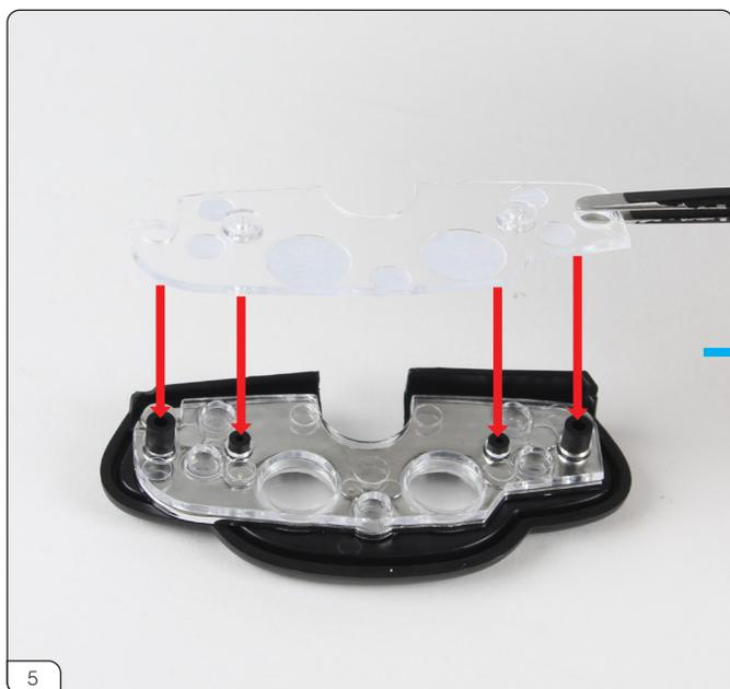
ダイヤルマウント (56-D) をハウジングにセットします。
