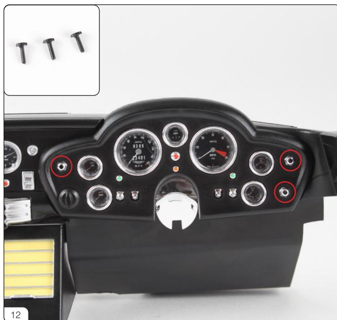
ハウジングの3箇所の穴 (赤丸印) に、スイッチ (56-G) をはめ込みます。
