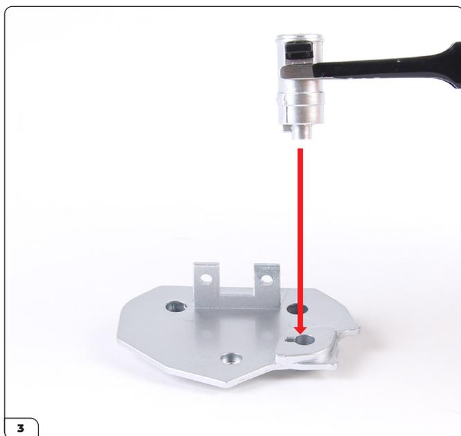
Alinea el motor de arranque con la tapa de la carcasa del embrague (16-A), que tiene un agujero formado.
