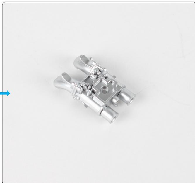
Presiona los tomas de aire de velocidad (11-D) en el cuerpo del carburado (11-A).
