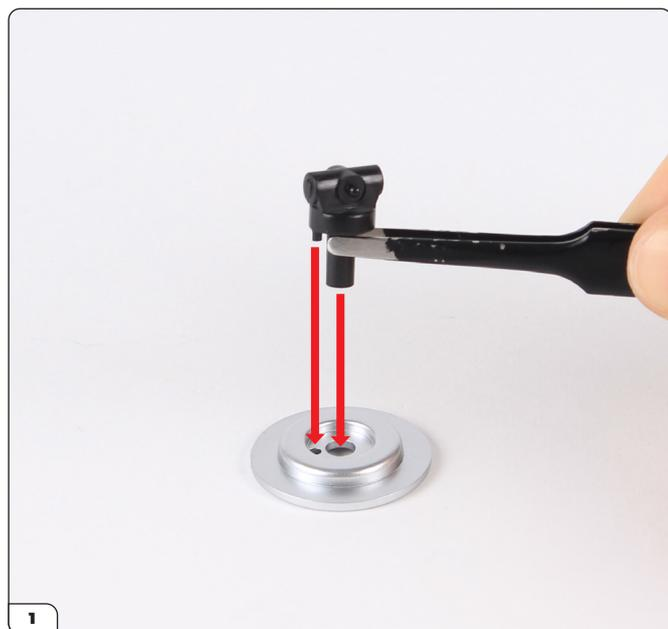
Ajusta el árbol de transmisión (12-D) en el disco de freno (12-C) utilizando el pasador para alinearlos correctamente.
