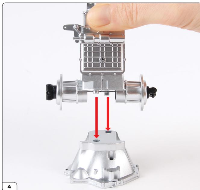
Toma el ensamblaje de la caja de cambios (etapa 014) y alínelo con la carcasa del embrague.
