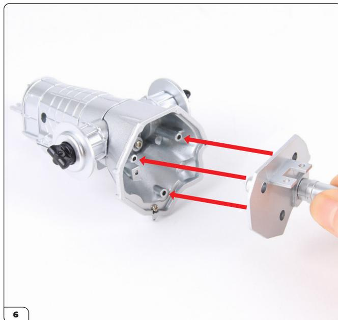
Alinea la tapa de la carcasa del embrague con el ensamble de la caja de cambios (etapa 015).
