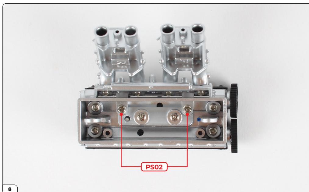
Coloca el colector de admisión y fíjalo usando 2 tornillos PS02.
