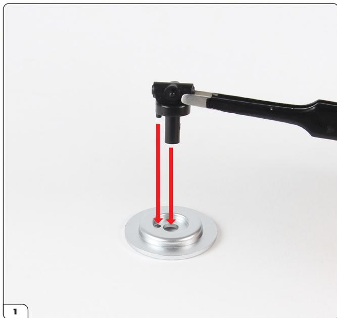
Ajusta el árbol de transmisión (13-D) en el disco de freno (13-C) utilizando el pasador para alinearlos correctamente.
