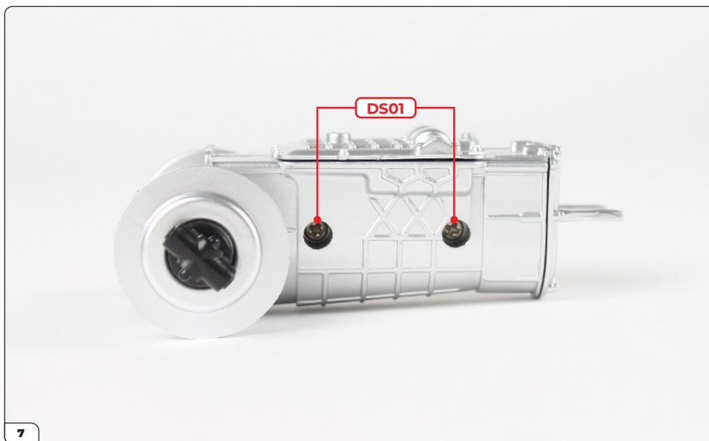
Une las dos partes y asegúralas con 2 tornillos DS01.
