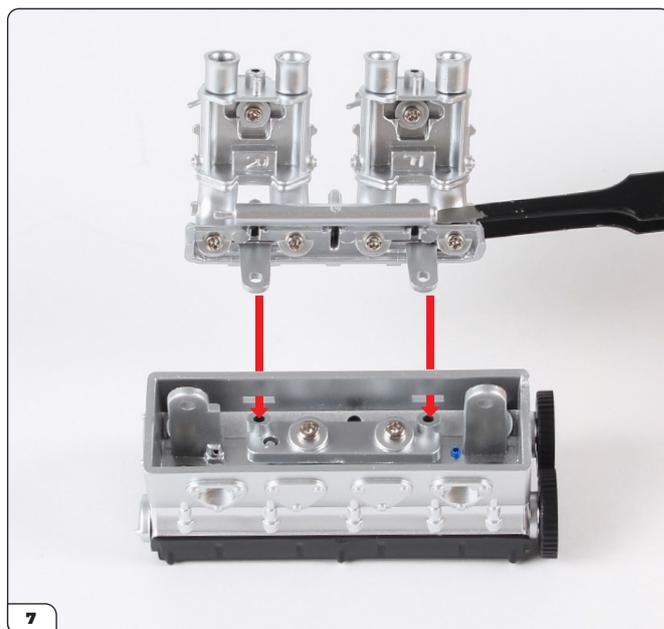
Alinea el colector de admisión con el conjunto como se muestra. Las pestañas encajan a través de las aberturas y sobre el soporte.
