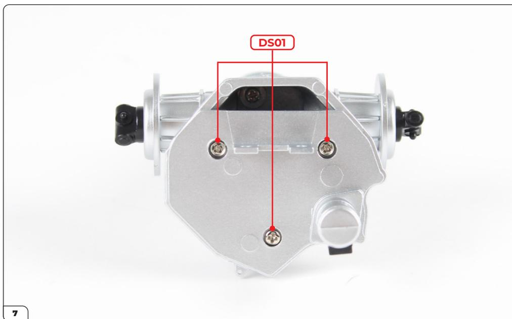
Ajusta la cubierta de la carcasa del embrague y luego asegúrala usando 3x tornillos DS01.
