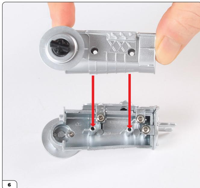
Alinea el ensamblaje de la caja de cambios izquierda (marcado con 'L') como se muestra.
