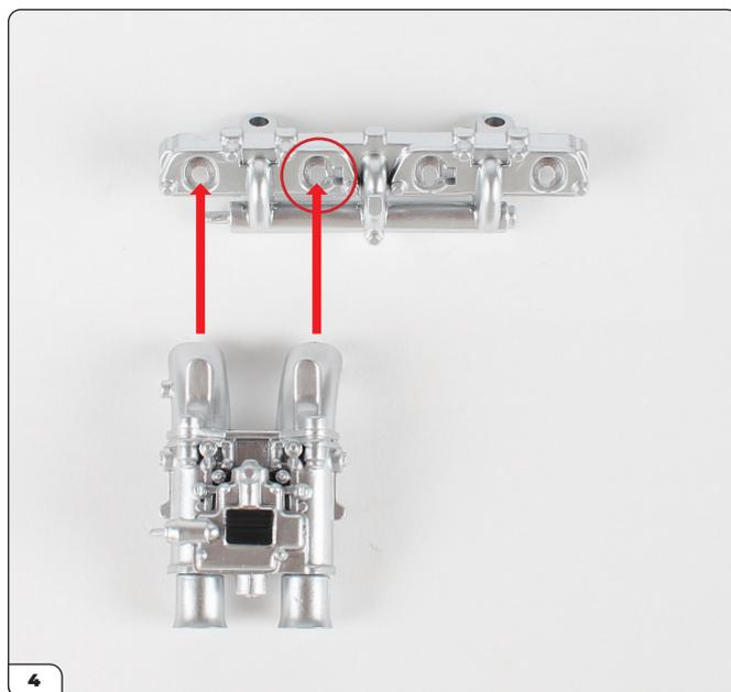
Alinea el carburador con el colector de admisión (10-B) como se muestra. Los accesorios tienen forma para garantizar que las piezas estén posicionadas correctamente (en círculo).
