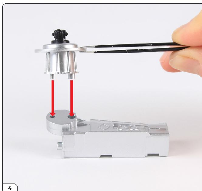
Toma la caja de cambios derecha (12-A) y ajusta los postes de los tornillos en la carcasa del árbol de transmisión en los agujeros correspondientes.
