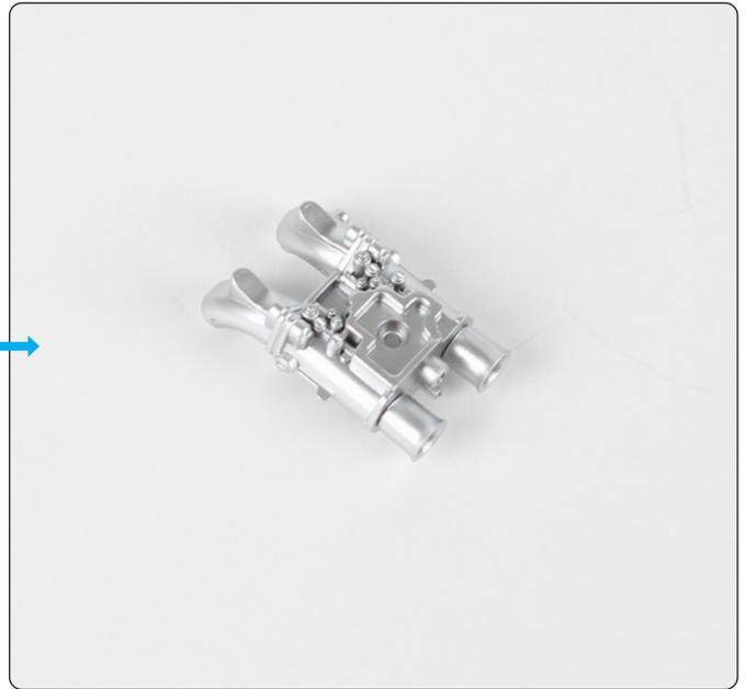
Drücken Sie die Ansaugtrichter (11-D) in das Vergasergehäuse (11-A).
