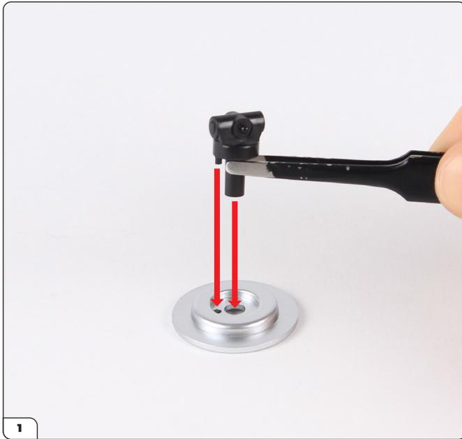
Schieben Sie die Antriebswelle (12-D) in die Bremsscheibe (12-C) ein, indem Sie den Stifts zur korrekten Ausrichtung verwenden.
