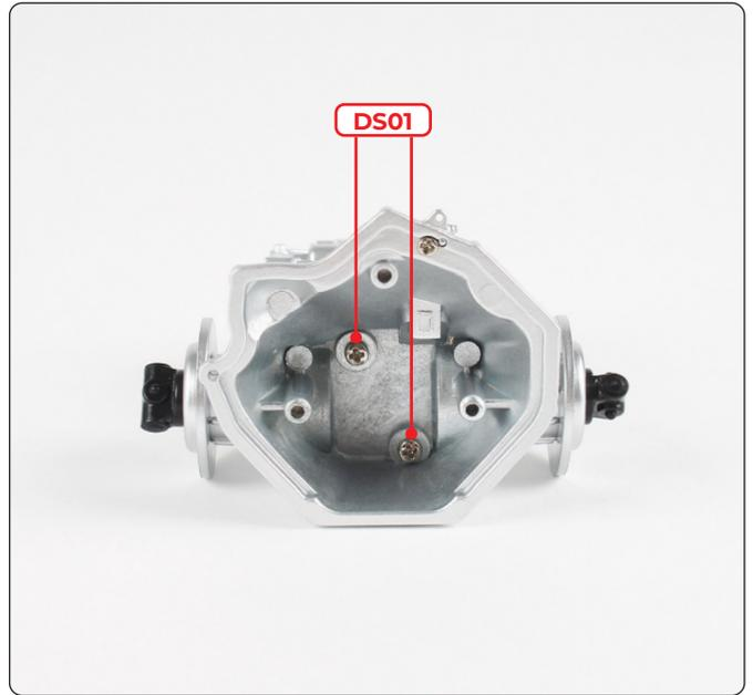
Schieben Sie den Stift in das kleinere Loch. Sie das Getriebe auf das Glockengehäuse und sichern Sie die Teile mit 2 DS01-Schrauben.
