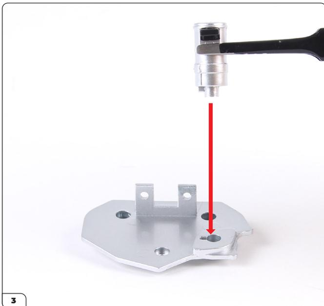
Richten Sie den Anlassermotor mit dem Glockengehäusedeckel (16-A) aus, der ein geformtes Loch hat.
