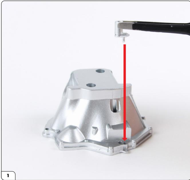
Nehmen Sie das Glockengehäuse (15-A) und richten Sie den Kupplungszyylinder (15-B) wie gezeigt aus.
