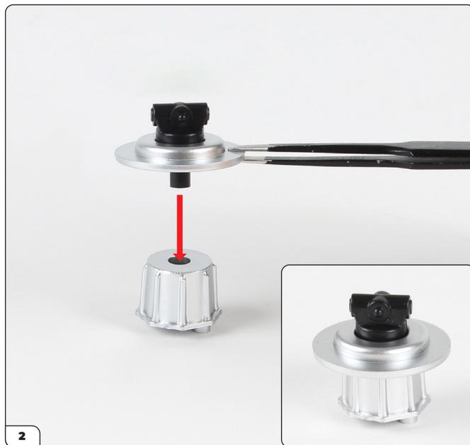
Monta il perno a vite dell'albero di trasmissione nella carcassa dell'albero di trasmissione (12-B).
