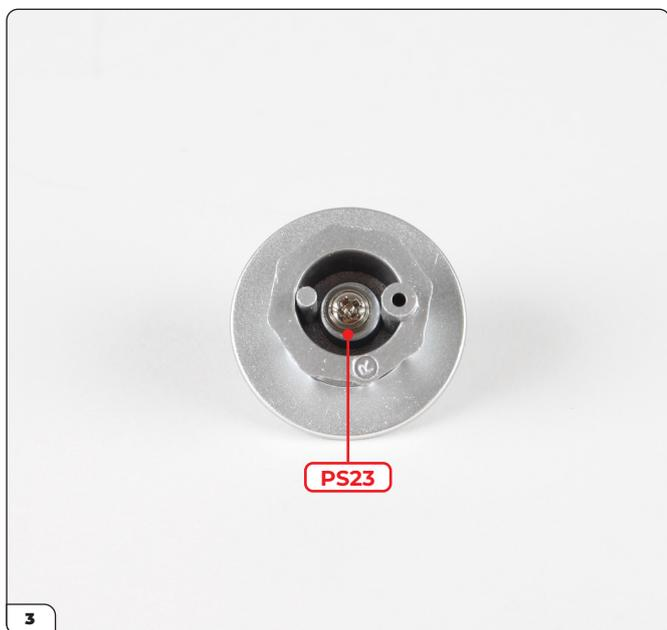
Assicura dall'interno della carcassa dell'albero di trasmissione utilizzando una vite PS23.
