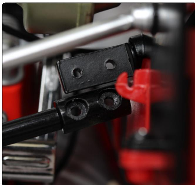
Localice la conexión de la columna de dirección (marcada con un círculo) en el lado del conductor. Asegúrese de que las dos partes queden enfrentadas, tal y como se muestra (imagen derecha).
