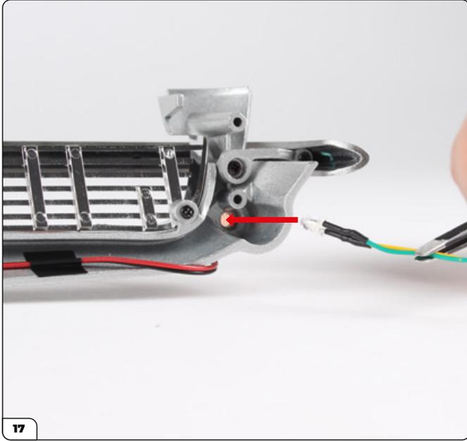
Coloque el LED del cable "A6" en el intermitente derecho del parachoques delantero.
