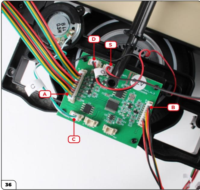
Conecte los cables a la placa de circuitos de repuesto haciendo coincidir los cables etiquetados con las tomas.
