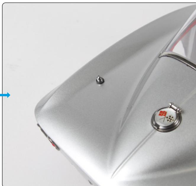
Introduzca la base de la antena en el orificio situado en la parte trasera izquierda de la carrocería principal. La forma del accesorio garantiza una orientación correcta.
