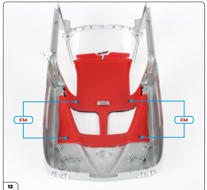
Empiece a asegurar el revestimiento del techo con 4 tornillos FM en la parte trasera.
