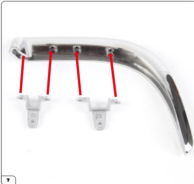
Alinee los soportes con el parachoques derecho, tal y como se muestra.
