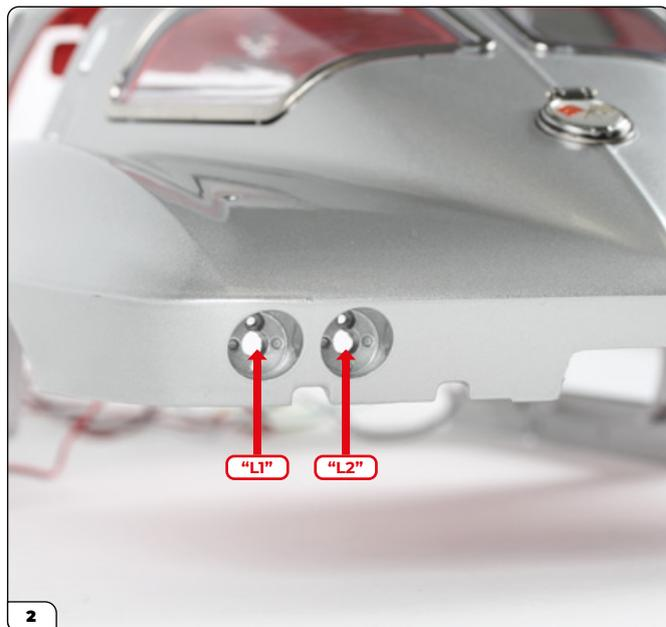
La carrocería principal dispone de dos huecos para las luces traseras izquierdas. "L1" encaja en el hueco exterior, y "L2" en el interior.
