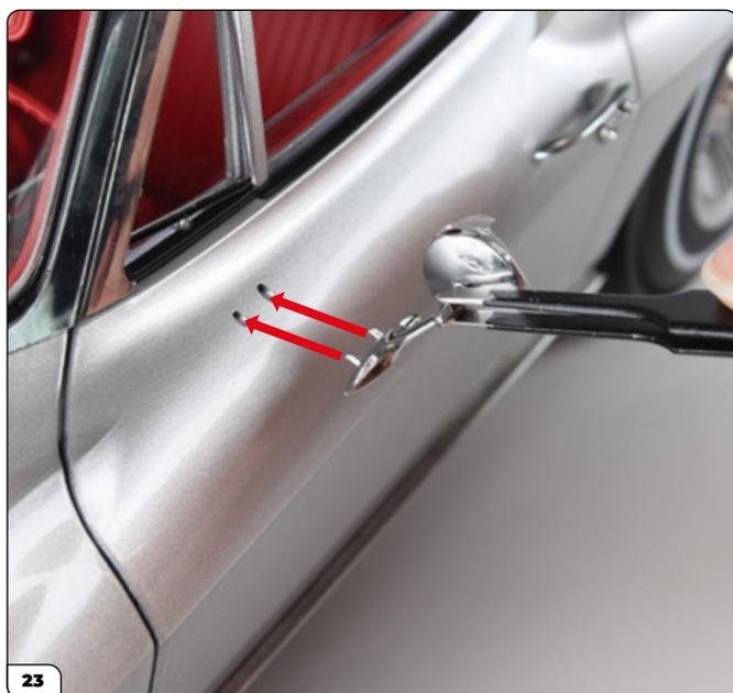
Alinee el soporte del retrovisor lateral con los dos orificios situados en la puerta izquierda.
