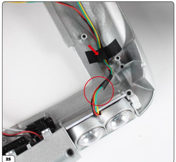
Utilice un trozo de cinta adhesiva mediana para fijar los cables del faro derecho, dejando suficiente holgura en los cables.
