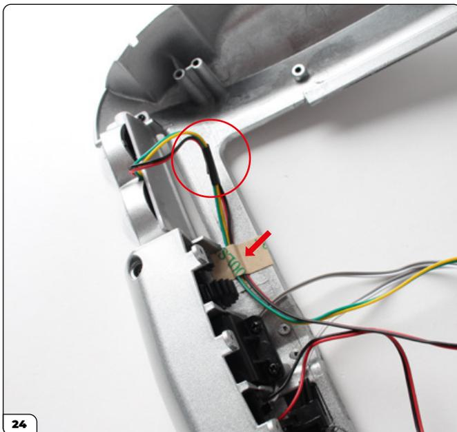
Utilice un trozo de cinta adhesiva de doble cara pequeña para fijar los cables del faro izquierdo a la carrocería, asegurándose de dejar cierta holgura (marcada con un círculo) para que los cables puedan moverse al cerrar el faro. Asegúrese de que la cinta adhesiva no sobrepase el borde de la abertura del capó.
