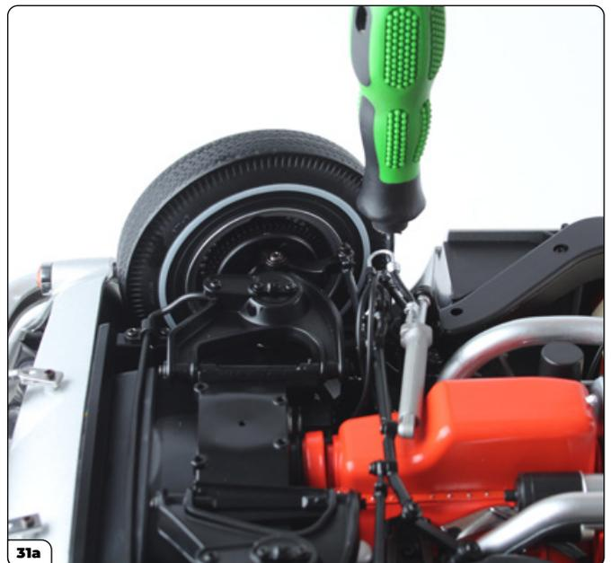
En el interior de cada uno de los pasos de rueda delanteros hay dos orificios para tornillos (marcados con un círculo). Cuando introduzca tornillos en estos orificios en el siguiente paso, gire las ruedas hacia la izquierda o hacia la derecha como se muestra en la imagen 31a para facilitar el acceso con el destornillador.
