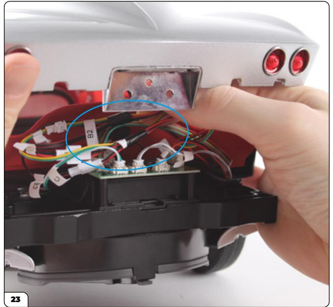
23 Introduzca el manajo de cables trasero en la zona situada entre la placa de circuitos y el depósito de combustible.
