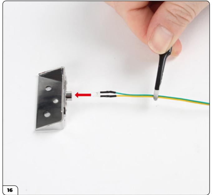
Coloque el LED en el soporte de la matrícula trasera.
