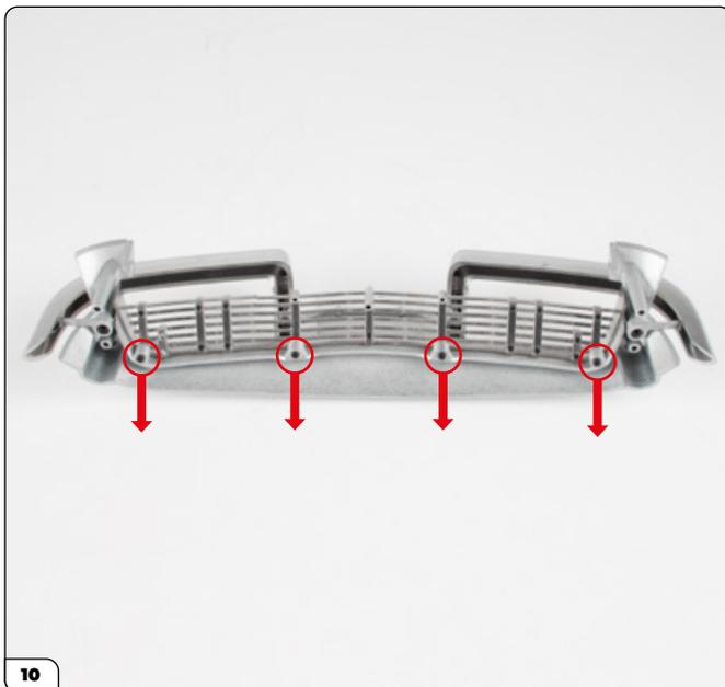
Recupere el parachoques de la carrocería delantera (etapa 02) y retire los tornillos que sujetan la rejilla (marcados con un círculo).
