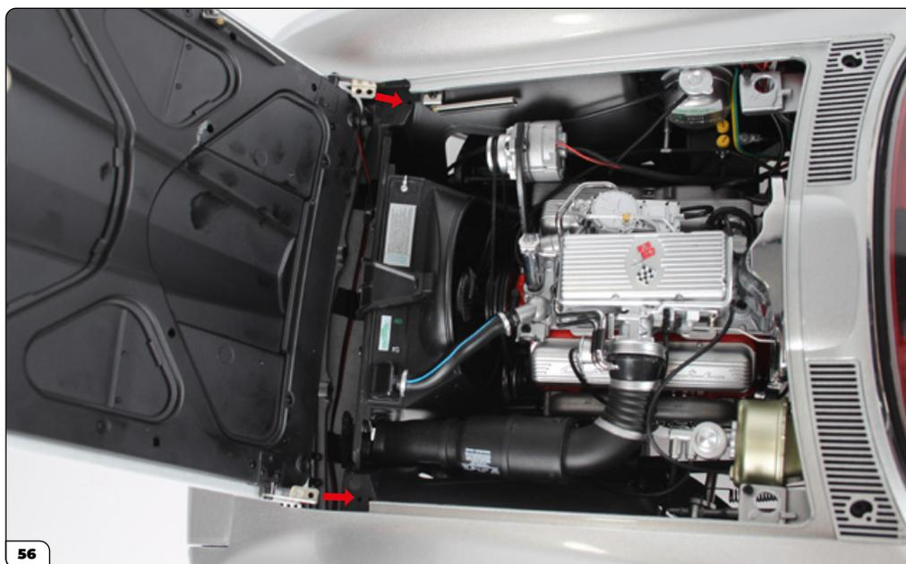
Coloque el capó colocando las bisagras sobre los orificios para tornillos correspondientes.
