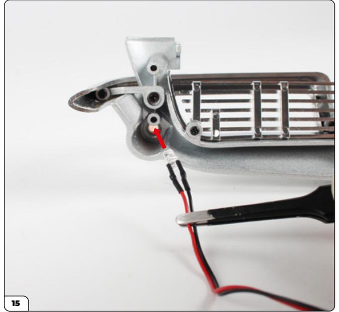
Coloque el LED del cable "A5" en el intermitente izquierdo del parachoques delantero.
