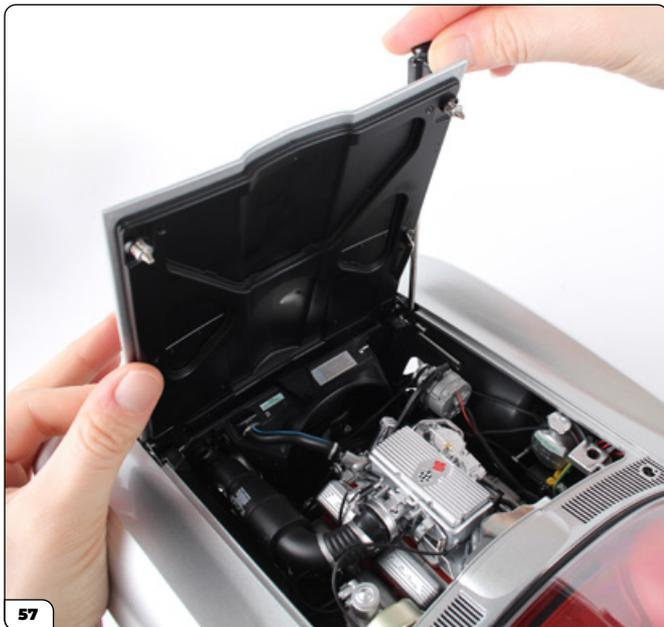
Al fijar las bisagras, deberá utilizar un destornillador estrecho como el que se muestra para acceder a los orificios para tornillos. Procure no dañar la pintura del capó.
