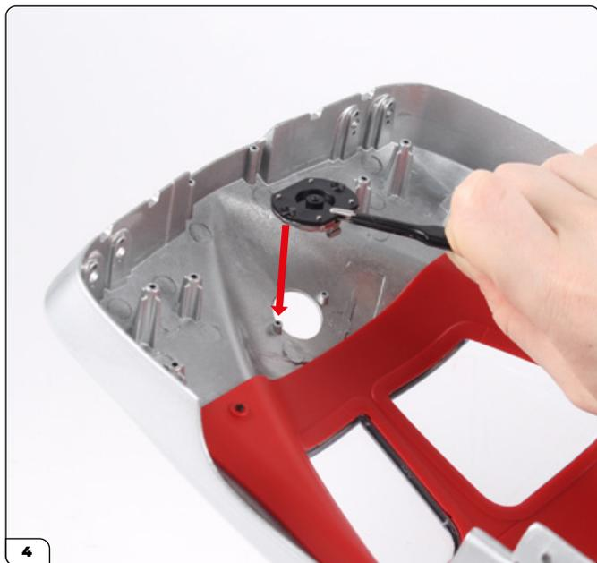
Alinee la cubierta de la boca de llenado de combustible con el conjunto de la carrocería principal (etapa 93), tal y como se muestra.
