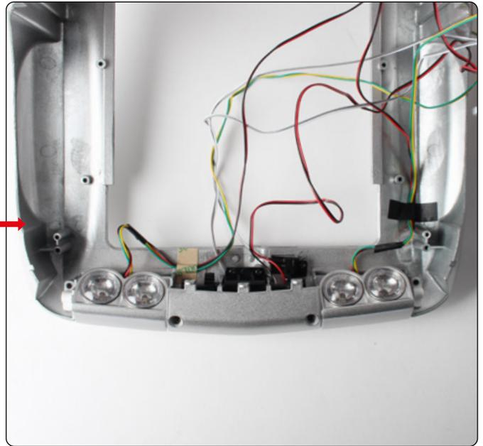
Pulse el botón de subida/bajada de los faros y observe los cables a medida que se mueven los faros. Compruebe que los cables no se queden enganchados en el capó.
