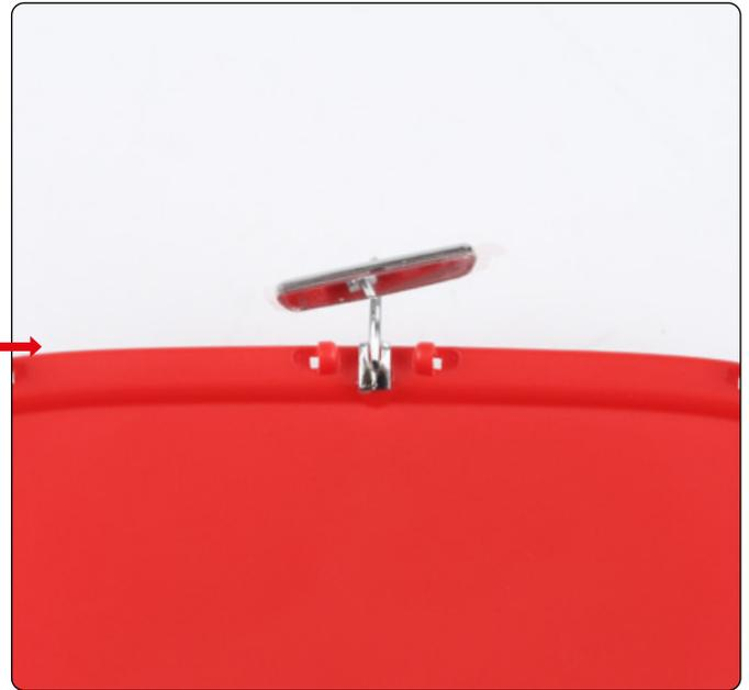
Recupere el revestimiento del techo (etapa 92) y localice el orificio modelado para el soporte del espejo retrovisor. Presione con firmeza el soporte en su sitio.
