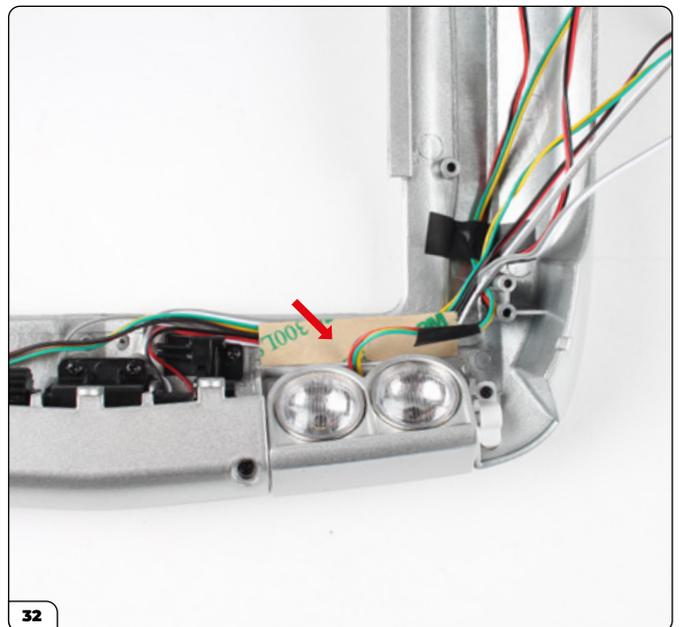
Utilice otro trozo de cinta adhesiva de doble cara grande para fijar los cables.
