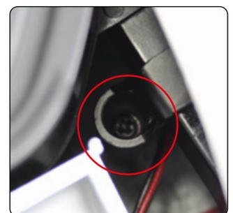
Coloque el parachoques trasero y asegúrelo con 4 tornillos CM introduciéndolos a través de los soportes y en los orificios para tornillos.
