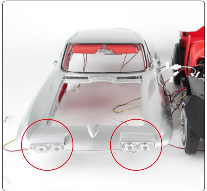
Ponga en "ON" la maqueta con el interruptor situado debajo del chasis. Tome el mando a distancia y pulse el botón de subida/bajada de los faros para girar los faros hasta su posición hacia arriba.
