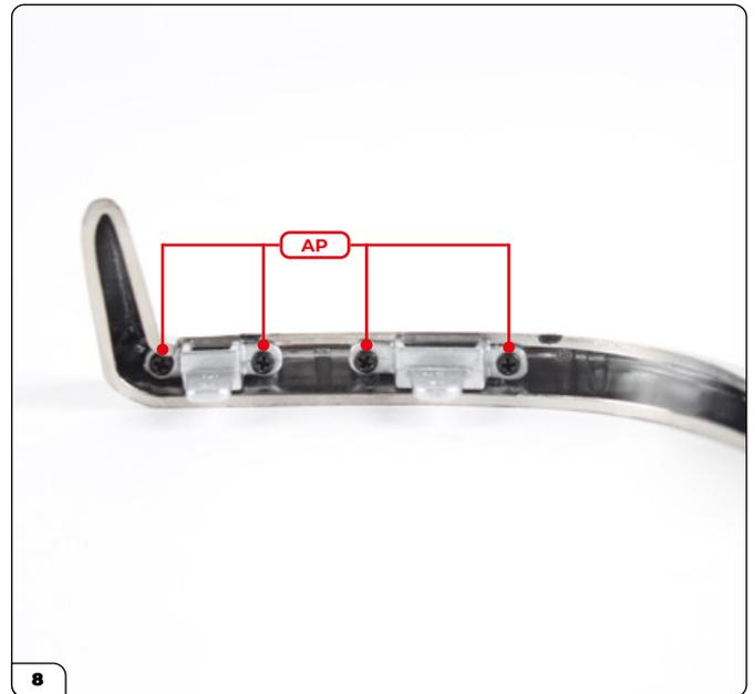
Coloque los soportes y asegúrelos con 4 tornillos AP.
