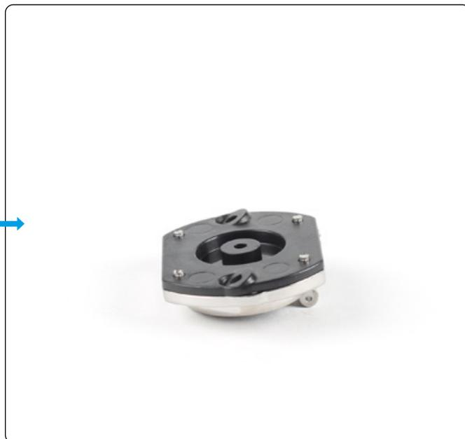
Tome la cubierta y el embellecedor de la boca de llenado de combustible. Alinee las piezas tal y como se muestra, teniendo en cuenta la inclinación de los orificios para tornillos en la cubierta y la posición del saliente en el embellecedor (marcado con un círculo). Encaje las piezas.
