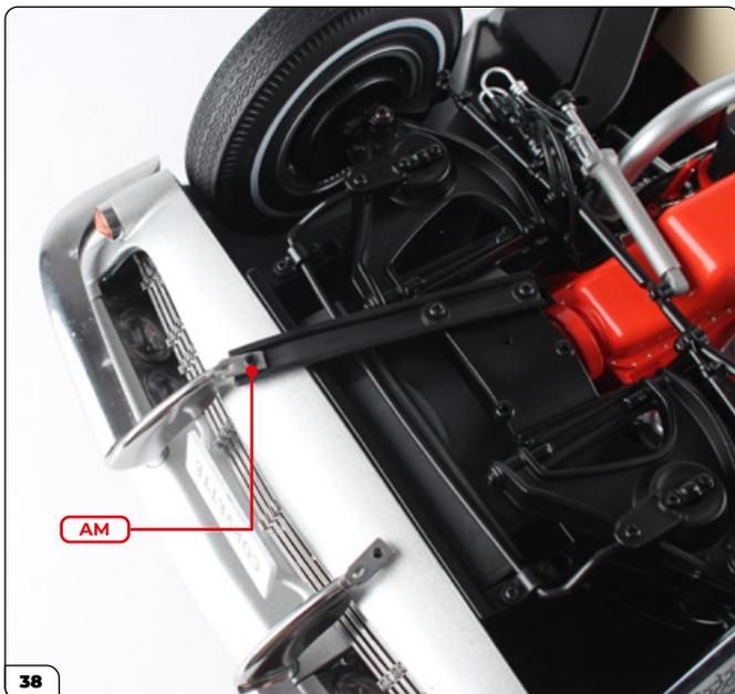
Asegure el parachoques izquierdo y el refuerzo al panel delantero de la carrocería con un tornillo AM.
