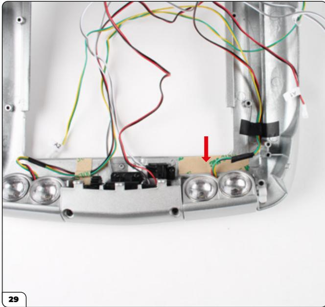
Pegue la cinta adhesiva de doble cara grande debajo del cable de los faros derechos, procurando no obstaculizar la apertura del capó.
