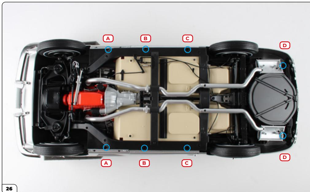
Dé la vuelta con cuidado al conjunto, colocándolo sobre un soporte blando para proteger la pintura. **Al manipular el conjunto, procure no agarrar la matrícula delantera.** La imagen de arriba muestra los puntos para la fijación de la carrocería principal con tornillos CM (marcados como A, B, C, D) y que están detallados en los siguientes pasos.
