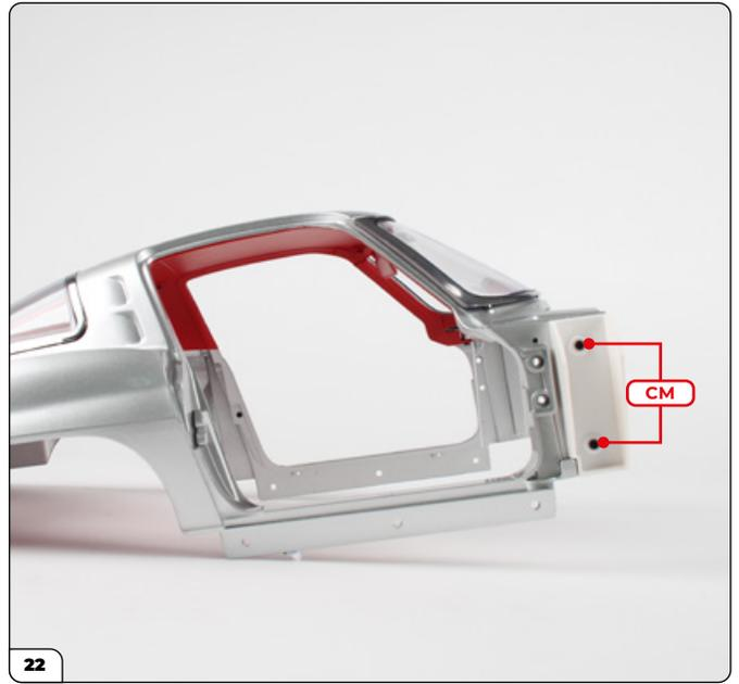
Coloque el soporte de carrocería derecho en el lado opuesto y asegúrelo con 2 tornillos CM.
