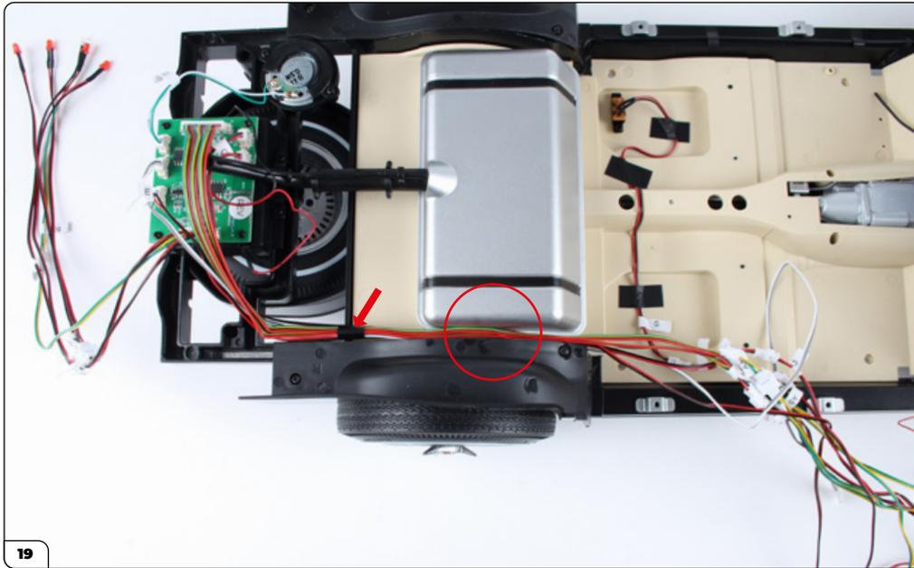
Reúna los cables "A", "E" y "Mot" conectados a la placa de circuitos, junto con el cable del interruptor de alimentación ("S"), y después únalos. Envuelva los cables con un trozo de cinta adhesiva mediana (flecha) y encájelos en el hueco que queda entre el chasis y el depósito de combustible (círculo).
