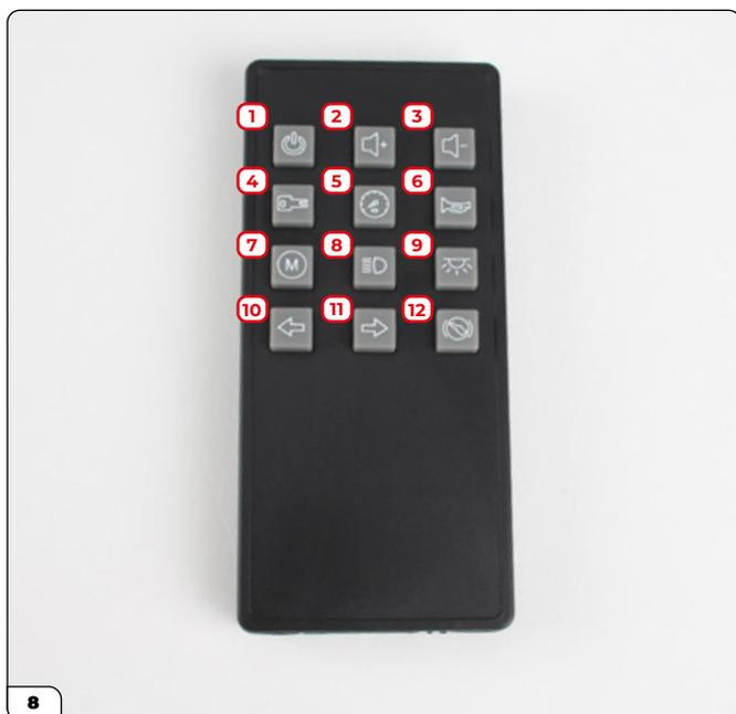
Ponga la maqueta en "ON". Tome el mando a distancia. La tabla muestra la función de los botones. Pulse el botón de arranque (4) para activar el sonido del motor y, a continuación, pruebe la aceleración (5), el claxon (6) y los controles de volumen (2 y 3). Pulse Off (1) para detener todos los sonidos.
