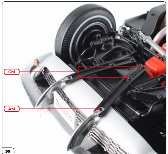
Coloque el refuerzo del parachoques derecho y asegúrelo con 2 tornillos CM y un tornillo AM de la misma manera.
