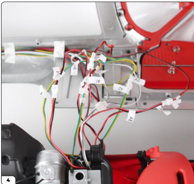
Conecte los cables en la parte delantera de los conjuntos ("A1", "A2", "A3", "A5", "A6", "E" y "Mot").
