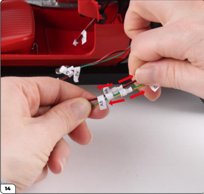
Desconecte del chasis los cables LED marcados con "A5" y "A6".
