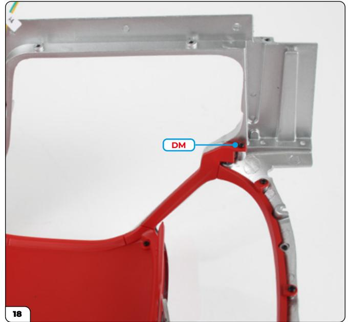
Coloque el panel interior derecho (marcado con una "R") en el otro lado y asegúrelo con un tornillo DM.
