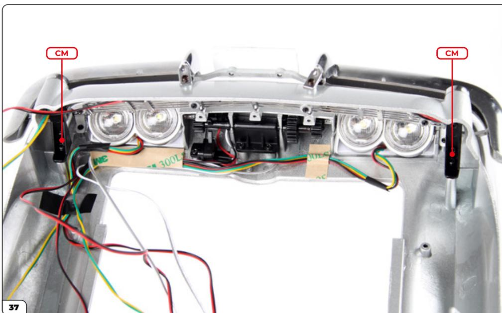
Fije los soportes del parachoques en la carrocería con 2 tornillos CM.
