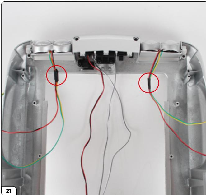
Enrolle dos trozos de cinta adhesiva mediana alrededor de los cables de los faros, tal y como se muestra.
