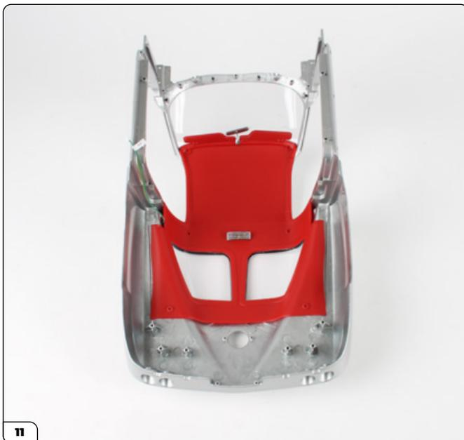
Coloque el revestimiento del techo sobre la carrocería principal.
