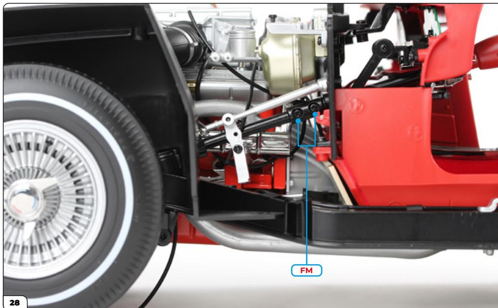
Utilice 2 tornillos FM para conectar la columna de dirección.
