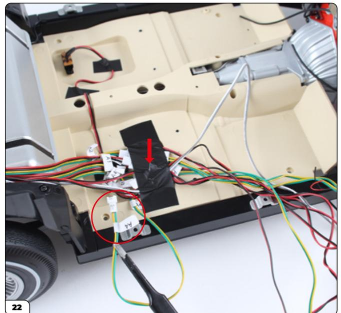
Fije las conexiones en el hueco con un trozo de cinta adhesiva grande (flecha), dejando que el cable "A4" sobresalga por el lado derecho del chasis (marcado con un círculo).
