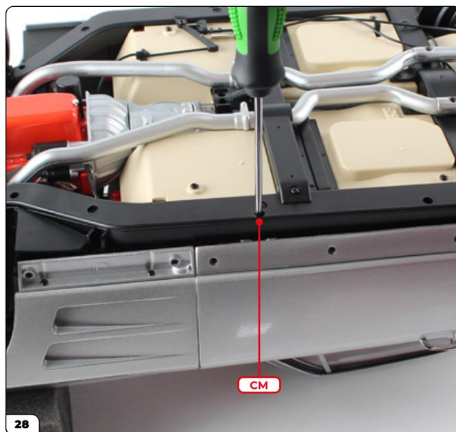
Empiece a asegurar la sección central con 2 tornillos CM introducidos a lo largo del chasis (B), uno a cada lado.
