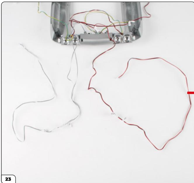
Tome la carrocería delantera (etapa 80) y desconecte los cables marcados con "Mot" y "E".
