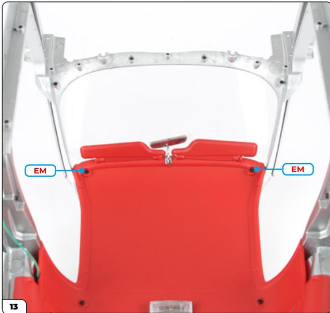
Termine de asegurar el revestimiento del techo con 2 tornillos EM en la parte delantera.
