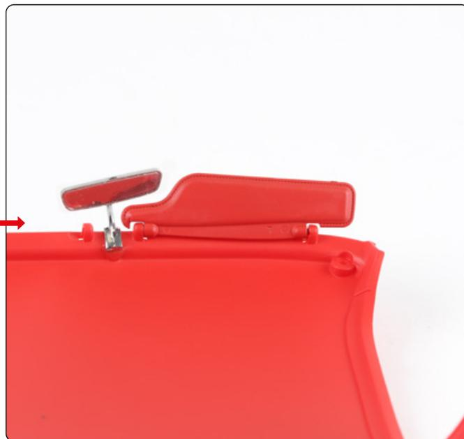
Alinee el parasol izquierdo con el revestimiento del techo y, a continuación, fíjelo en su lugar utilizando los pasadores y los orificios, tal y como se muestra.
