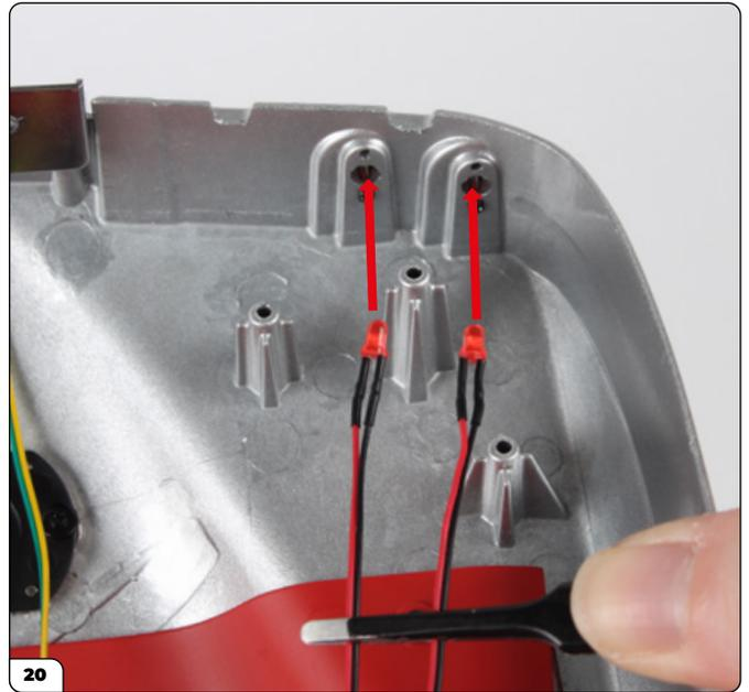
Coloque los ledes del cable "B1" en las luces traseras derechas.
