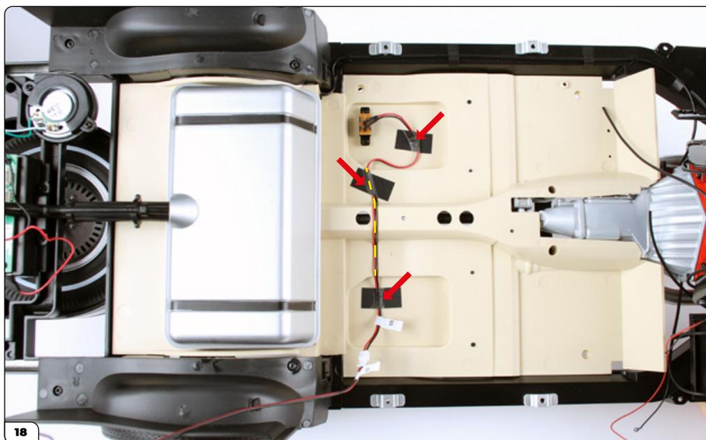
Recupere el conjunto del chasis y utilice los tres trozos pequeños de cinta adhesiva (flechas) para pegar el cable del interruptor de alimentación en el canal (línea discontinua).
