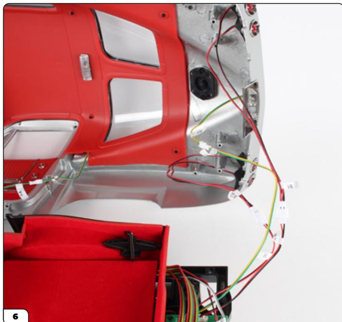
Conecte los cables "B1", "B2" y "B3" en la parte trasera de los conjuntos.
