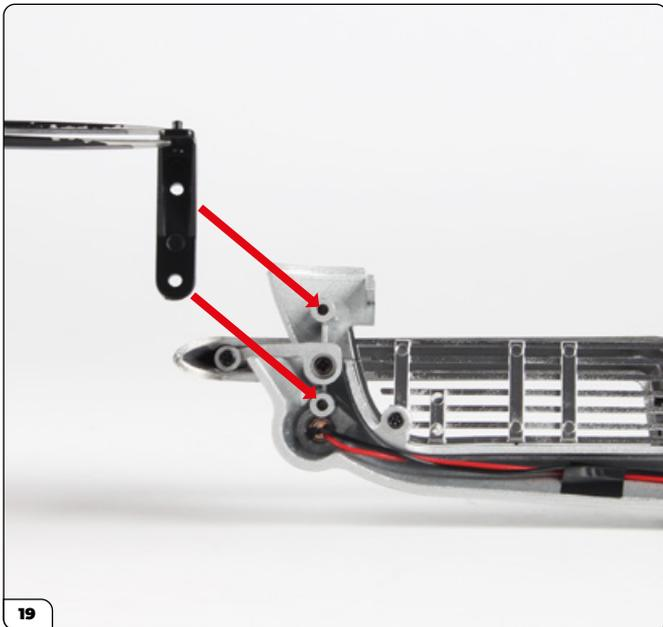
Tome uno de los soportes del parachoques delantero y encájelo en los dos orificios para tornillos del lado izquierdo del panel de la carrocería. Asegúrelo con 2 tornillos DM.
