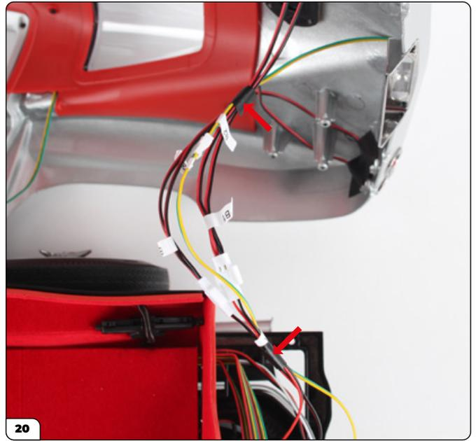
Reúna los cables en la parte trasera de la maqueta y fíjelos con dos trozos de cinta adhesiva mediana.
