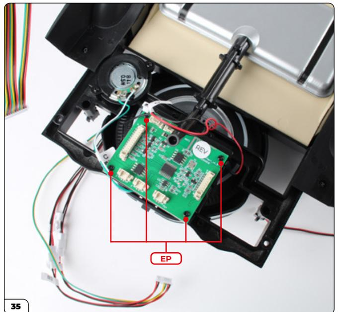
Coloque en su sitio la placa de circuitos de repuesto (marcada con "REV") y asegúrela con 4 tornillos EP.
