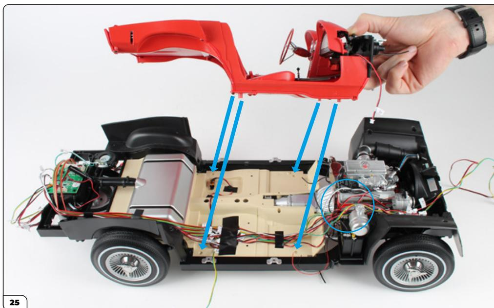
Dirija los cables hacia la parte delantera del chasis (marcada con un círculo) y, a continuación, alinee el conjunto interior con el chasis. Hay cuatro postes que encajan en los correspondientes orificios para tornillos (flechas).
