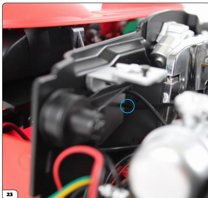
Localice el extremo de la tubería instalada en el colector de admisión.
