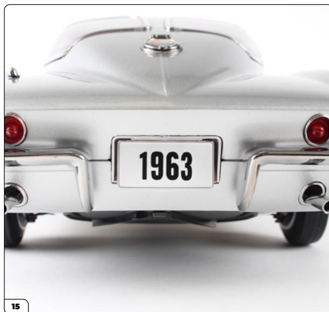
Coloque la matrícula trasera. Es posible que tenga que presionar la carrocería principal hacia abajo para alinear los orificios en el soporte y en el chasis.
