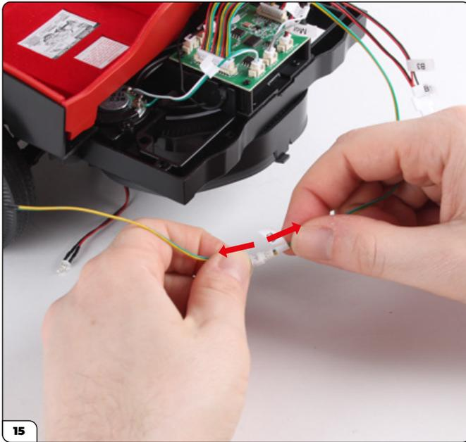
Desconecte el cable LED marcado con "B2" del conjunto principal.
