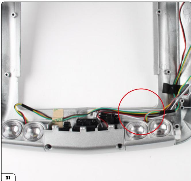
Pegue los cables de los faros izquierdo y derecho, junto con los cables del motor y de alimentación ("Mot" y "E"), a la cinta adhesiva tal y como se muestra.
