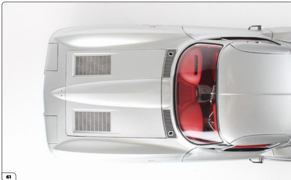
Cierre el capó. Si no queda enrasado, compruebe si hay cables eléctricos o piezas desalineadas y apriete los tornillos de las bisagras del capó.
