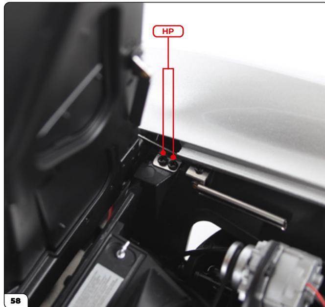
Fije la bisagra derecha del capó con 2 tornillos HP.
