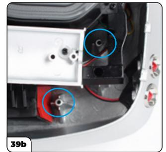
Alinee el parachoques trasero con el conjunto tal y como se muestra. Hay cuatro postes para tornillos (39a y 39b) en los que encajar los soportes del parachoques trasero.
