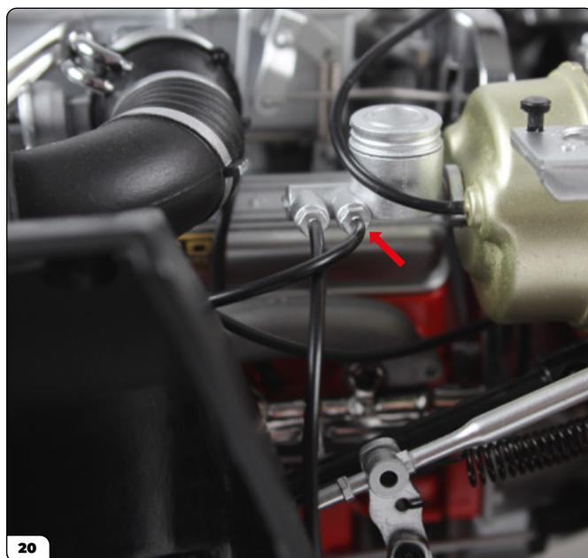
Conecte la tubería al pasador derecho de la bomba de embrague y recórtela si es necesario.
