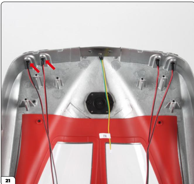
Coloque los ledes del cable "B3" en las luces traseras izquierdas.
