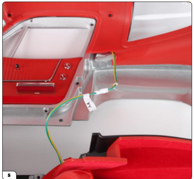
Conecte el cable "A4" en la parte central de los conjuntos.
