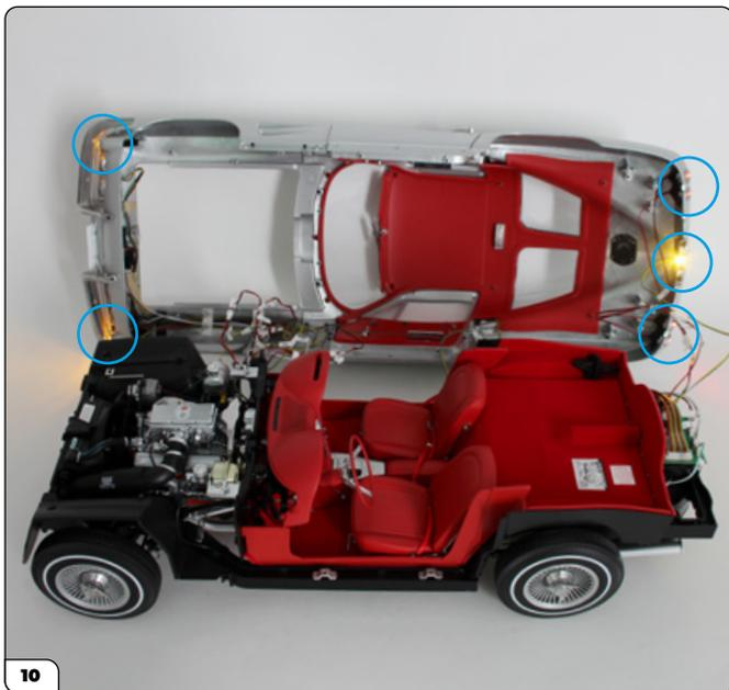
Pulse una vez el botón de las luces (8) para encender los intermitentes delanteros, las luces de freno y la luz de la matrícula trasera. El salpicadero se iluminará (ver paso 18).
