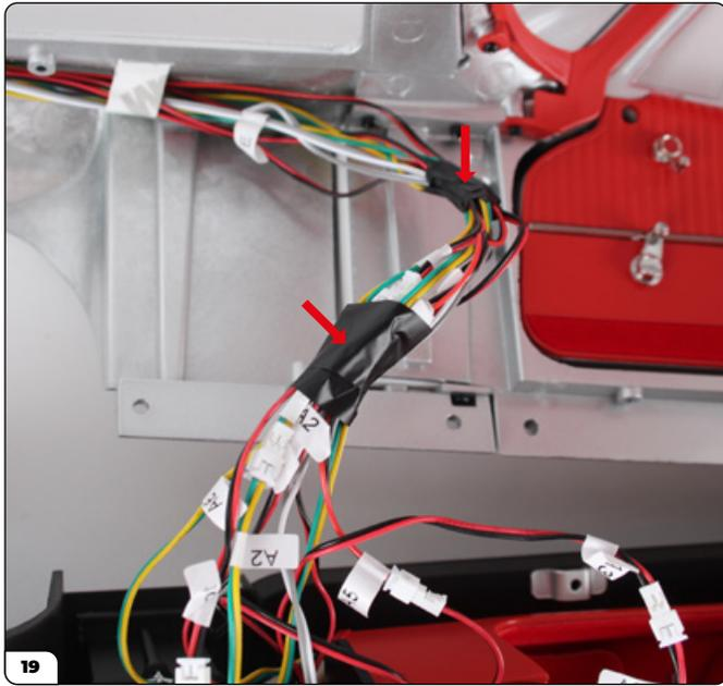
Reúna los cables en la parte delantera de la maqueta y fíjelos con dos trozos de cinta adhesiva grande.
