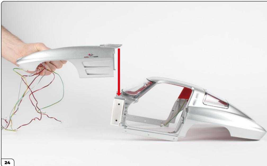
Alinee los conjuntos de carrocería delantera y carrocería principal tal y como se muestra.
