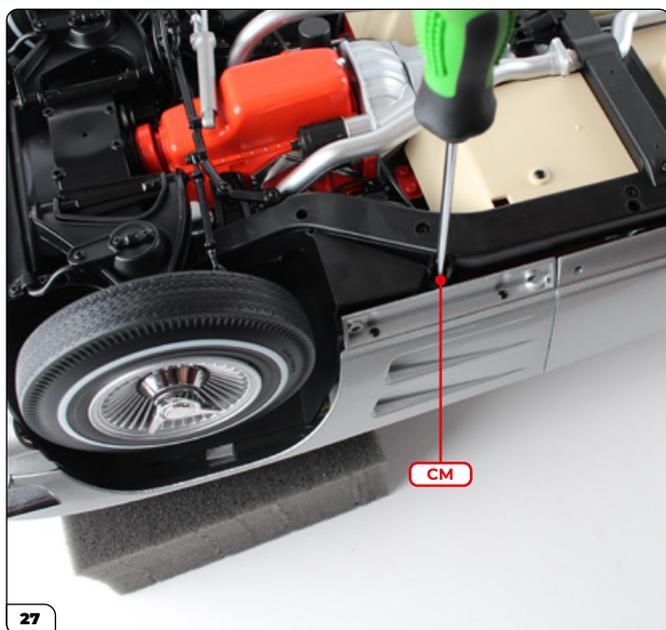
Asegure la sección delantera con 2 tornillos CM introducidos detrás de las ruedas delanteras (A), uno a cada lado.
