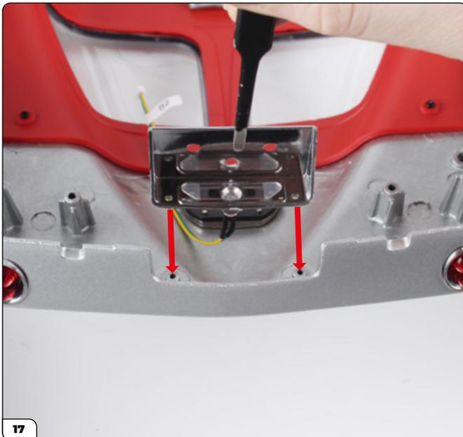
Coloque el soporte en los postes para tornillos situados en la parte trasera de la carrocería principal.
