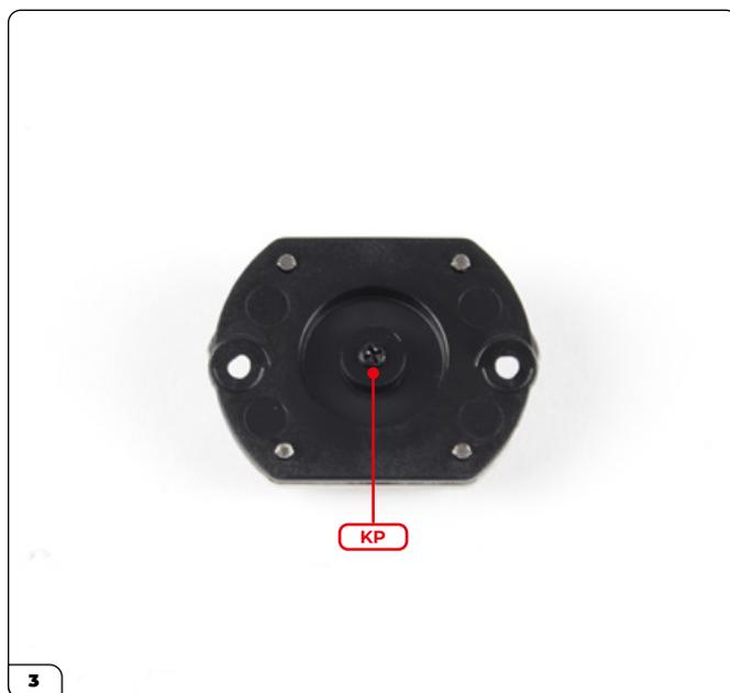
Tome el tapón de combustible y encaje el pasador en la cubierta.
