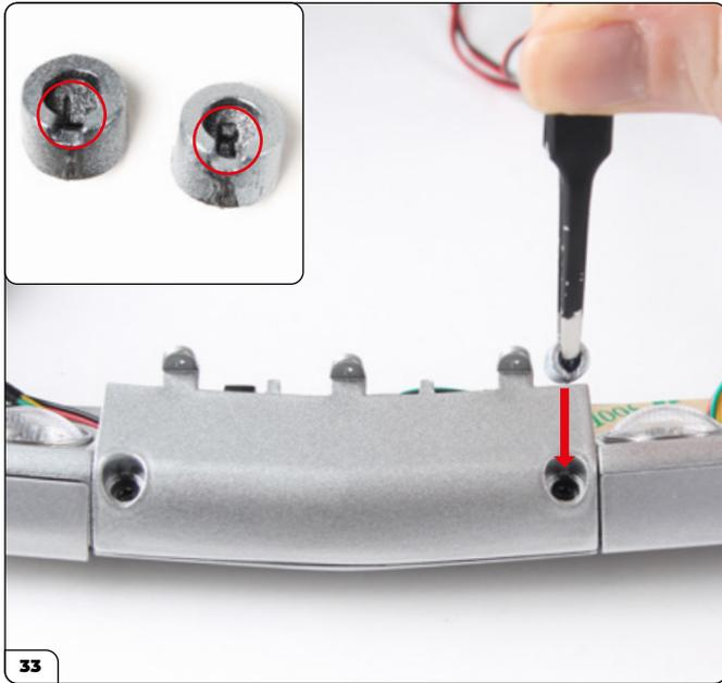
Tome los tapones roscados del morro (etapa 96), que están moldeados y marcados con "L" y "R" (recuadro). Coloque el tapón derecho sobre el tornillo visible de la parte inferior del morro.
