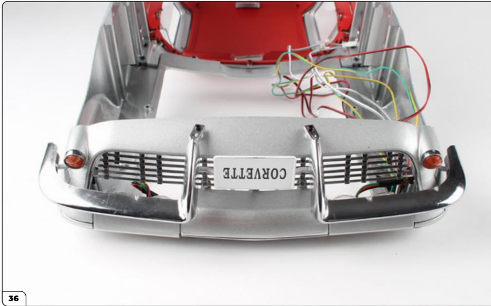
Encaje el parachoques en la carrocería.
