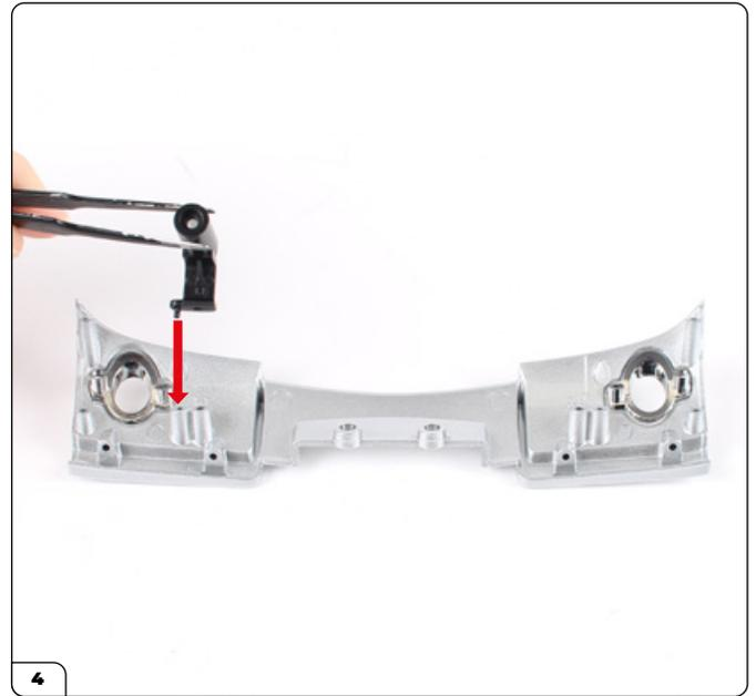
Coloque el soporte "L1" en los postes marcados con "L1" en el panel central.
