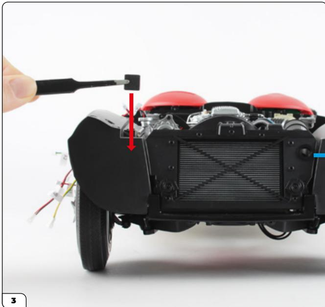
Despegue el amortiguador de espuma del papel protector y péguelo en el paso de rueda delantero derecho.
