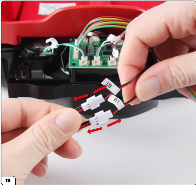
Desconecte los cables LED marcados con "B1" y "B3" del conjunto principal.
