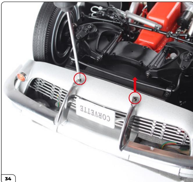
Retire los tornillos de los parachoques delanteros.
