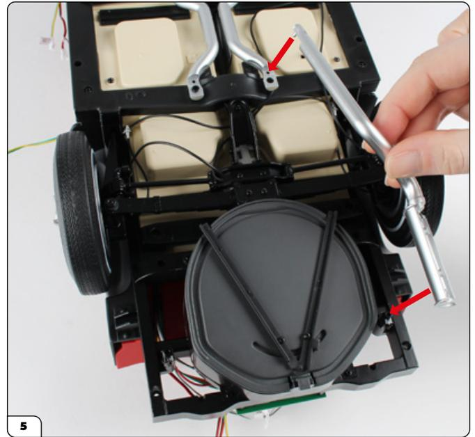
5 Alinee el tubo de escape y el silenciador izquierdos con la parte inferior del chasis, tal y como se muestra.
