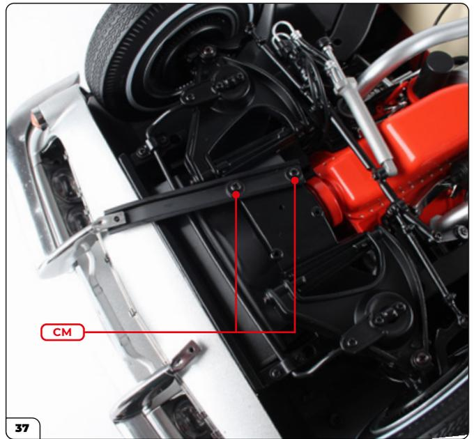
Asegure el refuerzo al chasis con 2 tornillos CM.
