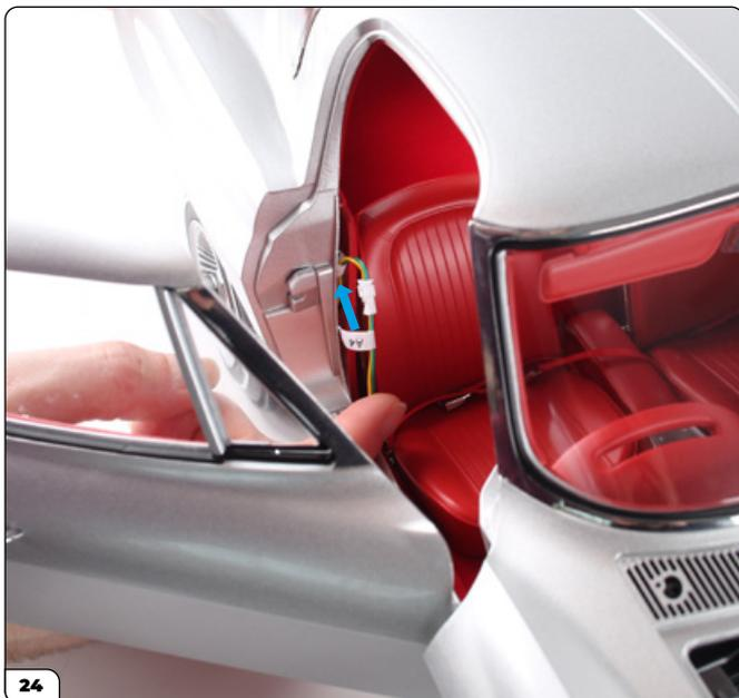
24 Introduzca el cable central "A4" en el hueco entre el revestimiento interior y la carrocería.
