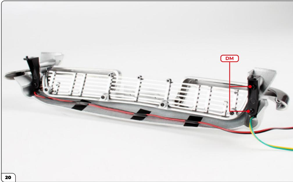
Encaje el otro soporte del parachoques en el lado derecho y asegúrelo con 2 tornillos DM.
