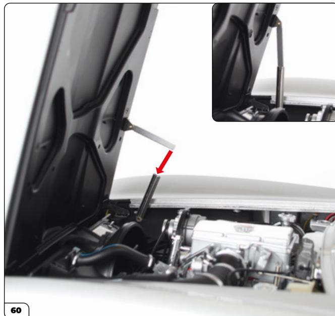
Encaje el soporte interior del capó en el soporte exterior del capó.
