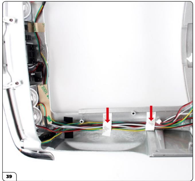
Utilice dos trozos de cinta adhesiva de doble cara mediana para fijar los cables a lo largo del lado derecho de la carrocería principal.
