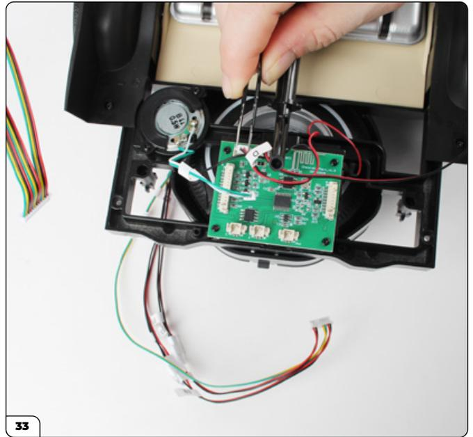
Desconecte con cuidado todos los cables de la placa de circuitos.
