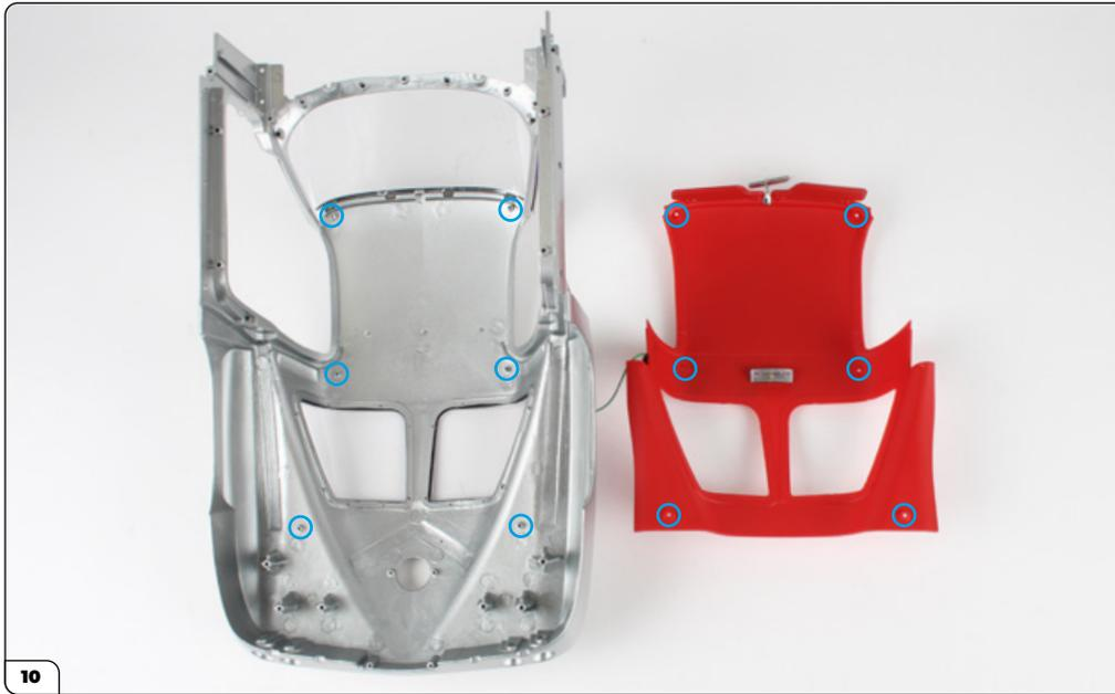
Recupere la carrocería principal (etapa 91) y alinéela con el revestimiento del techo, tal y como se muestra. Identifique los seis puntos de fijación (marcados con un círculo).
