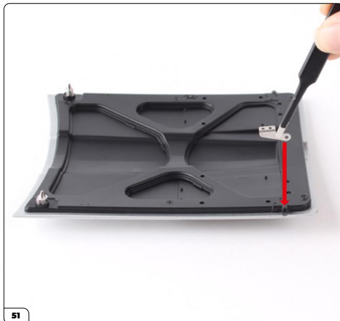
Coloque la bisagra izquierda del capó en el capó como se muestra.
