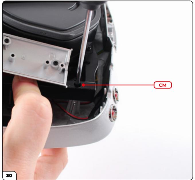
Asegure la sección trasera introduciendo 2 tornillos CM en los orificios situados junto a los silenciadores (D), uno a cada lado.
