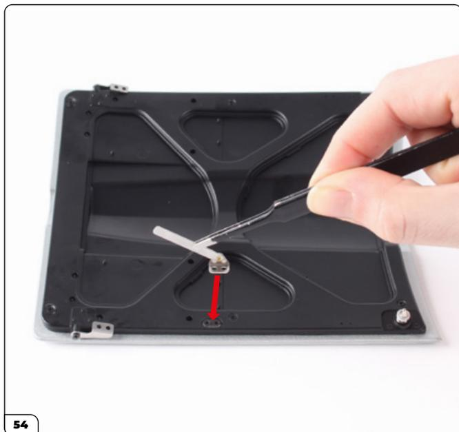
Monta il supporto interno del cofano sui due fori per viti ricavati sul lato destro.
