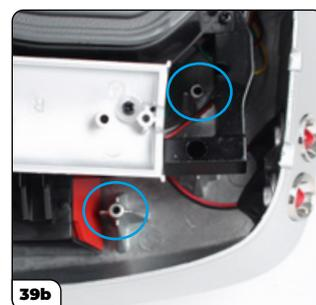
Allinea il paraurti posteriore al telaio come mostrato. Ci sono quattro fori in rilievo per viti (figure 39a e 39b) in cui inserire gli attacchi del paraurti posteriore.
