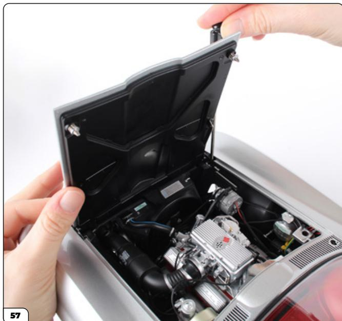
Per fissare i cardini, avrai bisogno di un cacciavite sottile, come quello mostrato nella foto, per accedere ai fori per viti. Fai attenzione a non rovinare la verniciatura del cofano.
