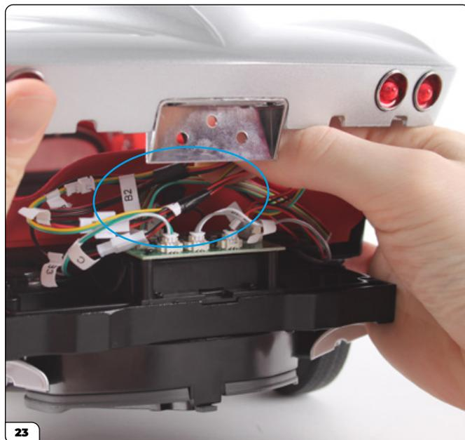
23 Inserisci il fascio di cavi posteriori nello spazio tra la scheda elettronica e il serbatoio del carburante.
