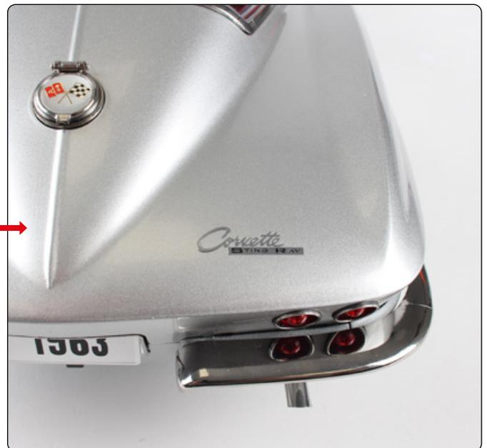
Recupera dall'acqua la decalcomania. Utilizzando la marcatura come guida, applica con cautela la decalcomania sulla carrozzeria, allineando la "C" di "Corvette" alla marcatura. **Fai attenzione durante l'applicazione perché la decalcomania si incolla rapidamente e la superficie metallica rende più difficoltoso l'eventuale riposizionamento.**
