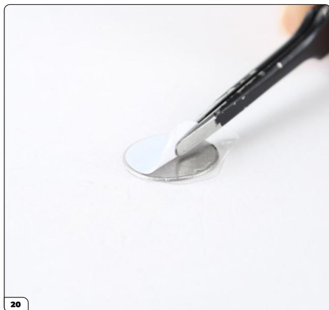
Solleva il riflettore del retrovisore laterale dalla carta di supporto bianca. Per il momento, non rimuovere la pellicola protettiva, la toglierai una volta che il retrovisore laterale sarà stato montato.
