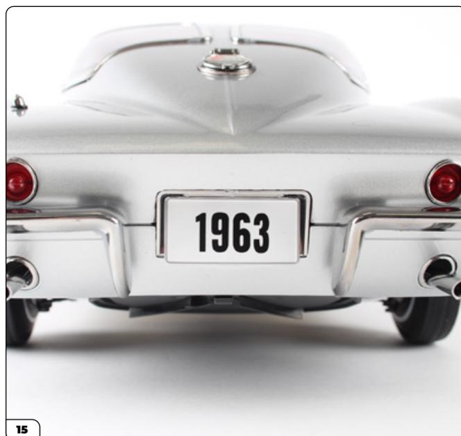
Monta la targa. Potrebbe essere necessario esercitare una leggera pressione sulla carrozzeria per allineare al telaio i fori ricavati nel supporto.
