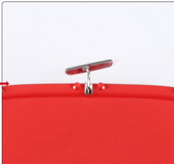
Recupera il cielo dell'abitacolo (fase 92) e individua il foro sagomato per il montaggio del supporto del retrovisore. Inserisci il supporto in sede, premendo con decisione.
