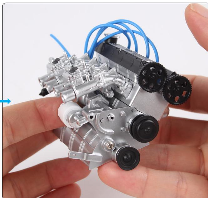
Stecken Sie den Stift und den Schraubenpfosten an der Ölpumpe in die entsprechenden Löcher in der Halterung. Dies wird in der nächsten Phase gesichert.
