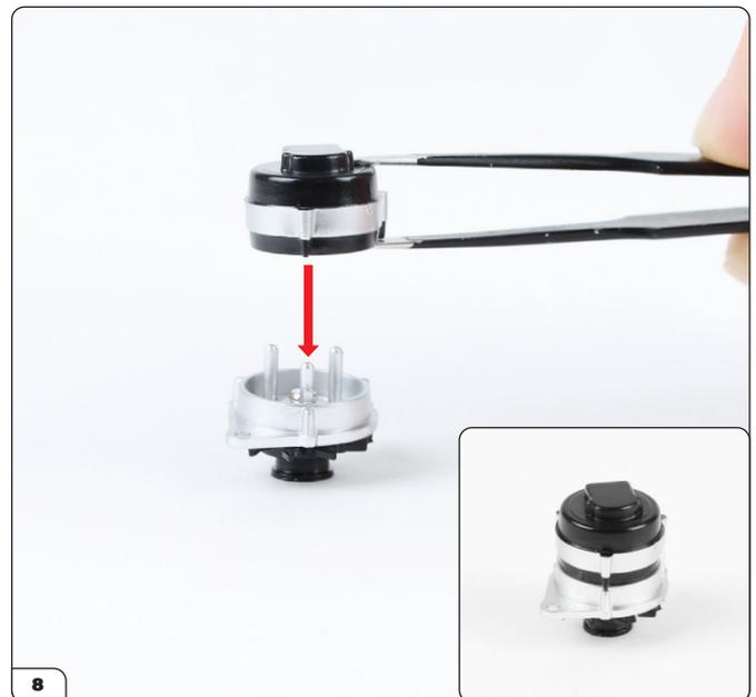
Richten Sie das geformte Loch und den Stift auf den Teilen aus und drücken Sie sie dann zusammen (Einsatz).
