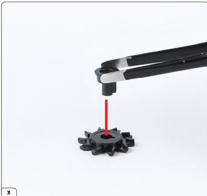
Coloca la polea del alternador (21-F) en el agujero con forma en el rotor del alternador (21-E). Asegúrate de que los dientes del rotor estén orientados como se muestra.
