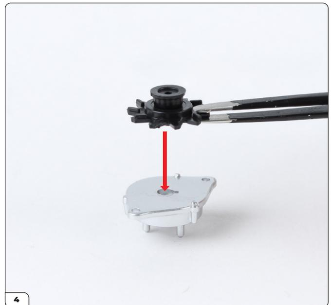
Toma la parte B (21-C) del alternador. Ajusta el rotor y la polea en el agujero formado.
