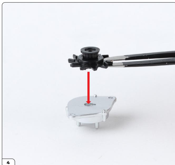
Prendi la parte B (21-C) dell'alternatore. Monta il rotore e la puleggia nel foro sagomato.
