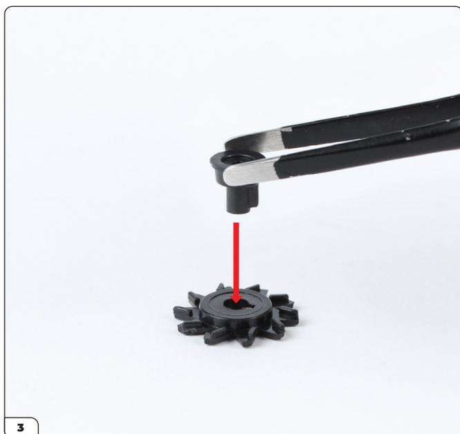
Inserisci la puleggia dell'alternatore (21-F) nel foro sagomato del rotore dell'alternatore (21-E). Assicurati che i denti del rotore siano orientati come mostrato.
