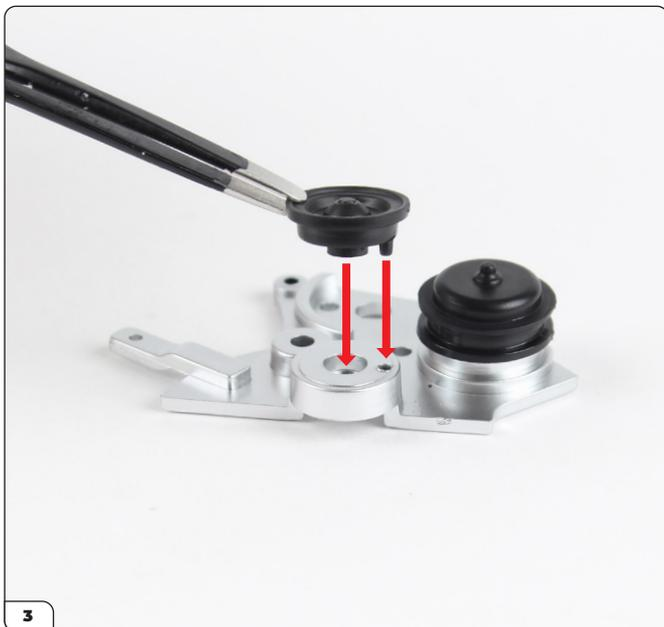
Monta la puleggia piccola (19-D) sull'altro supporto utilizzando il perno e il montante della vite.
