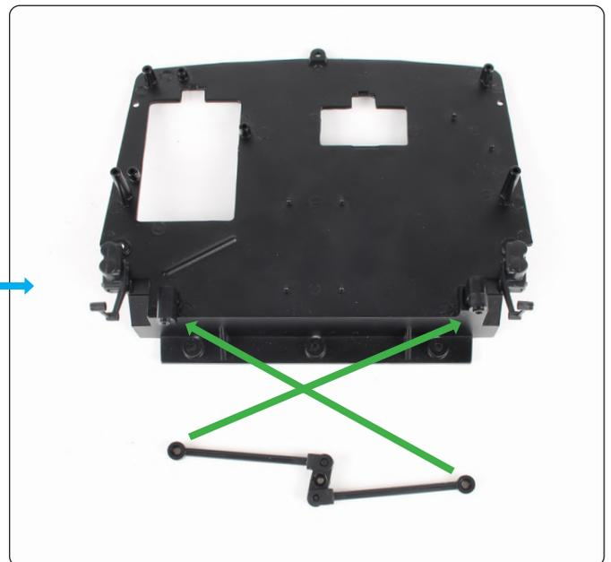
Die Stabilisatorstangen müssen die Positionen tauschen. Entfernen Sie die beiden PS25-Schrauben und legen Sie sie beiseite, dann entfernen Sie die Stabilisatorstangen. Die grünen Pfeile zeigen die neuen Positionen der Stangen.
