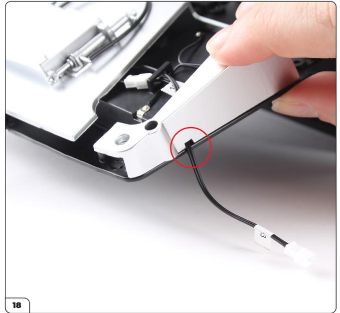
Setzen Sie die Unterplatte ein und achten Sie darauf, dass die Kabel Nr. 13 und Nr. 14 in den Nuten positioniert sind.
