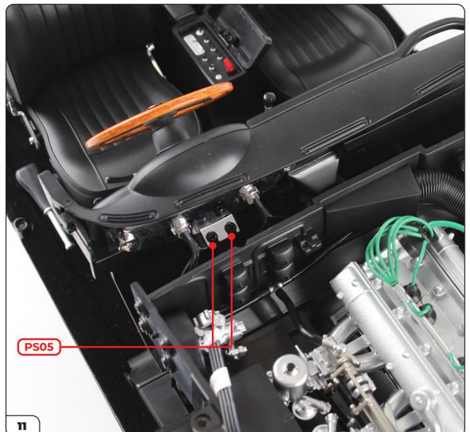
Verwenden Sie 2x PS05 Schrauben, um das Gehäuse des Zifferblattes zu befestigen.
