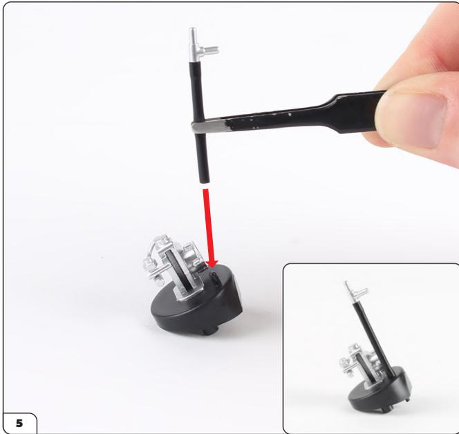
Stecken Sie das andere Ende des Rohrs auf den Stift an der Halterung des Bremsservos.
