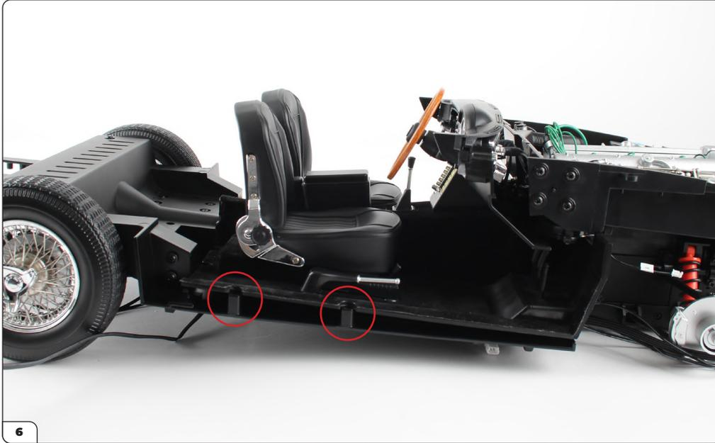
Setzen Sie den Innenraum vorsichtig ein und richten Sie die Vertiefungen auf die Schraubpfosten aus. Überprüfen Sie, ob keine der Drähte eingeklemmt wurden. Hinweis: Verwenden Sie ab jetzt eine Unterstützung, wenn Sie die Baugruppe auf den Kopf stellen, um zu vermeiden, dass das Lenkrad beschädigt wird.
