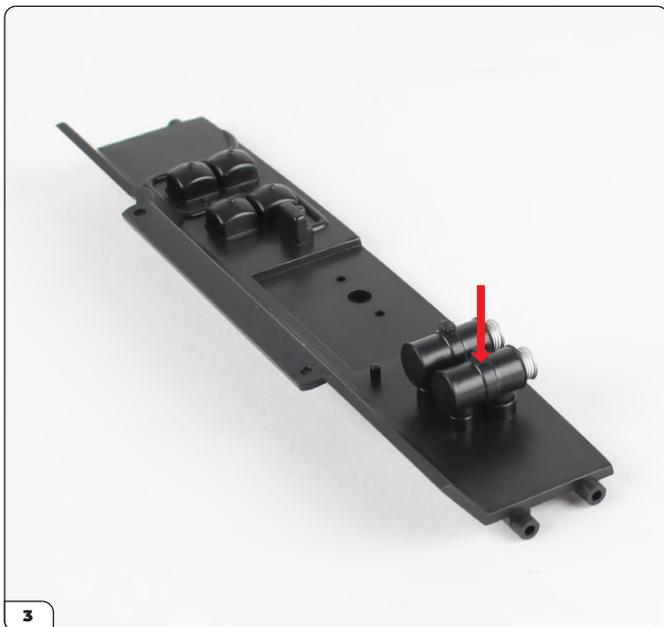
Setzen Sie den anderen Behälter auf die gleiche Weise ein. Die Bremsflüssigkeitsbehälter sind identisch und können auf beide Weisen positioniert werden.
