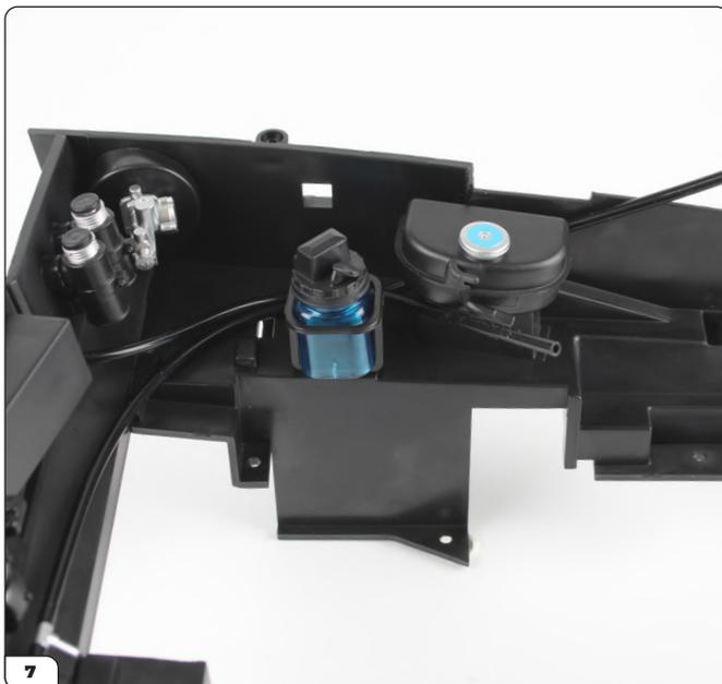
Setzen Sie den Halter ein. Beachten Sie, dass die Waschflasche auch nach der Befestigung des Halters locker sein wird. Sie möchten ihn vielleicht fürs Erste an einem sicheren Ort aufbewahren.
