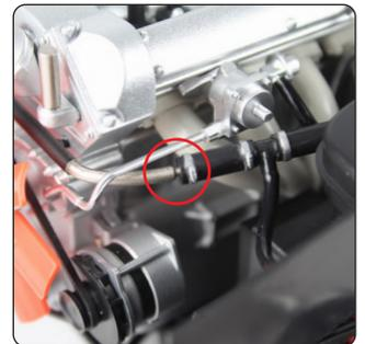
Setzen Sie den Motor ein. Die Antriebswelle sollte in das Getriebe passen (siehe Kreis). Stellen Sie sicher, dass der Motor in den zwei in Schritt 3 hervorgehobenen Schraubenlöchern sitzt. Verbinden Sie das Tankrohr mit dem silbernen Stift (rechtes Bild).
