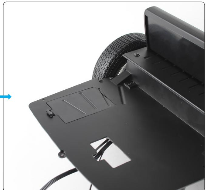
Drehen Sie die Baugruppe um und setzen Sie die Abdeckung des Batteriefachs ein.
