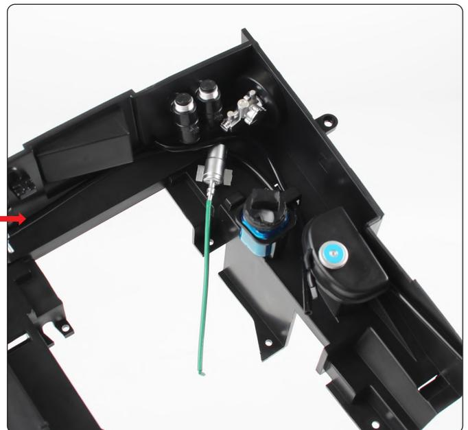
Richten Sie die Zündspule auf die beiden Löcher in der Motorraum-Baugruppe aus und setzen Sie sie ein. Eines der Löcher ist so geformt, dass es richtig passt.
