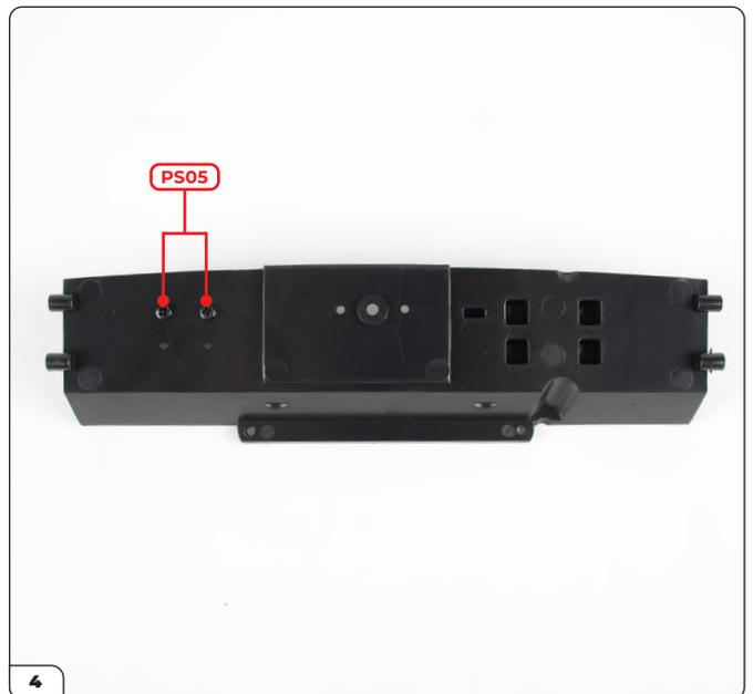
Befestigen Sie die Behälter von der anderen Seite mit 2x PS05 Schrauben.
