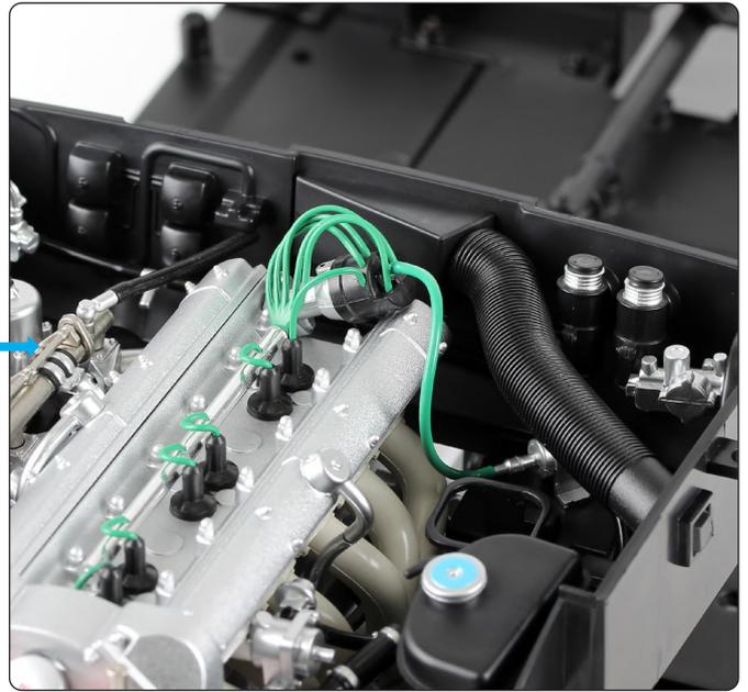
Nehmen Sie das grüne Rohr und schieben Sie das L-Verbindungsstück in das kleine Loch im Verteiler ein. Wenn es schwer einzupassen ist, entfernen Sie vorsichtig überschüssiges Material vom L-Verbindungsstück.
