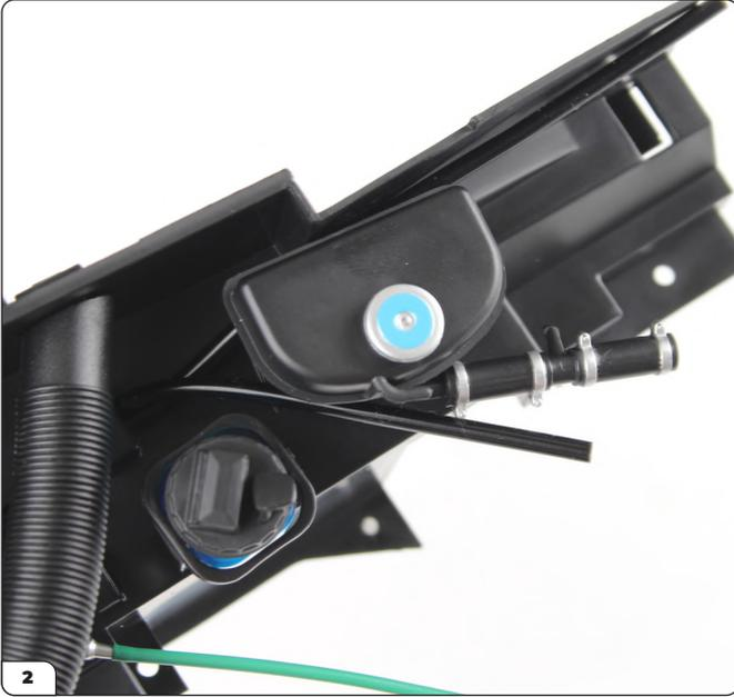
Setzen Sie das Tankrohr auf den Tank. Die Befestigung hat die Form eines "D", um die korrekte Ausrichtung sicherzustellen.
