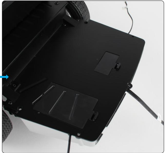
Setzen Sie die Abdeckung des Minenfachs in die Öffnung im hinteren Fahrgestell ein.
