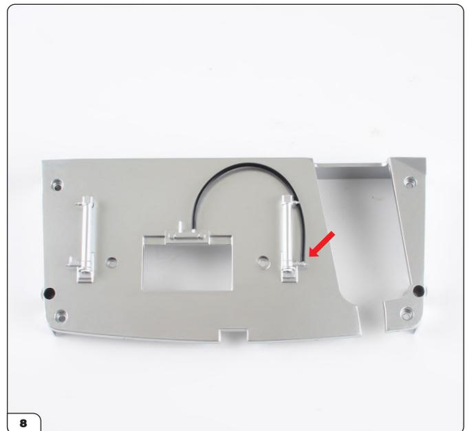
Nehmen Sie eines der Rohre (65-D) und setzen Sie es auf den Stift des Doppelanschlusses.
