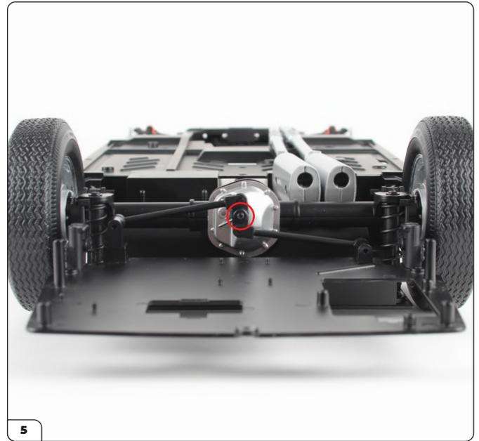
Setzen Sie das hintere Fahrgestell wieder ein. Positionieren Sie die Verbindung der Stabilisatorstange wie gezeigt und sichern Sie sie mit der in Schritt 1 entfernten PS14 Schraube (siehe Kreis).
