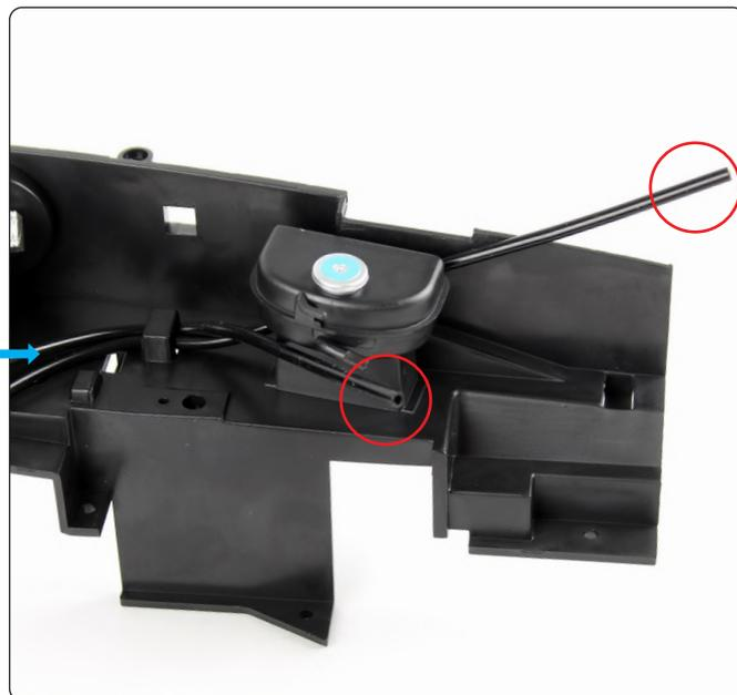
Richten Sie den Kühlerbehälter auf die rechteckige Halterung aus und setzen Sie ihn wie gezeigt ein. Beachten Sie, dass das lange und kurze Rohr auf beiden Seiten der rechteckigen Halterung bleiben sollten (siehe Kreis).
