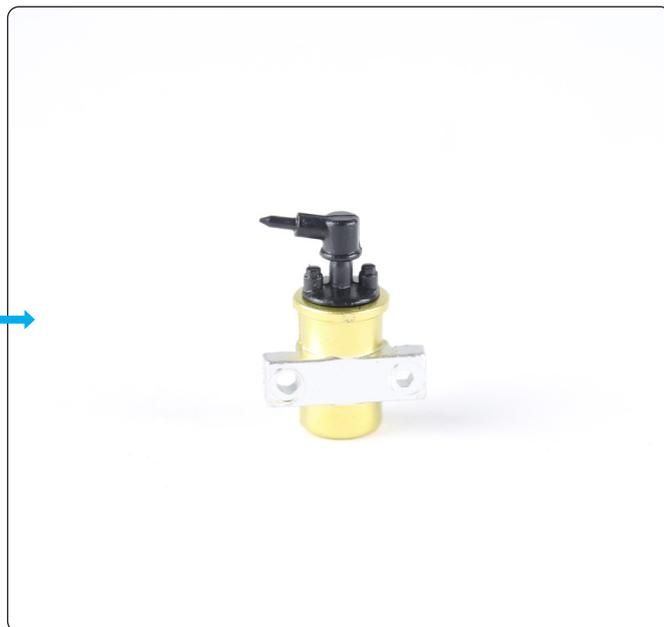
Monta il connettore della bobina (31-C) sulla bobina (31-B).
