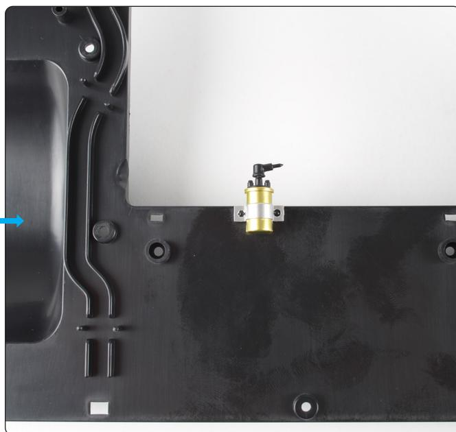
Premi la bobina sui due perni sul lato inferiore del pavimento posteriore (31-A).
