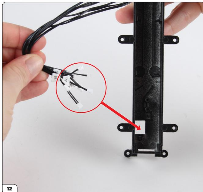
Inserisci le estremità dei fili nella apertura rettangolare alla fine del tunnel di trasmissione.
