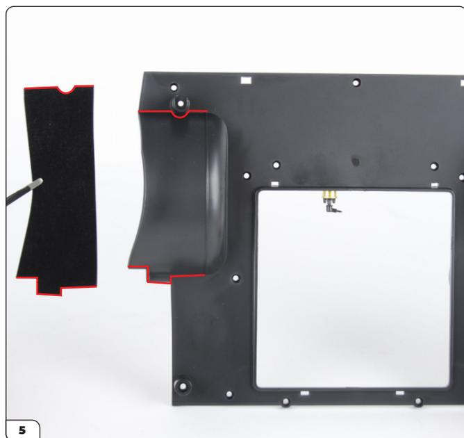
Allinea D-2 con la parte superiore del passaruota posteriore destro sul pavimento interno. Nota la forma come indicato dalle linee rosse.
