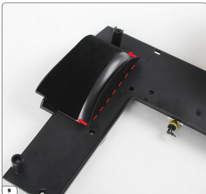
Applica l'adesivo D-3 all'interno dell'arco della ruota, adattando il bordo piatto al pavimento (linea tratteggiata) e allineando le estremità con D-2 (freccette).
