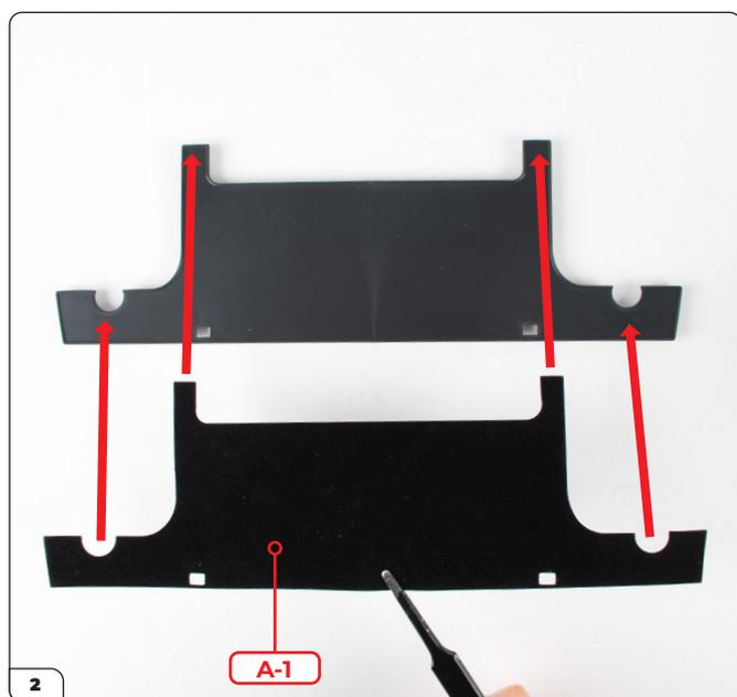
Stacca l'adesivo A-1 dalla carta di supporto e allinealo con il pannello del pavimento posteriore (34-A).
