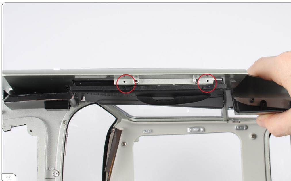
左ボディインサイドパネル(84-A)をドアシルの下に押し込みます。パネルの2本の突起を、ドアシルの穴(赤丸印)にはめ込みます。
