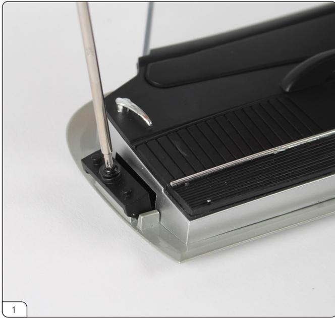
**右ドアの取り付け** ステージ007で組み立てた右ドアをボディに取り付けます。DS12ネジにグリースを少量塗布し、マウントにあらかじめタッピング(ネジをある程度締め込む)します。タッピングしたネジは外してください。
