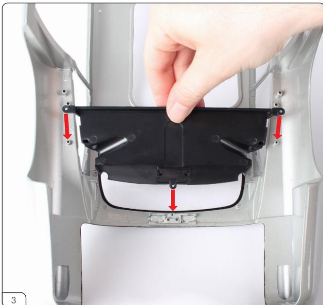
ボディを裏側にして作業台上に置きます(塗装を保護するために柔らかいシートなどを敷いてください)。リアデッキ(76-A)をリアウインドウのネジ穴に合わせてます(赤矢印)。
