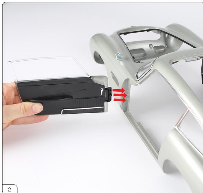
左ドアのマウントをボディ左側の3つの穴に合わせて押し込みます。
