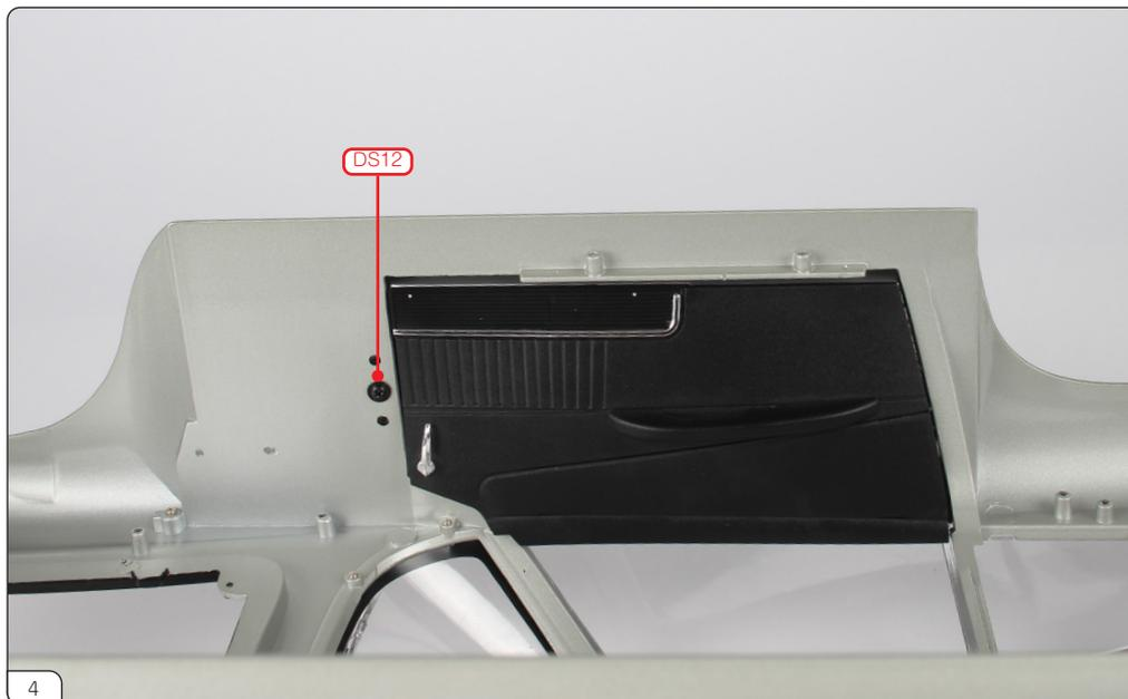
内側からDS12ネジで左ドアを固定します。固定後、ドアがスムーズに開閉することを確認してください。ドアがぐらつく場合は、ネジがしっかり締まっているか確認しましょう。
