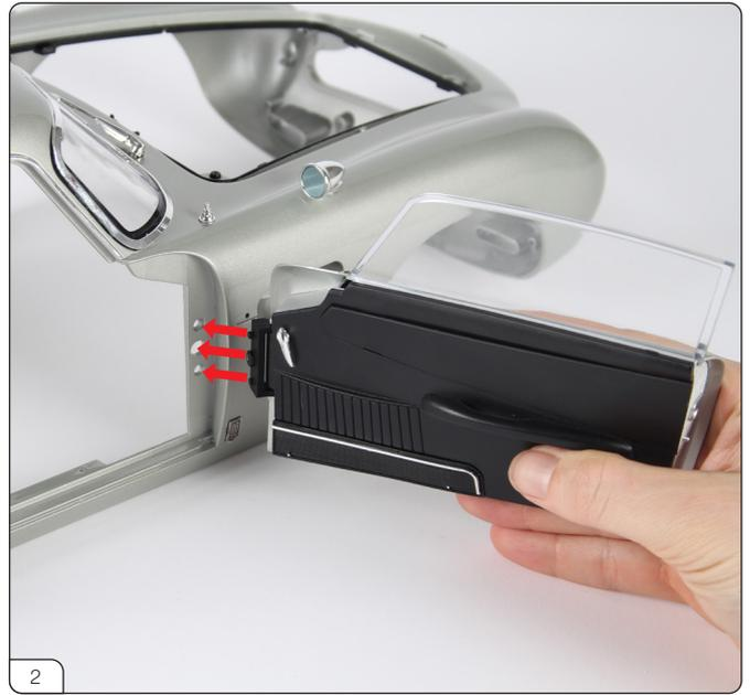
右ドアのマウントをボディ右側の3つの穴に合わせて押し込みます。
