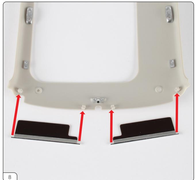
左サンバイザー(80-A)と右サンバイザー(80-B)を、画像のようにルーフライナーにセットします。パーツの向きに注意してください(取り付け方は次の工程参照)。
