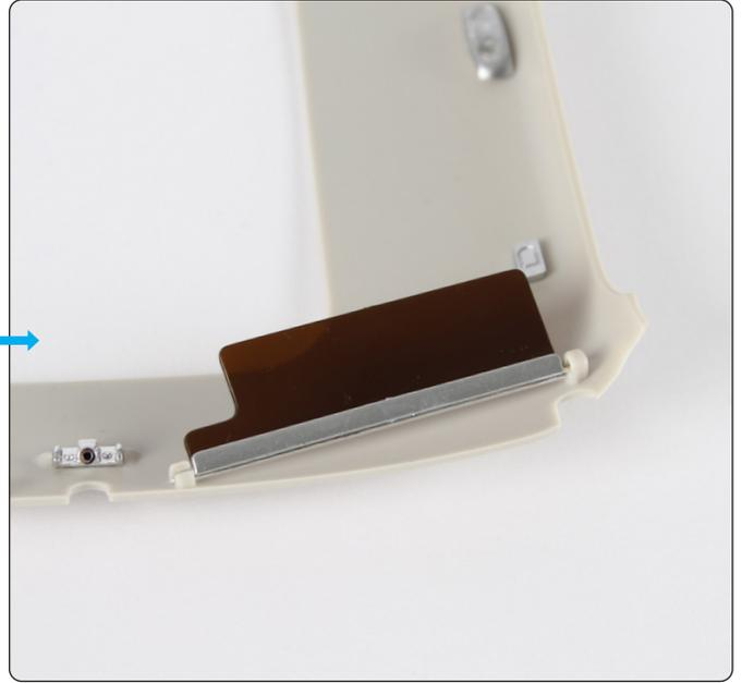
まず、右サンバイザー(80-B)です。突起を外側の穴(赤丸印)に入れ、もう一方の突起をクリップにはめ込みます(赤矢印)。
