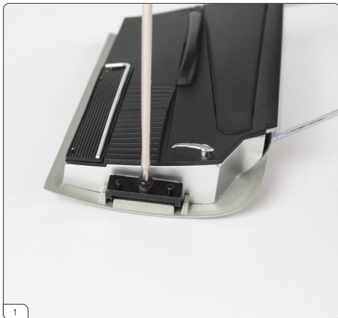
**左ドアの取り付け** ステージ072で組み立てた左ドアをボディに取り付けます。DS12ネジにグリースを少量塗布し、マウントにあらかじめタッピング(ネジをある程度締め込む)します。タッピングしたネジは外してください。
