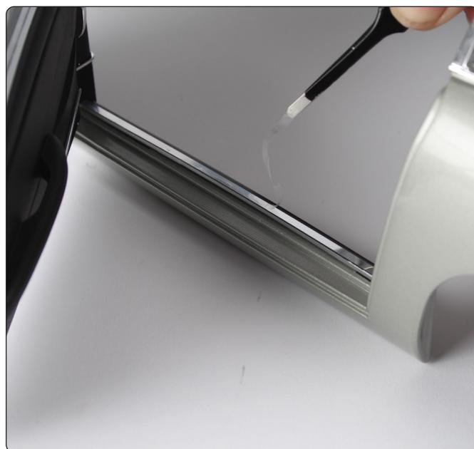
左右のドアとボディインサイドパネルの取り付けが終了したら、左右のドアシルトリムステッカーの透明保護テープを剥がします。
