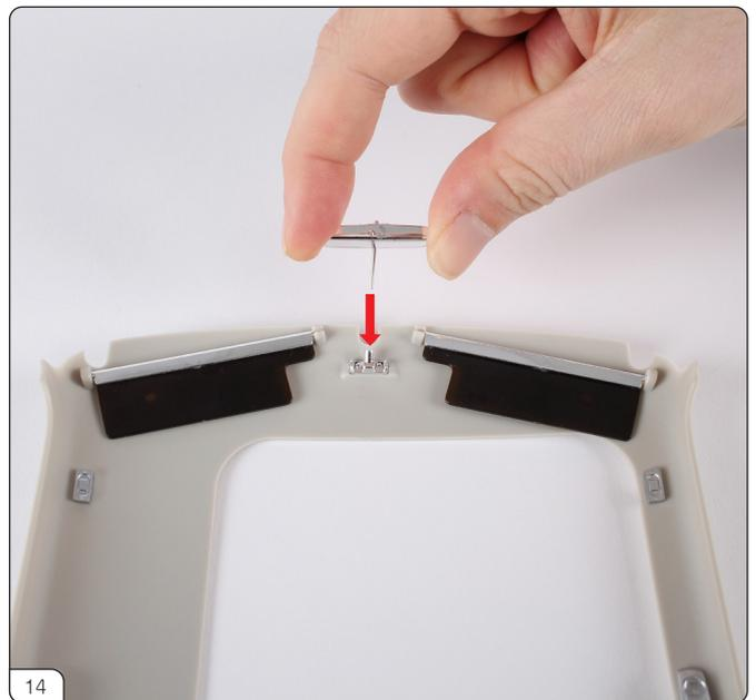
バックミラーをサンバイザーの間の穴に押し込みます (赤矢印)。
