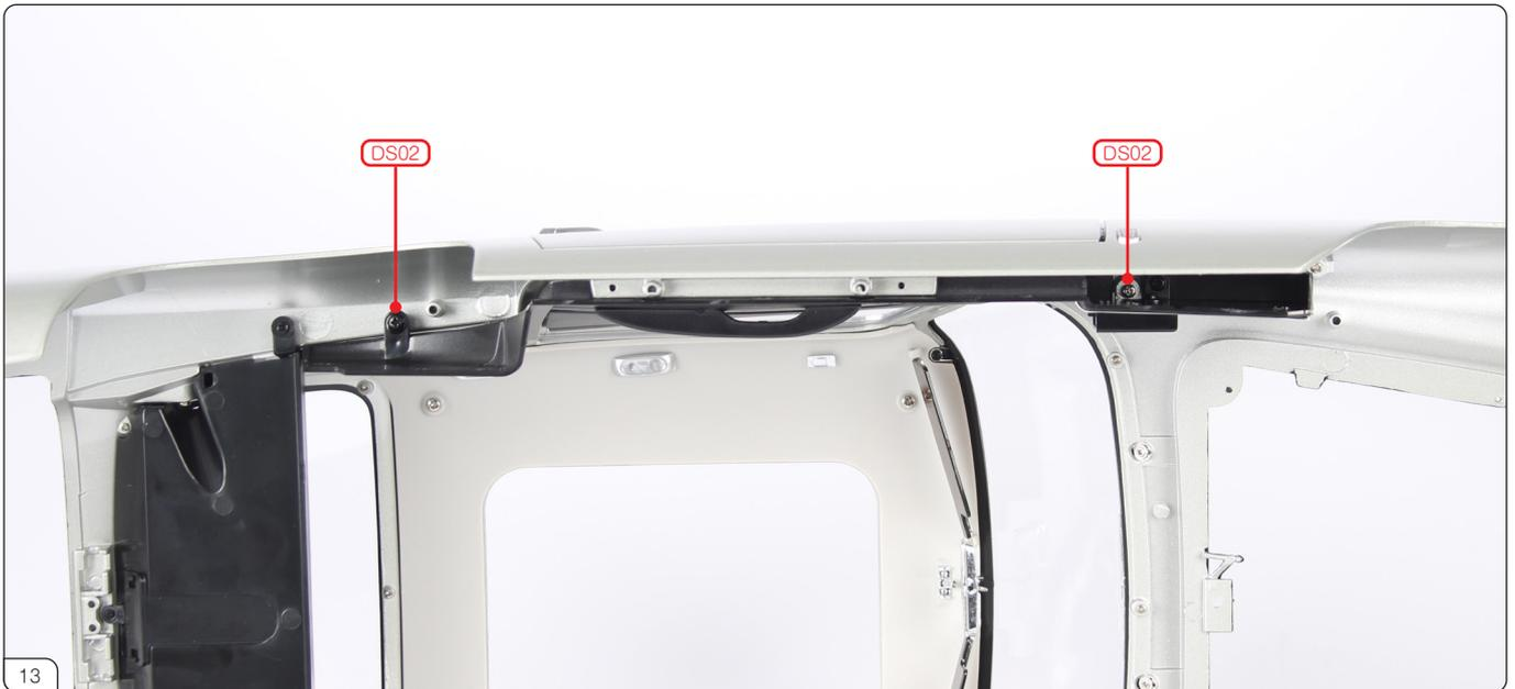
DS02ネジ2本で右ボディインサイドパネル(83-A)を固定します。
