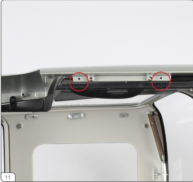
右ボディインサイドパネル(83-A)をドアシルの下に押し込みます。パネルの2本の突起を、ドアシルの穴(赤丸印)にはめ込みます。
