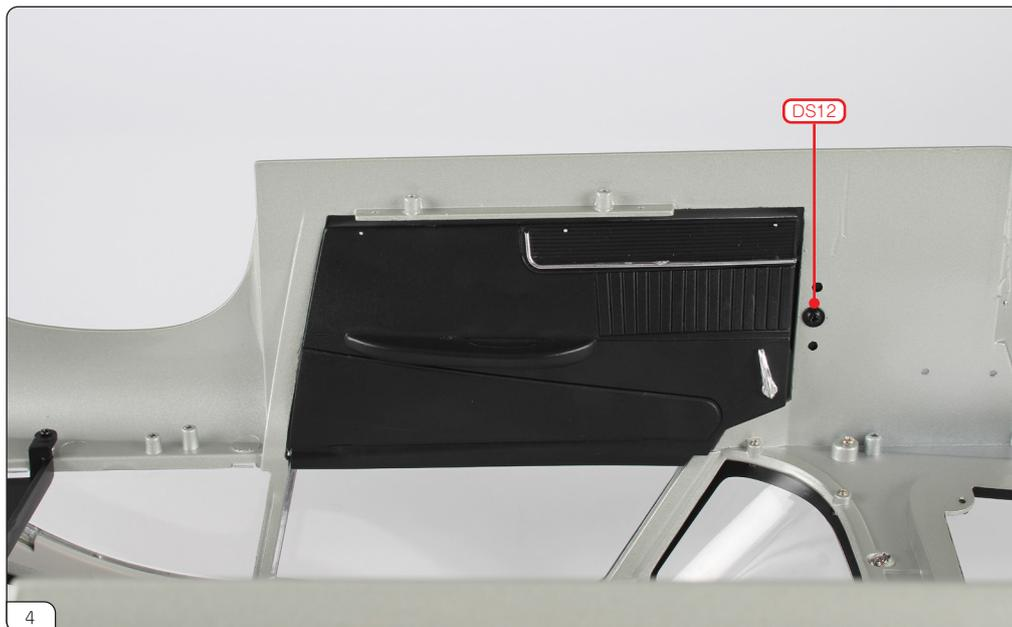
内側からDS12ネジで右ドアを固定します。固定後、ドアがスムーズに開閉することを確認してください。ドアがぐらつく場合は、ネジがしっかり締まっているか確認しましょう。
