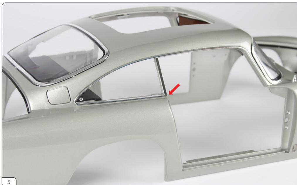
トリムを固定します。必要に応じて、右リアウインドウトリム(81-B)の角にPVA系の接着剤を少量塗布します(赤矢印)。
