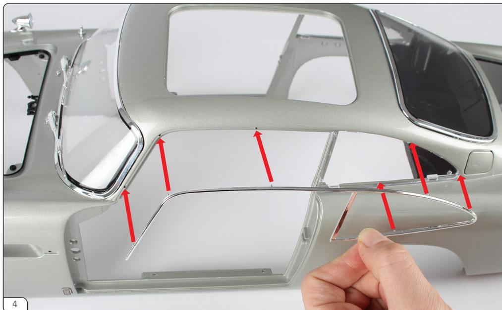
画像のように、左リアウインドウトリム(82-B)の突起を合わせます(赤矢印)。6カ所の突起にはPVA(ポリビニルアルコール)系の接着剤を少量塗布してください(画像4a参照)。
