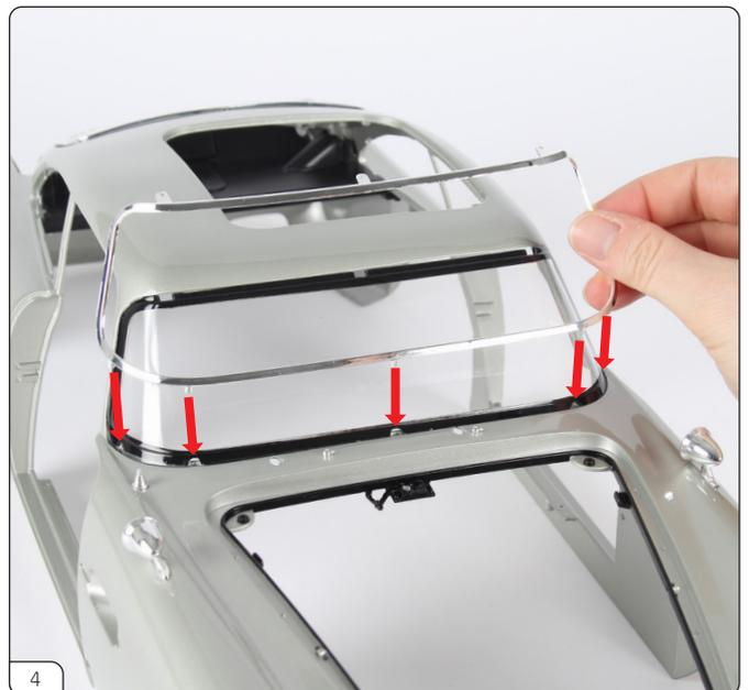
フロントウィンドウトリム(78-A)の下端の突起を、フロントウィンドウの5つの穴に合わせてください(赤矢印)。
