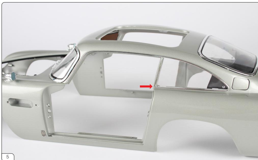
トリムを固定します。必要に応じて、左リアウインドウトリム(82-B)の角にPVA系の接着剤を少量塗布します(赤矢印)。
