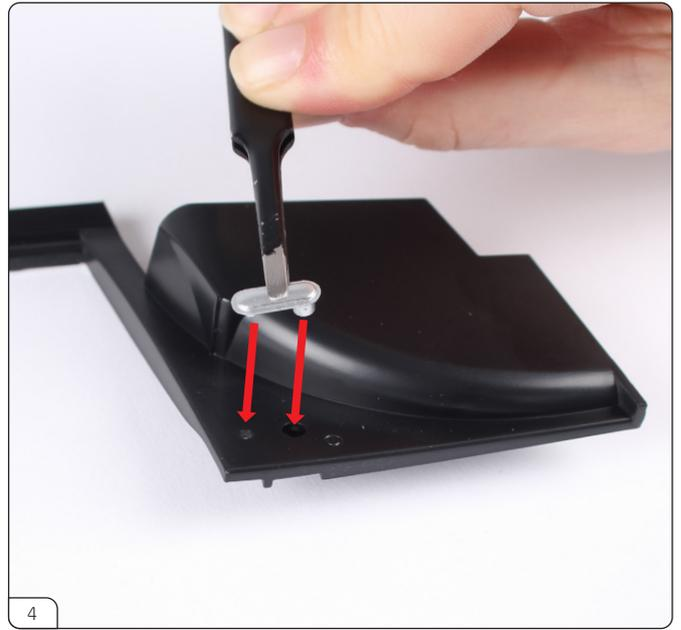
画像のように、灰皿(84-D)をパネルに合わせて押し込みます。
