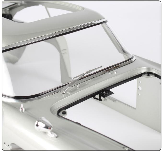
Drücken Sie den rechten Scheibenwischer (gekennzeichnet mit 'R') in das geformte Loch, wie gezeigt.
