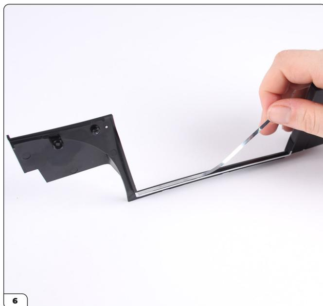
Entfernen Sie den Aufkleber für die Türschwellerverkleidung (83-E) von der Trägerfolie und kleben Sie ihn wie abgebildet auf.
