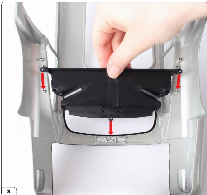
Platzieren Sie vorsichtig die Hauptkörperbaugruppe auf den Kopf auf Ihrer Arbeitsfläche (denken Sie daran, eine weiche Oberfläche zu verwenden, um die Farbe zu schützen). Richten Sie das hintere Deck an den Schraubenlöchern aus, die sich in der Nähe des Heckscheiben befinden.
