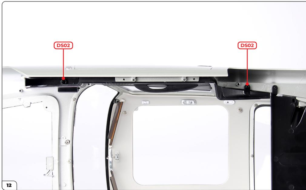
Befestigen Sie die Platte mit 2x DS02 Schrauben.
