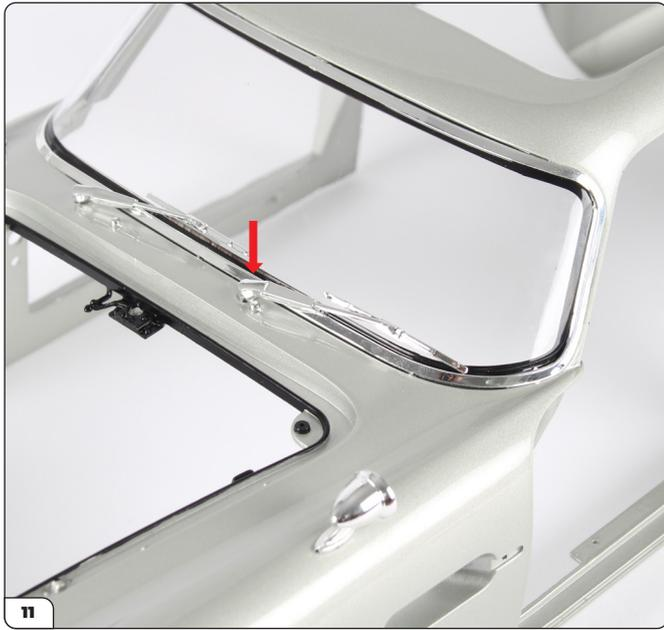
Führen Sie den linken Scheibenwischer in das geformte Loch ein.
