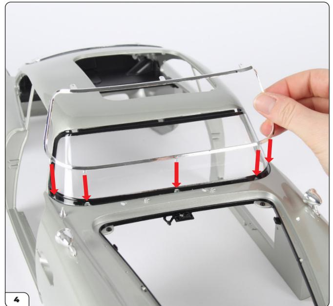
Richten Sie die Windschutzscheibenverkleidung (78-A) auf die gleiche Weise aus und drücken Sie die Stifte in die fünf Löcher entlang der unteren Kante.
