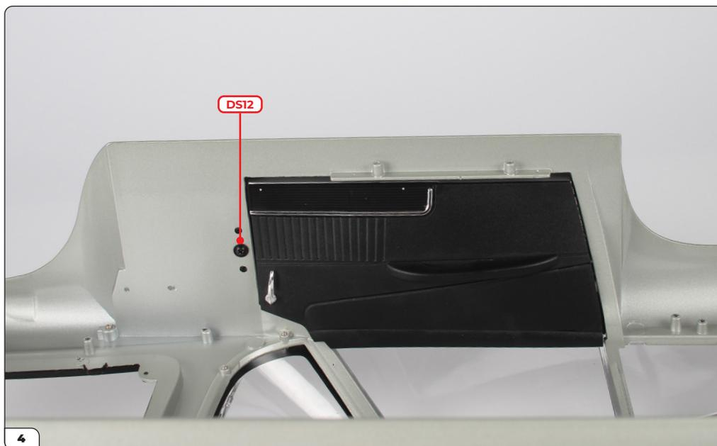
Befestigen Sie die Tür mit der DS12 Schraube. Stellen Sie sicher, dass die Schraube vollständig angezogen ist.
