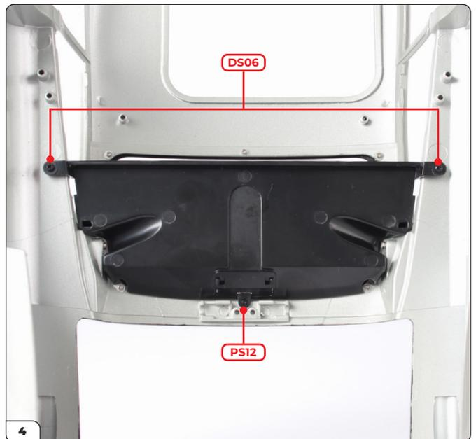
Befestigen Sie das hintere Deck mit 2x DS06 Schrauben an den Seiten und 1x PS12 Schraube in der Mitte.
