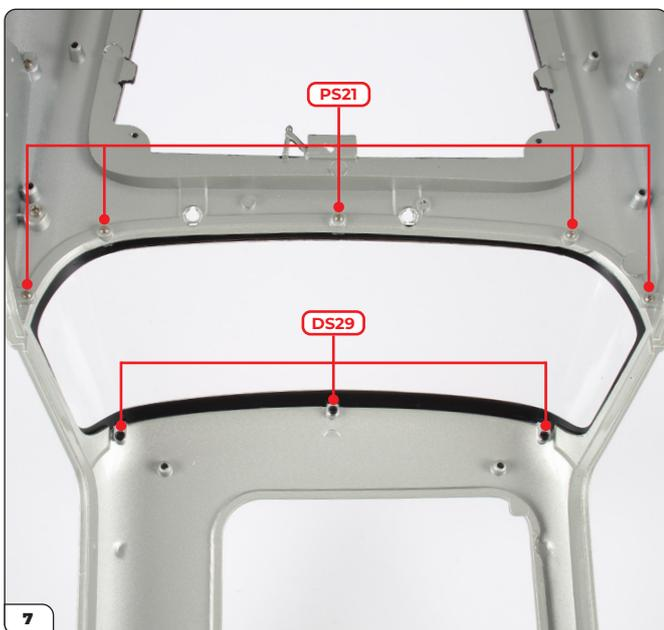
Befestigen Sie die Windschutzscheibe und die Verkleidung von der anderen Seite mit 5x PS21 und 3x DS29 Schrauben, wie gezeigt.
