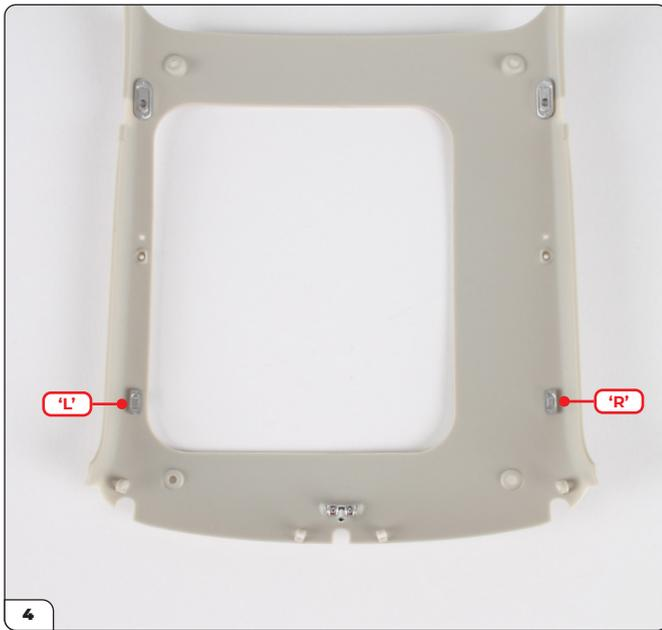
Drücken Sie die linken (79-C) und rechten (79-E) vorderen Haken, die ebenfalls mit 'L' und 'R' gekennzeichnet sind, auf die gleiche Weise in Position.
