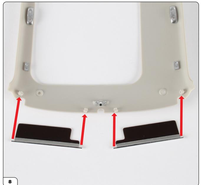
Richten Sie die linke (80-A) und die rechte (80-B) Sonnenblende wie abgebildet am Dachhimmel aus. Die Teile sind nicht gekennzeichnet, verwenden Sie daher ihre Form und Ausrichtung, um sie richtig auszurichten.
