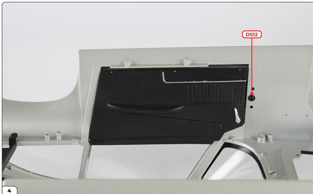
Befestigen Sie die Tür mit der DS12 Schraube. Überprüfen Sie, ob sich die Tür reibungslos öffnet - wenn die Tür wackelt, stellen Sie sicher, dass die Schraube, die die Halterung hält, fest angezogen ist.
