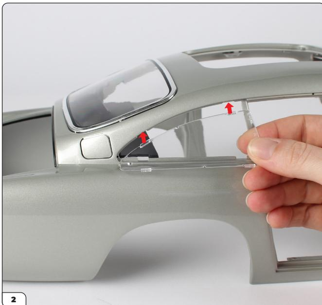
Positionieren Sie die beiden Laschen entlang des oberen Randes des Fensters in die Vertiefungen an der rechten Seite des Hauptkörpers.
