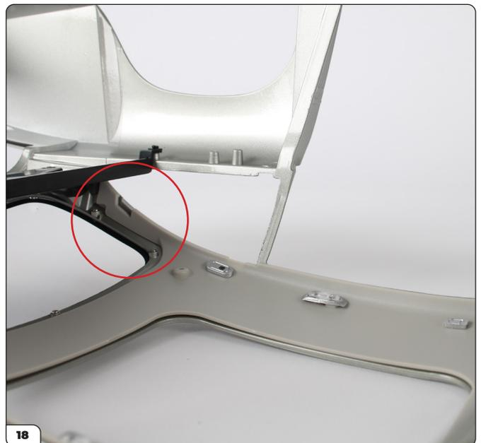
Prüfen Sie, ob die Enden des Dachhimmels korrekt unter dem hinteren Deck angebracht sind.
