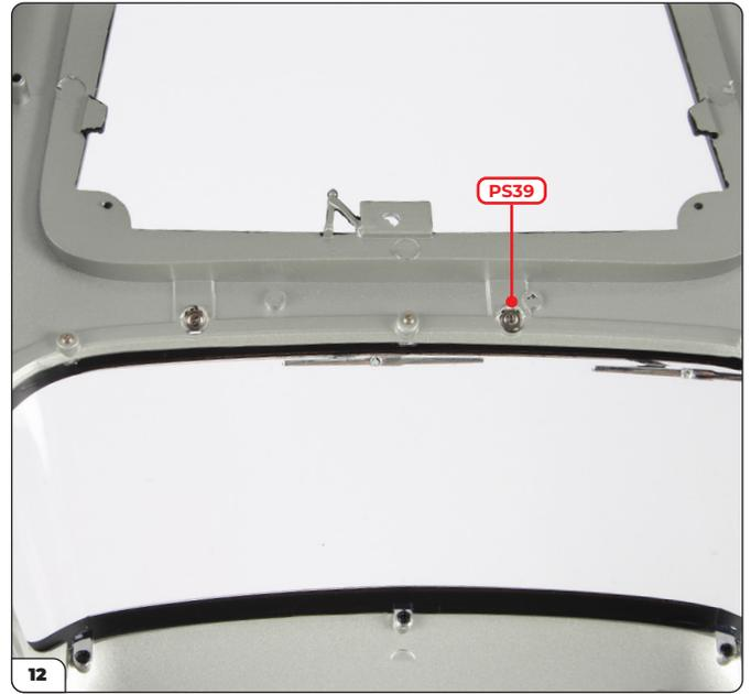
Befestigen Sie es mit einer PS39 Schraube.
