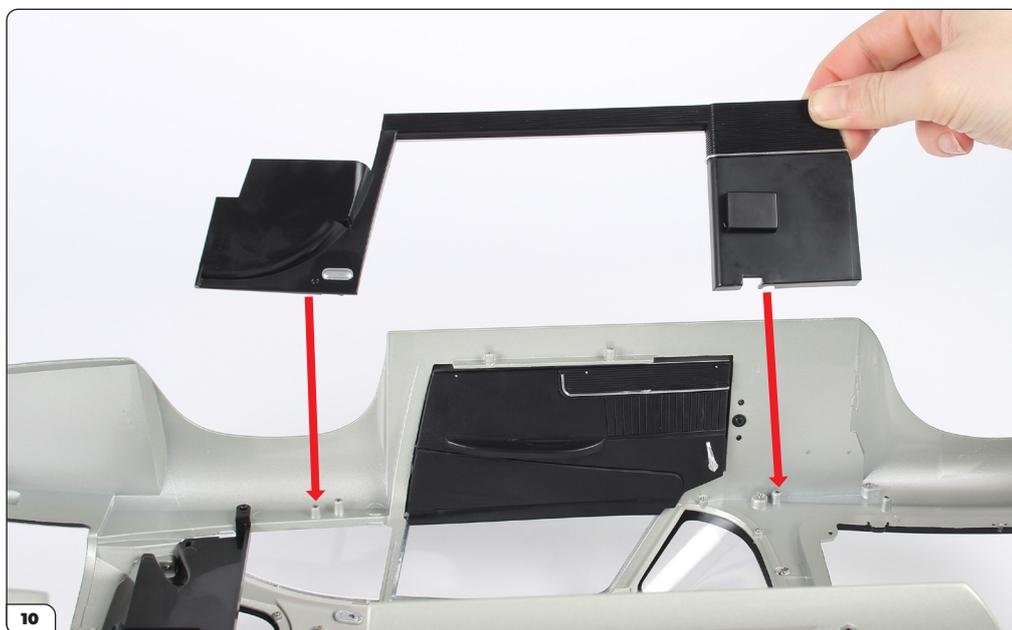
Legen Sie die Hauptbaugruppe vorsichtig auf den Kopf auf Ihrer Arbeitsfläche. Richten Sie die Platte wie abgebildet mit der Hauptbaugruppe aus, und positionieren Sie die Platte dann über den Schraubenpfosten.
