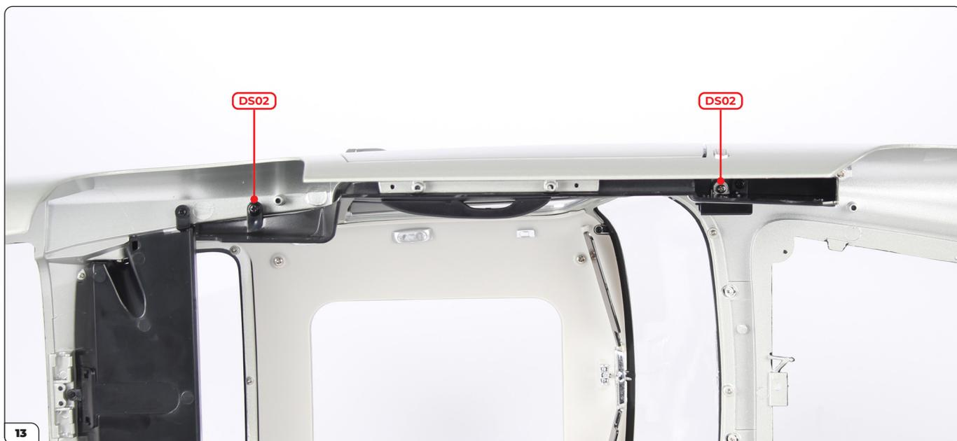
Befestigen Sie die Platte mit 2x DS02 Schrauben.
