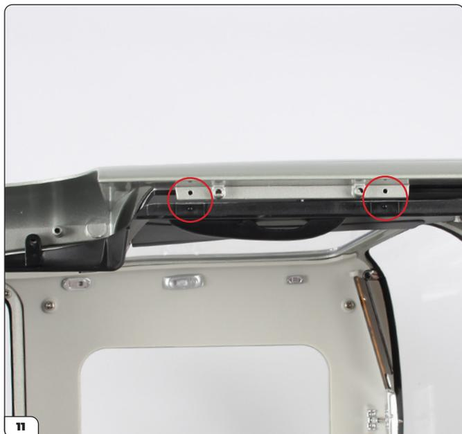
Drücken Sie die Platte unter die Türschwelle. An der Platte befinden sich zwei Stifte, die in die Löcher an der Türschwelle passen (kreisförmig markiert).
