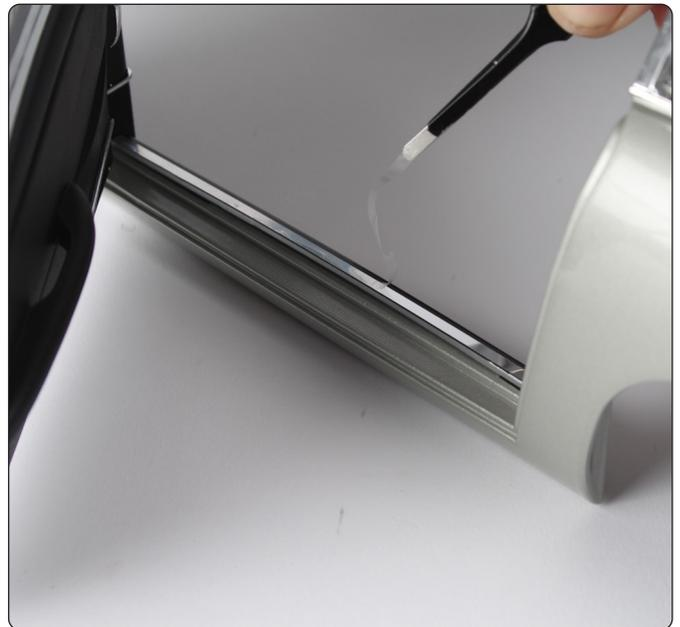
Sobald die Türen und Innenplatten korrekt montiert sind, entfernen Sie das durchsichtige Schutzband von beiden Aufklebern der linken und rechten Türschwelle.
