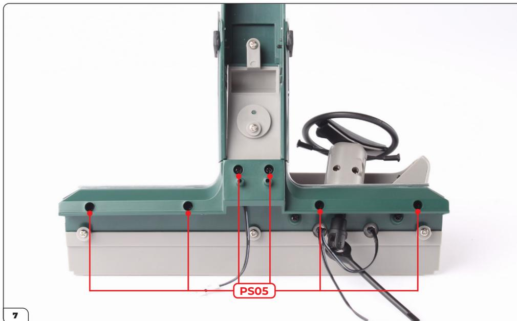
Drücken Sie das untere Paneel fest an seinen Platz und sichern Sie die Teile mit 6 PS05 Schrauben. Wenn Lücken zwischen den Armaturenbrettteilen bestehen, können Sie versuchen, die Schraubenpfosten mit einer Nagelfeile zu kürzen.
