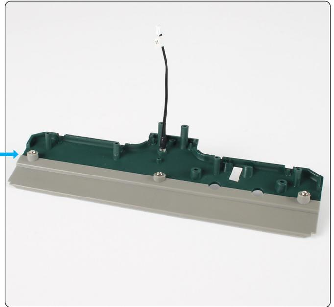
Nehmen Sie das Radar-LED-Kabel Nr. 11 (37-E) und drücken Sie die Birne in das Loch.
