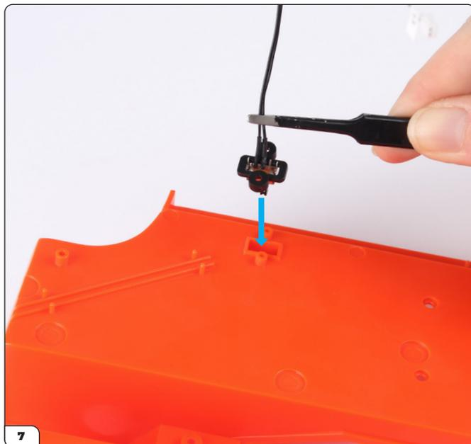
Bewegen Sie die Halterung entlang des Kabels bis zum Schalter und drücken Sie den Schalter in die rechteckige Öffnung an der Unterseite des Cockpitbodens.
