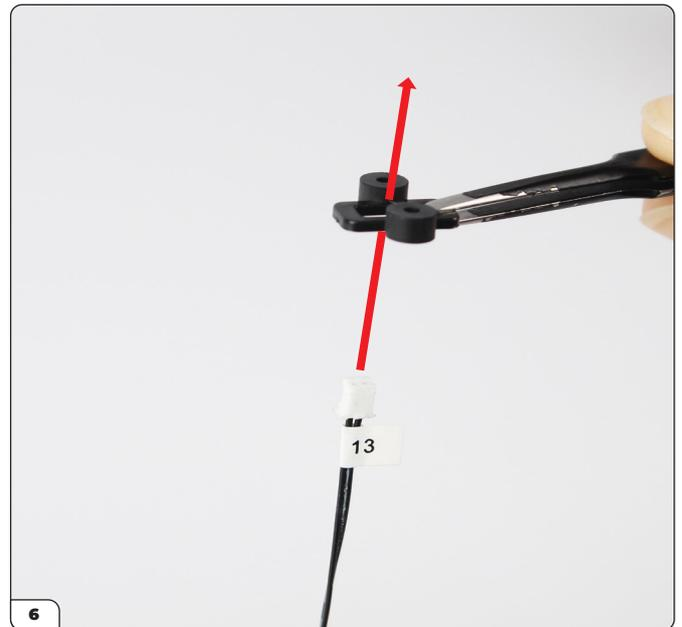
Stecken Sie den Stecker des Ein-/Ausshalter-Kabels Nr. 13 (42-F) durch die Halterung (42-E). Achten Sie darauf, dass die Halterung wie gezeigt ausgerichtet ist.
