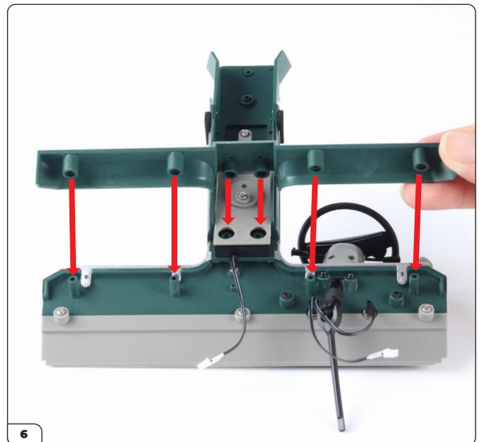
Positionieren Sie die Mittelkonsole über den beiden mittleren Schraubenpfosten und richten Sie das untere Armaturenbrett-Panel wie gezeigt aus.
