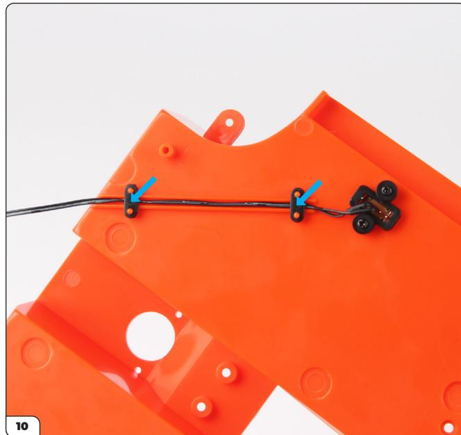
Sichern Sie die Kabel, indem Sie die beiden Kabelhalterungen (42-D) an ihren Platz drücken.
