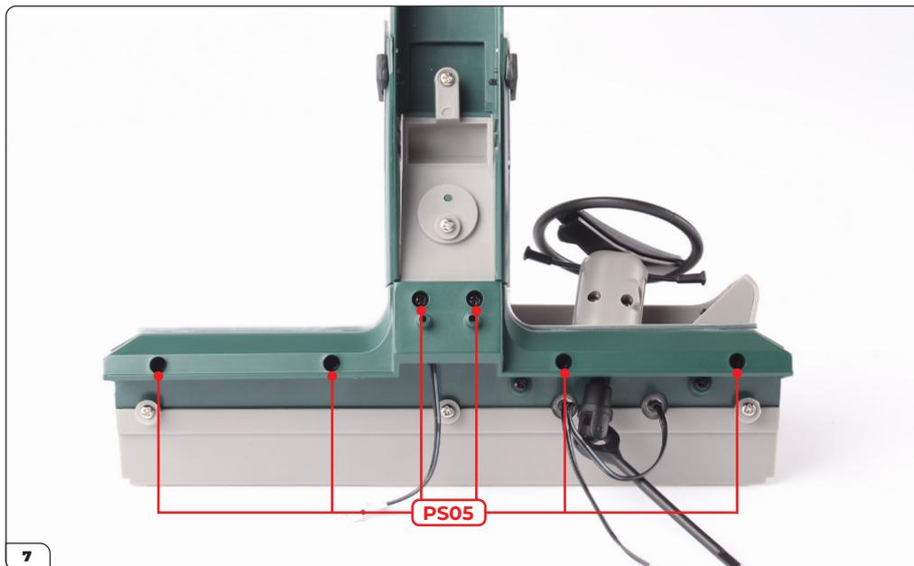
Premi fermamente il pannello inferiore al suo posto, poi fissate le parti con 6 viti PS05. Se ci sono degli spazi tra le parti del cruscotto, puoi provare a tagliare i perni delle viti con una lima per unghie.
