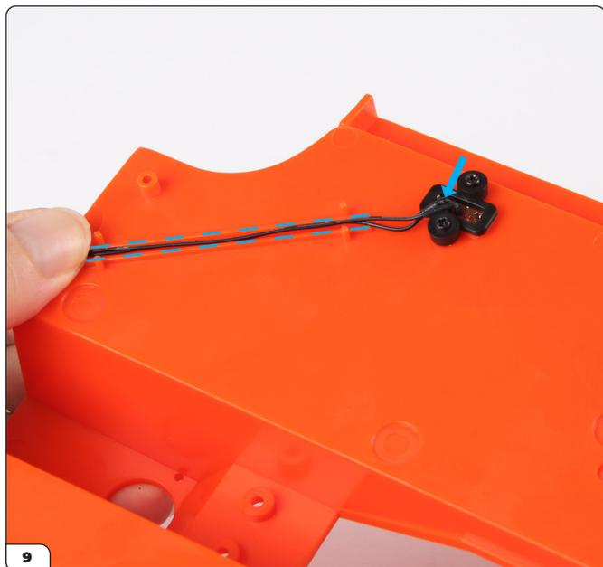
Piega con cura i cavi (freccia) e poi mettili nel canale (linee tratteggiate).
