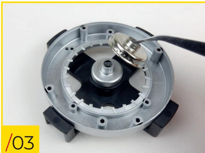
31/03 Platzieren Sie den Nabe Typ B auf den zentralen Bolzen der Vorrichtung; sobald diese positioniert ist, platzieren Sie den Nabe Typ A darüber, wie auf dem Foto gezeigt.
