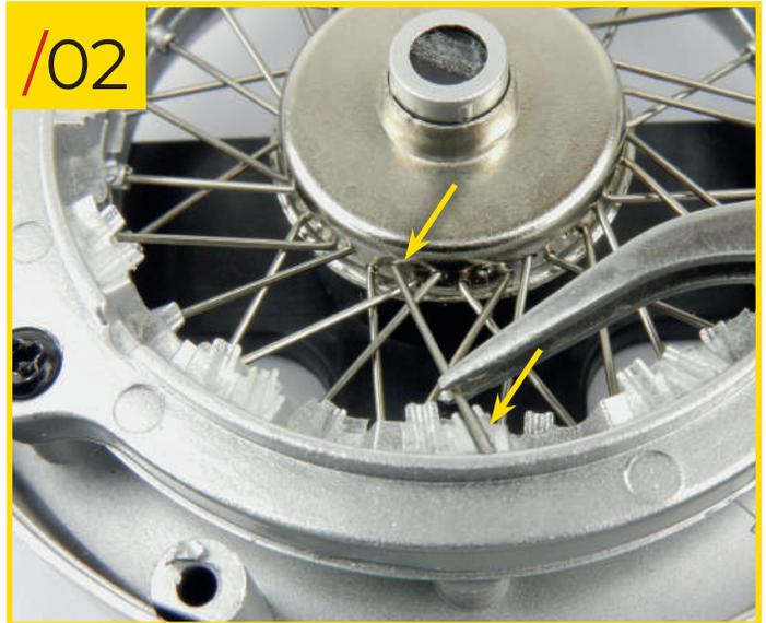
33/02 Führen Sie das gehakte Ende der Speichen Typ A, die Sie mit dieser Stufe erhalten haben, in die verbleibenden Löcher in der Nabe Typ A ein. Nutzen Sie das Foto, um die Speichen richtig auszurichten. Legen Sie ihr gerades Ende auf die entsprechende Kerbe auf der obersten Ebene des Gehäuses.
