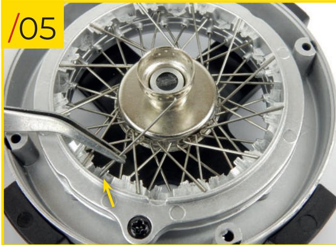
33/05 Nutzen Sie das Foto, um das gerade Ende der Speiche in die Kerbe auf der unteren Ebene des Gehäuses zu legen. Wiederholen Sie diese Schritte für die elf anderen Speichen Typ C, bis alle Löcher in der unteren Reihe der Nabe gefüllt sind.
