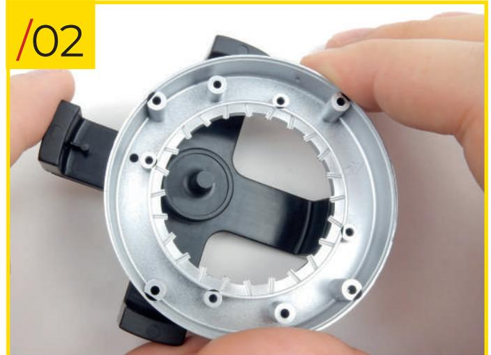
31/02 Führen Sie den Stift in das Loch ein, um die Felge an der Vorrichtung zu befestigen. Bevor Sie mit der Montage fortfahren, empfehlen wir, ein kleines Stück doppelseitiges Klebeband auf den zentralen Bolzen der Vorlage zu kleben - dies hilft, die Naben an Ort und Stelle zu halten. Alternativ können Sie alle Speichen in Position legen und dann nach Phase 31/08 auf jede einen Klebetropfen auftragen.
