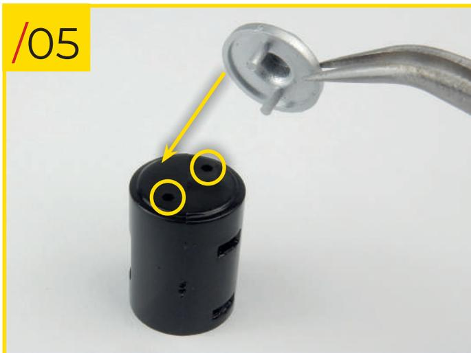
40/05 Fügen Sie die Basis zum Gehäuse des Dynamos hinzu.
