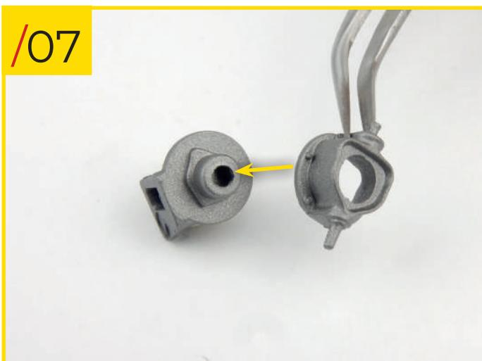
39/07 Montieren Sie den zentralen Teil der Kraftstoffpumpe an den unteren Teil und orientieren Sie die Teile wie dargestellt.
