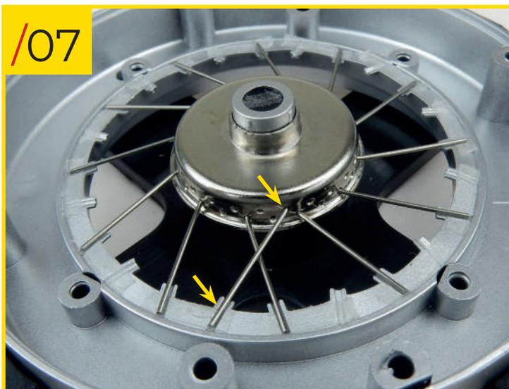
**31/07** Installieren Sie nun die Speichen Typ A (sie sind länger als die Typ B) indem Sie ihr gehaktes Ende in die obere Reihe von Löchern sofort links von den Typ B Speichen einsetzen, und sicherstellen, dass sie über die in die untere Reihe von Löchern eingesetzten Speichen gehen. Nutzen Sie das Foto, um zu erkennen, in welche Kerbe Sie das andere Ende der Speiche einsetzen sollten. Lassen Sie immer ein leeres Loch zwischen jeder Speiche.
