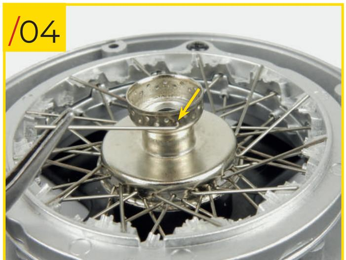
33/04 Führen Sie das gehakte Ende einer Speiche Typ C in eines der Löcher in der unteren Reihe der Nabe Typ C ein.
