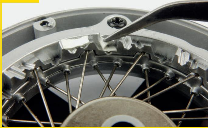
33/01 Legen Sie das rechte Vorderrad, das Sie in den vorherigen Phasen montiert haben, auf Ihre Arbeitsfläche. Bevor Sie mit der Montage fortfahren, empfehlen wir, kleine Streifen doppelseitiges Klebeband an den seitlichen Rand des Speichengehäuses 2 zu kleben.
