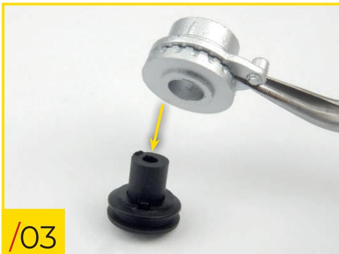
40/03 Stecken Sie den Bolzen der Riemenscheibe in das Loch des Trägers, um die beiden Teile zusammenzufügen.
