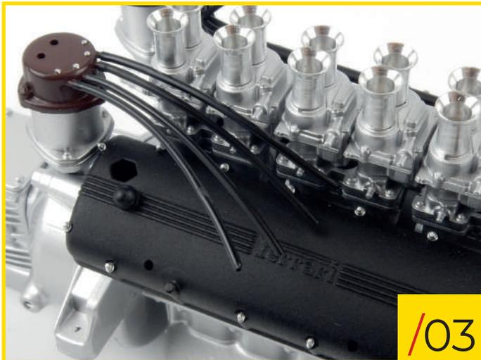
37/03 Holen Sie die Motoreinheit und schieben Sie die anderen vier langen Kabel (Phase 36) auf die Stifte der rechten Verteilerkappe.
