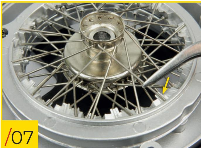
33/07 Legen Sie das gerade Ende der Speiche auf die entsprechende Kerbe auf der obersten Ebene des Gehäuses. Wiederholen Sie diese Schritte für die anderen elf Speichen Typ C, bis alle Löcher in der oberen Reihe auf der Nabe gefüllt sind.
