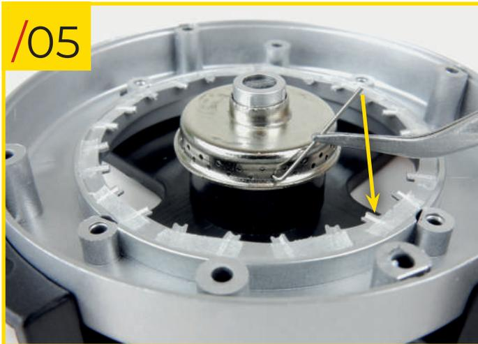
**31/05** Montieren Sie die Speichen Typ B (sie sind kürzer als die Typ A) indem Sie ihr gehaktes Ende in die untere Reihe von Löchern in der Nabe Typ A einsetzen. Legen Sie das gerade Ende der Speichen in die entsprechende Kerbe am Rand der Felge (auf dem doppelseitigen Klebeband). Lassen Sie immer ein leeres Loch zwischen jeder Speiche.
