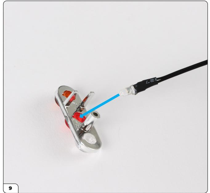
Von der anderen Seite, drücken Sie das LED-Bremslicht (86-G) in das Bremslicht.
