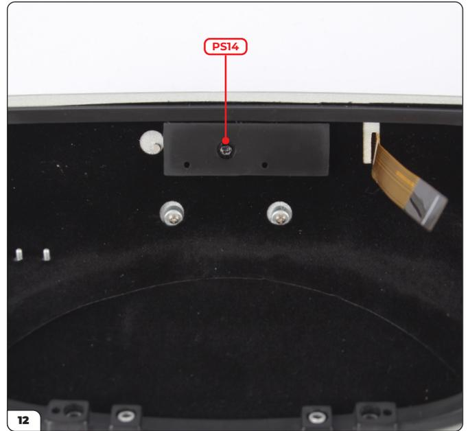
Befestigen Sie die Halterung für die Schaltplatine und das Nummernschild mit einer PS14-Schraube.
