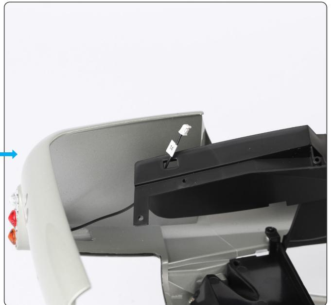
Legen Sie den Hauptkörper auf den Kopf auf Ihre Arbeitsfläche. Nehmen Sie den hinteren rechten Radkasten (87-A) und führen Sie den Stecker des Kabels (Nr. 14) durch das rechteckige Loch im Radkasten.
