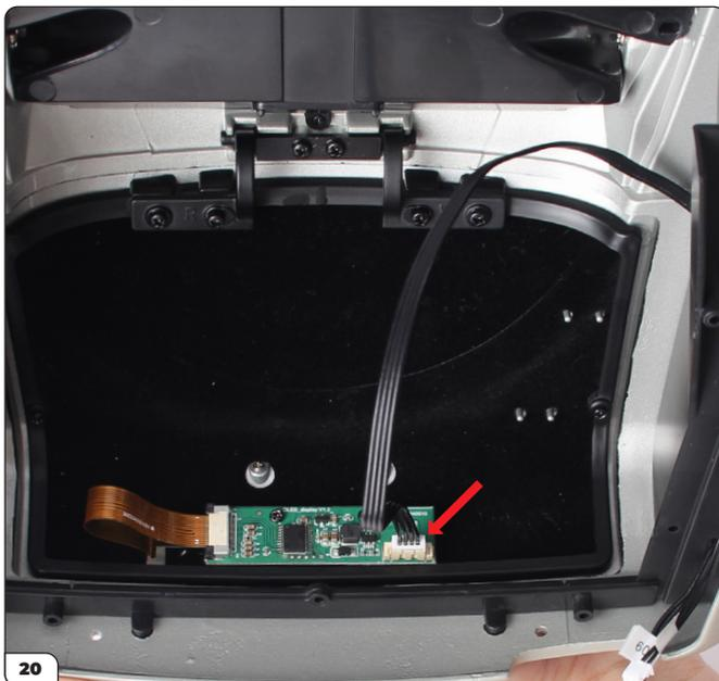
Stecken Sie das Kabel für das hintere Nummernschild (Nr. 09) in die Schaltplatine.
