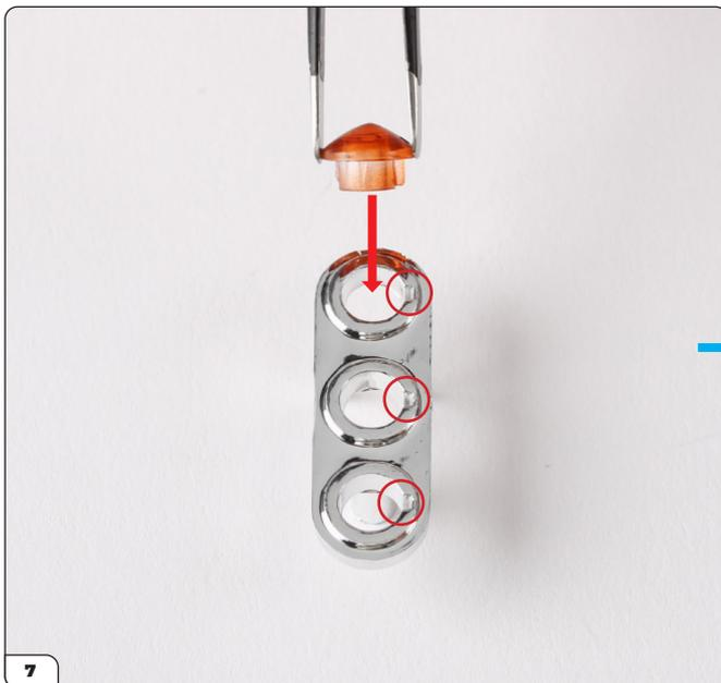
Richten Sie die Zierleiste mit den Befestigungselementen auf der rechten Seite (gekreist) aus. Drücken Sie das orange Blinkerlicht (86-F) in das obere Loch.
