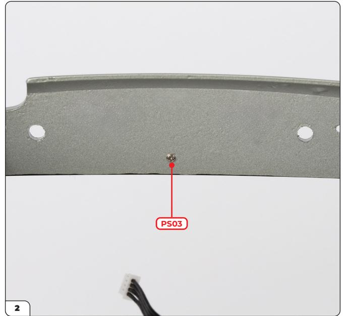
Sichern Sie den Verschluss mit einer PS03-Schraube.
