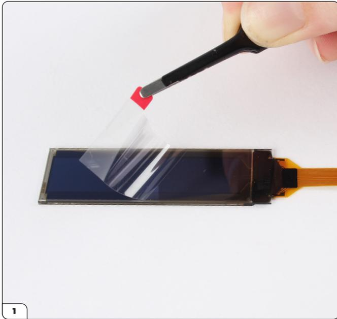
Nehmen Sie den Bildschirm für das hintere Nummernschild (92-E) und ziehen Sie die Schutzfolie ab.
