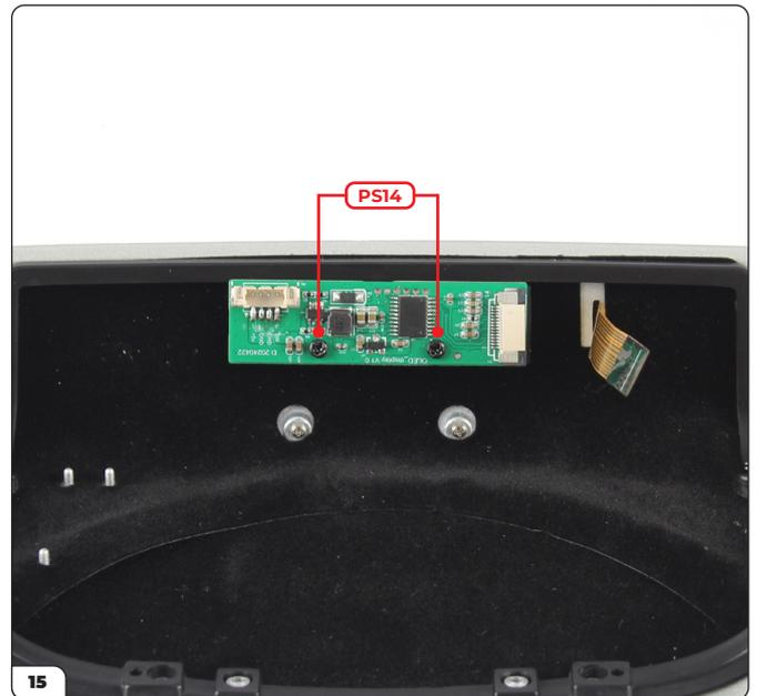
Positionieren Sie die Schaltplatine über den beiden Schraubenlöchern und befestigen Sie sie mit 2x PS14-Schrauben.
