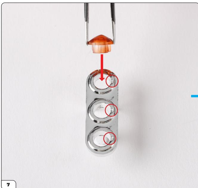
Richten Sie die Zierleiste mit den Befestigungselementen auf der rechten Seite (gekreist) aus. Drücken Sie das orange Blinkerlicht (85-F) in das obere Loch.
