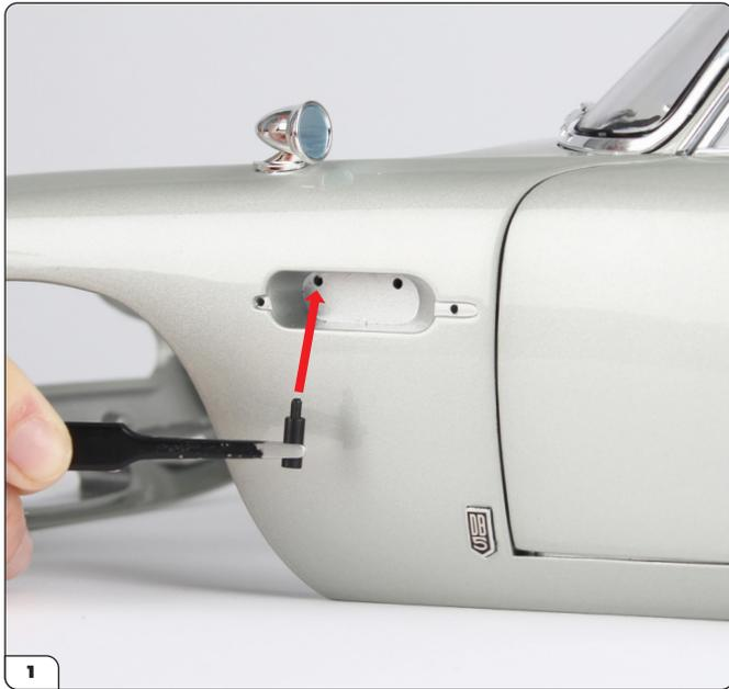
Platzieren Sie die Hauptkarosserie auf Ihrer Arbeitsfläche (verwenden Sie eine weiche Unterlage, um den Lack zu schützen) mit der linken Lüftungsöffnung zu Ihnen, und nehmen Sie dann eine der Auswurföffnungen des Gehäuses (85-B).
