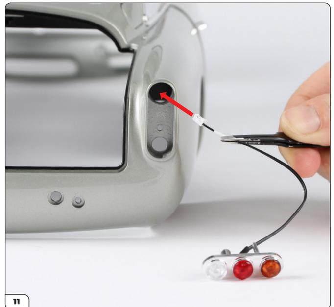
Führen Sie den Stecker durch das obere Loch in der hinteren rechten Aussparung am Hauptkörper.
