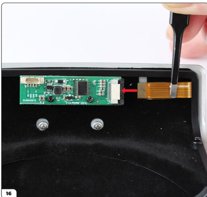
Schieben Sie das Flachbandkabel in die entriegelte Steckdose.
