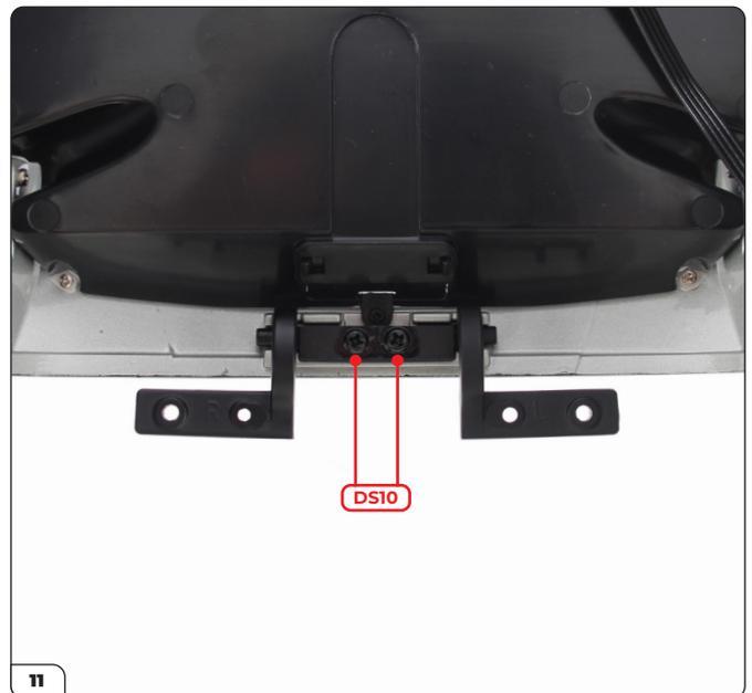
Befestigen Sie die Halterung mit 2x DS10-Schrauben. Stellen Sie sicher, dass die Schrauben vollständig festgezogen sind und sich die Scharniere in der gezeigten Position befinden.
