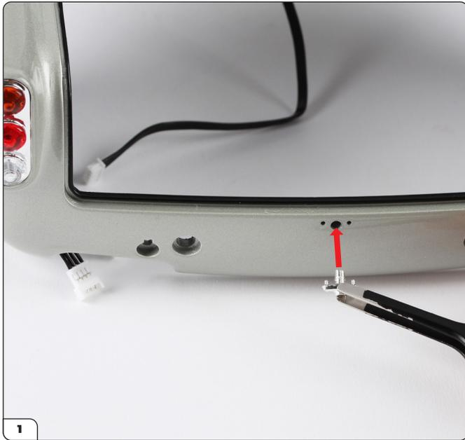
Legen Sie die Hauptkarosserie auf Ihre Arbeitsfläche. Drücken Sie den Kofferraumverschluss (89-G) in die drei Löcher. Der Verschluss kann nur in einer Ausrichtung passen.
