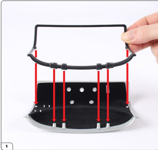
Richten Sie den Kofferraumdeckelrahmen (91-A) mit dem Kofferraumdeckel (Phase 090) aus.
