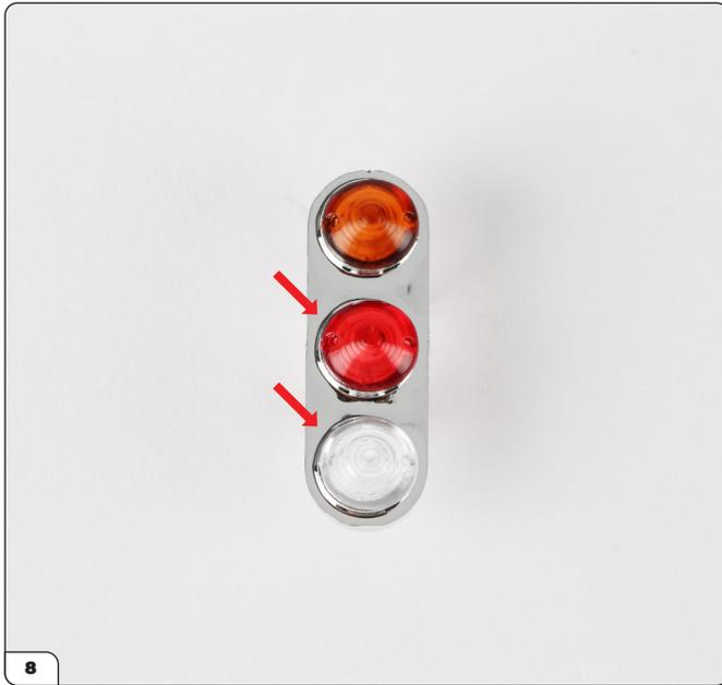
Drücken Sie das rote Bremslicht (86-E) in das mittlere Loch und das transparente Rückfahrlicht (86-D) in das untere Loch.
