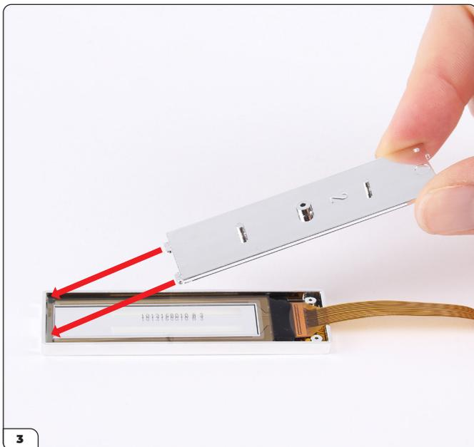
Setzen Sie den Bildschirm in den Rahmen ein und richten Sie die Rückseite des Rahmens (92-B) mit der Montage aus.
