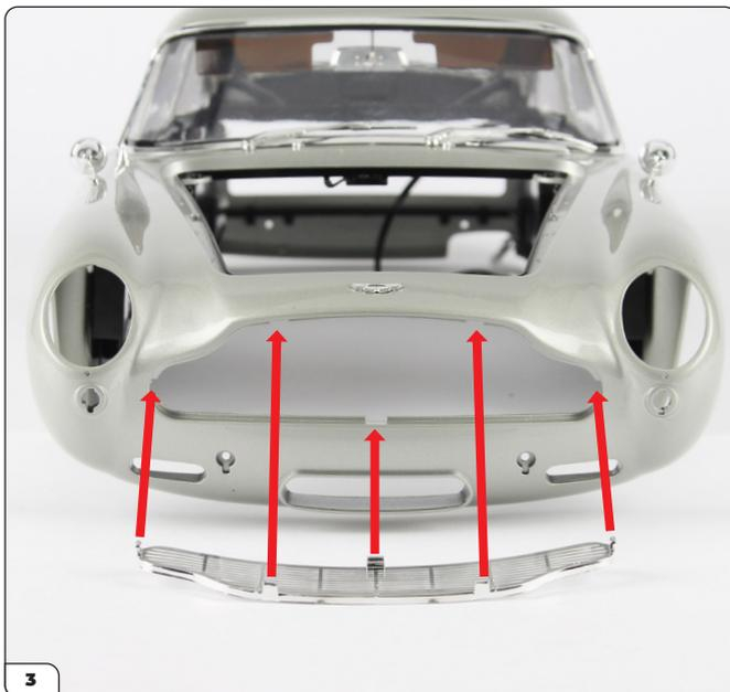
Der Frontgrill (91-B) passt mit fünf Clips (Pfeile) in die Vorderseite des Hauptkörpers.
