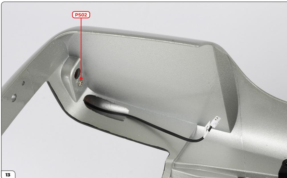
Befestigen Sie es von innen an der Hauptkarosserie mit einer PS02-Schraube.
