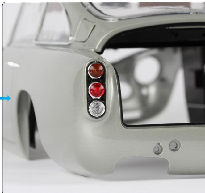
Drücken Sie die Zierleiste des Rücklichts in die Aussparung und richten Sie sie mit dem orangefarbenen Blinker nach oben aus. Wenn beim Einbau das Kabel das Bremslicht herausdrückt, versuchen Sie, transparenten Kleber zu verwenden, um das Bremslicht an Ort und Stelle zu halten.
