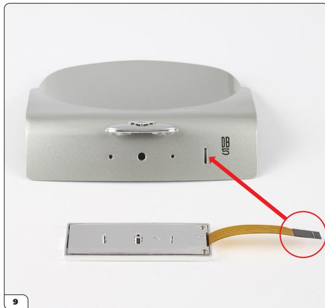
Bevor Sie das hintere Nummernschild anbringen, führen Sie das Flachbandkabel durch den Schlitz im Kofferraumdeckel.
