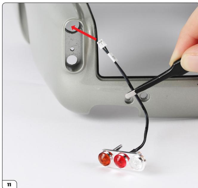
11 Führen Sie den Stecker durch das obere Loch in der hinteren linken Aussparung am Hauptkörper.
