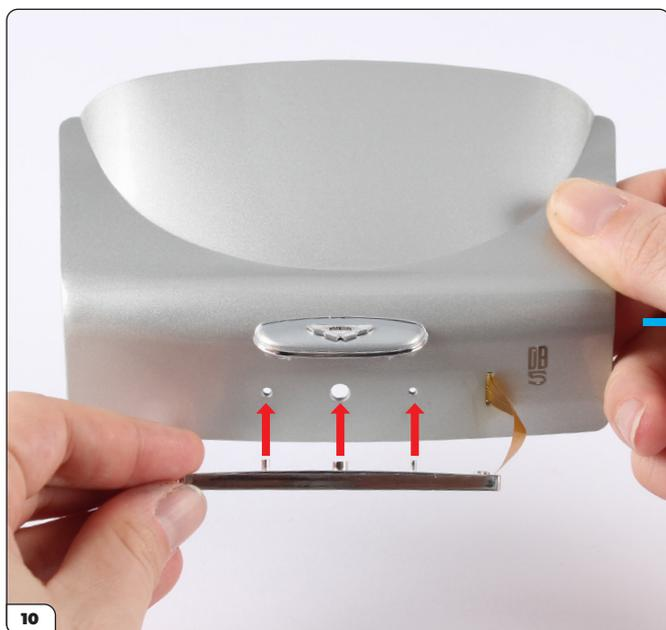
Richten Sie das hintere Nummernschild mit dem Kofferraumdeckel aus und drücken Sie es an seinen Platz, während Sie gleichzeitig das Flachbandkabel durchführen. Stellen Sie sicher, dass die Stifte und der Schraubenpfosten vollständig in die Löcher für den nächsten Schritt eingeführt sind.
