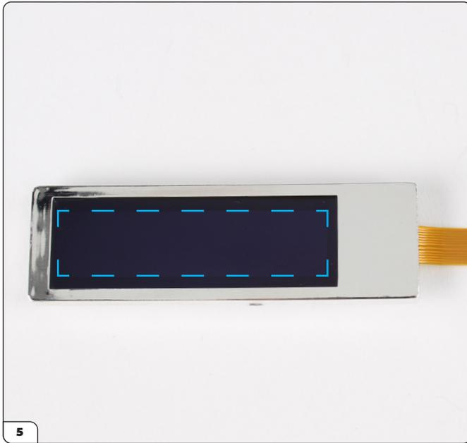
Drehen Sie das Nummernschild um und überprüfen Sie, ob der Bildschirm zentriert ist (gestrichelte Linie). Passen Sie die Position bei Bedarf vorsichtig an, indem Sie den Bildschirm verschieben.
