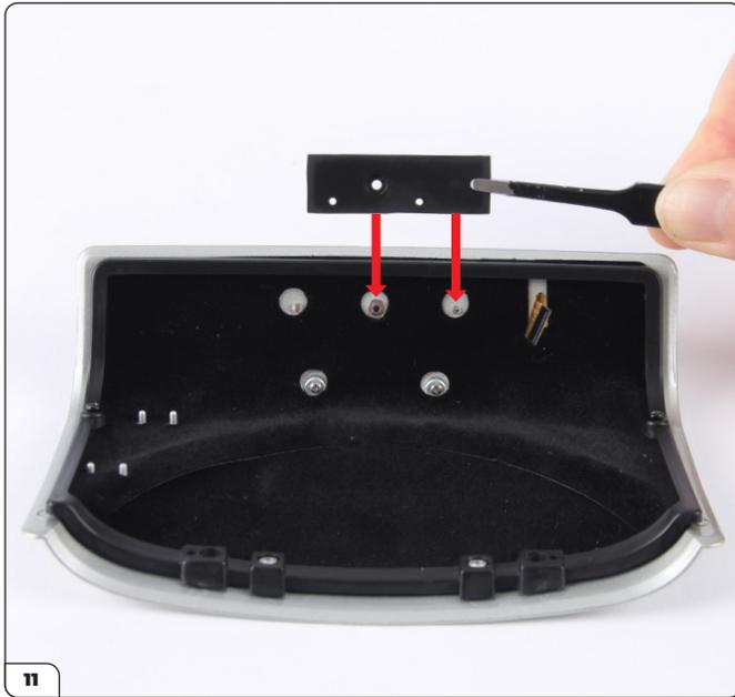
Richten Sie die Halterung für die Schaltplatine (92-D) mit der Innenseite des Kofferraumdeckels aus. Drücken Sie sie auf den Schraubenpfosten und den Stift, wie durch die Pfeile gezeigt.
