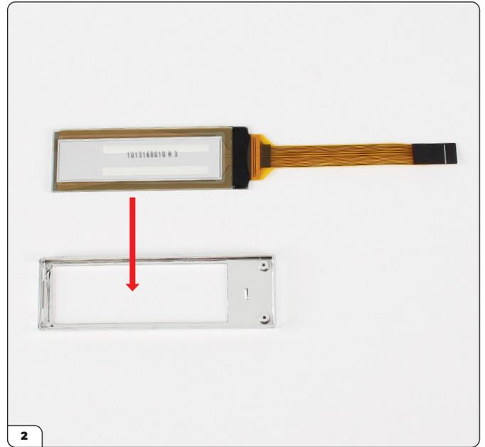
Richten Sie den Bildschirm mit der Vorderseite des Rahmens für das hintere Nummernschild (92-A) aus, wie gezeigt.
