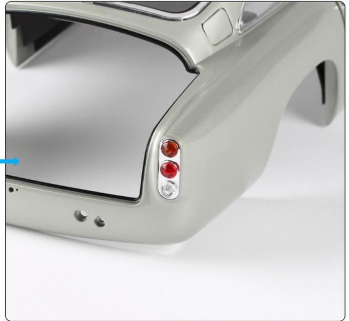
Drücken Sie die Zierleiste des Rücklichts in die Aussparung und richten Sie sie mit dem orangefarbenen Blinker nach oben aus. Wenn beim Einbau das Kabel das Bremslicht herausdrückt, versuchen Sie, transparenten Kleber zu verwenden, um das Bremslicht an Ort und Stelle zu halten.
