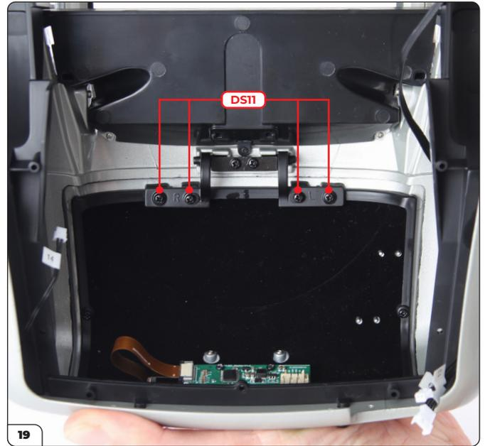
Positionieren Sie den Kofferraumdeckel am Körper und befestigen Sie den Kofferraumdeckel mit 4x DS11-Schrauben an den Scharnieren.
