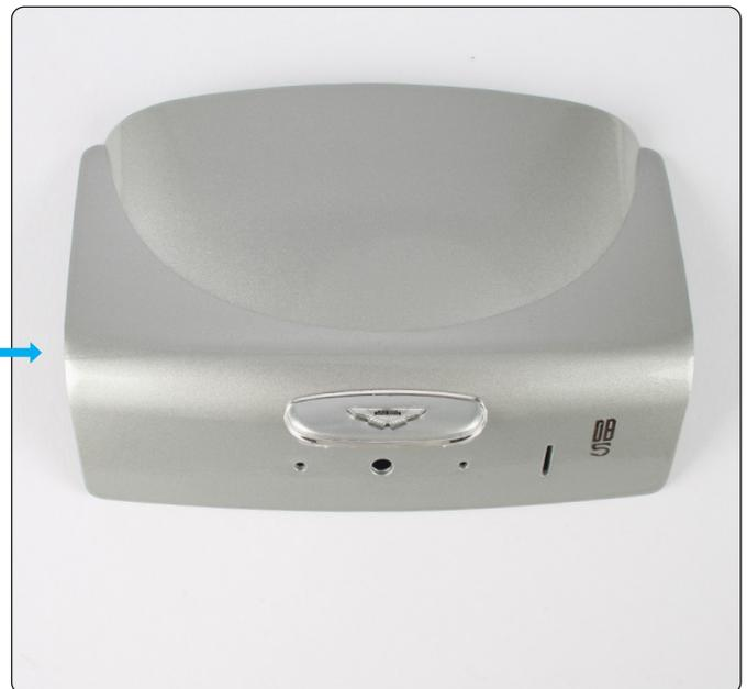
Nehmen Sie die Montage des Rücklichts für das Nummernschild (Phase 089) und drücken Sie sie in die beiden oberen Löcher des Kofferraumdeckels (Phase 091).
