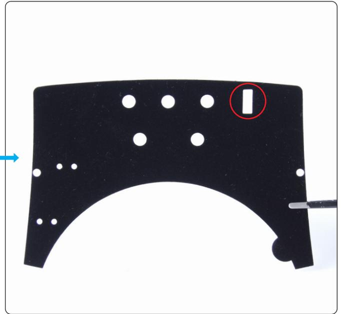
Nehmen Sie Kofferraumdeckelteppich 1 (90-B) und entfernen Sie die ausgeschnittenen Bereiche wie gezeigt. Wenn Sie die nicht-LED-Kennzeichen verwenden, müssen Sie den rechteckigen Bereich (eingekreist) nicht entfernen.
