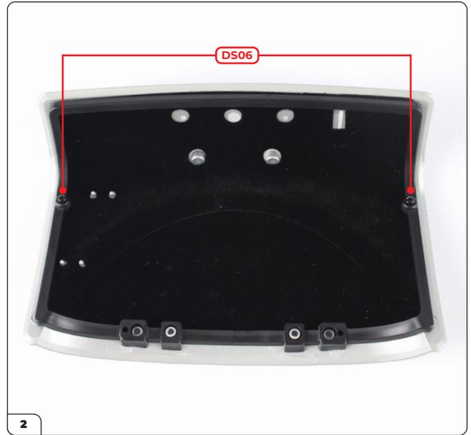
Passen Sie den Kofferraumdeckelrahmen an und befestigen Sie ihn mit 2x DS06-Schrauben.
