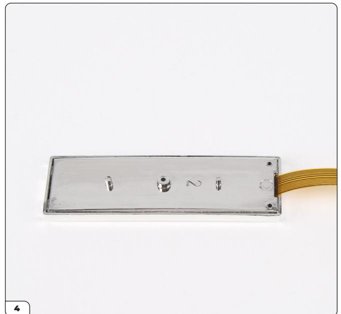
Bringen Sie die Rückseite an. Sie müssen möglicherweise die Position des Bildschirms leicht anpassen, damit die Vorder- und Rückseite zusammenpassen.
