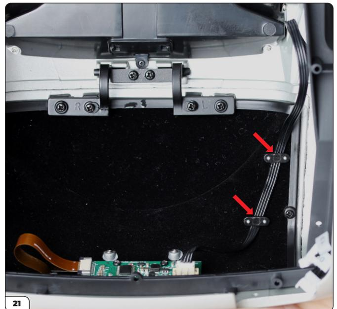
Befestigen Sie das Kabel mit den beiden Kabelhaltern (92-F) am Teppich des Kofferraumdeckels, wie gezeigt.
