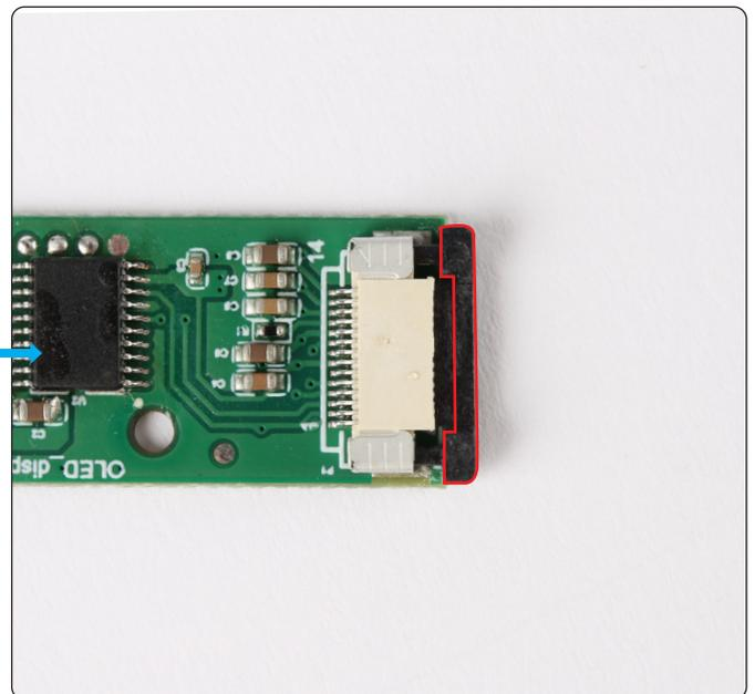
Nehmen Sie die Schaltplatine (92-C) und entriegeln Sie die Steckdose, indem Sie den schwarzen Bereich wie gezeigt herausziehen.
