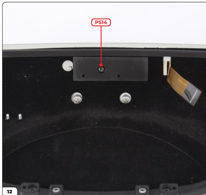
Asegura el soporte de la placa de circuito y la matrícula con un tornillo PS14.
