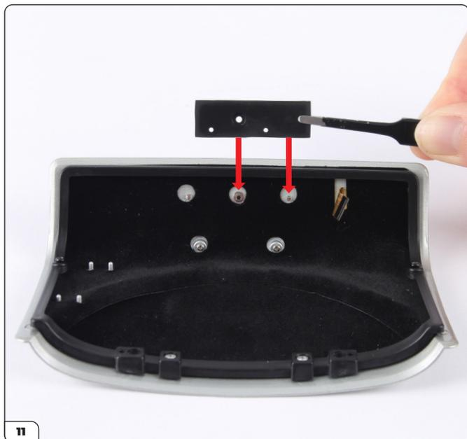
Alinea el soporte de la placa de circuito (92-D) con el interior de la tapa del maletero. Presiónalo sobre el poste de tornillo y el pasador como se muestra por las flechas.
