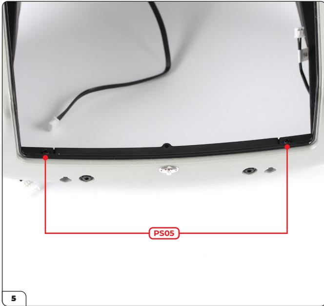
Gira el ensamblaje y asegura el bastidor a los pasos de rueda traseros con 2 tornillos PS05.
