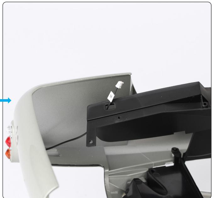
Coloca el cuerpo principal boca abajo en tu superficie de trabajo. Toma el paso de rueda trasero derecho (87-A) y pasa el enchufe del cable (nº 14) a través del agujero rectangular en el paso de rueda.
