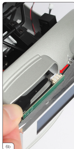
6 ステージ068で組み立てたシャーシアッセンブリーを本体に合わせ、No.08 (赤丸印) のケーブルをフロントの開口部に差し込み、ケーブルをフロントナンバープレートのサーキットボード (6b) に差し込みます。
