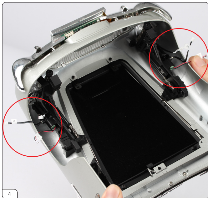
4 フロントのケーブルをホイールアーチの上で曲げます (赤丸印)。
