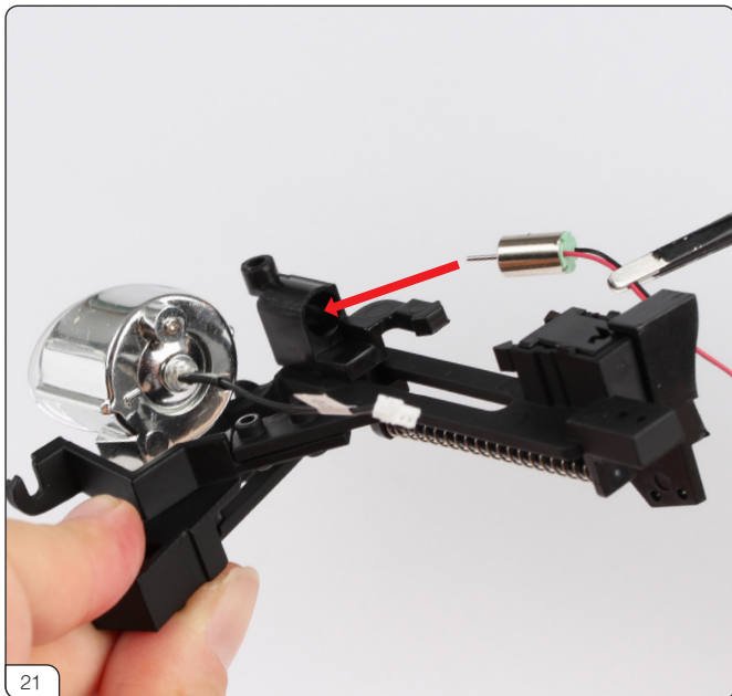
21 モーターNo.05 (98-L) をミニガンストッパーに押し込みます。
