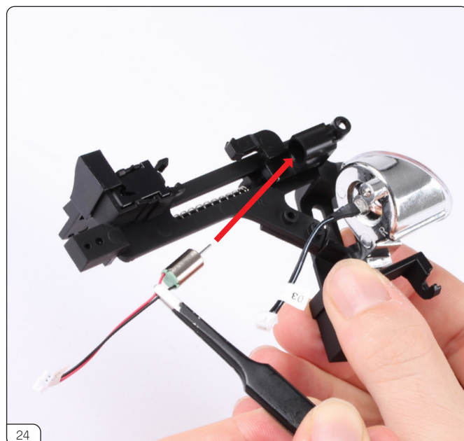
モーターNo.05 (96-L) をミニガンストッパーに押し込みます。
