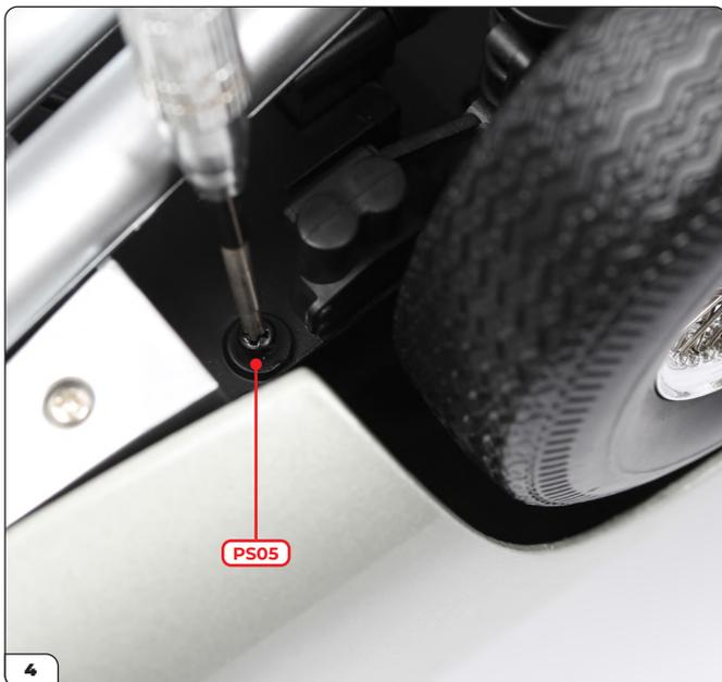
Schrauben Sie eine PS05-Schraube in das Loch hinter dem hinteren linken Rad.
