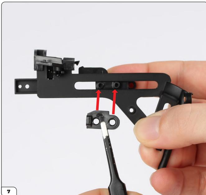
Halten Sie den Minigun-Stopper an Ort und Stelle und drehen Sie die Baugruppe um. Platzieren Sie die Halterung des Minigun-Stoppers (98-E) in der gezeigten Ausrichtung über den Schraubenlöchern.
