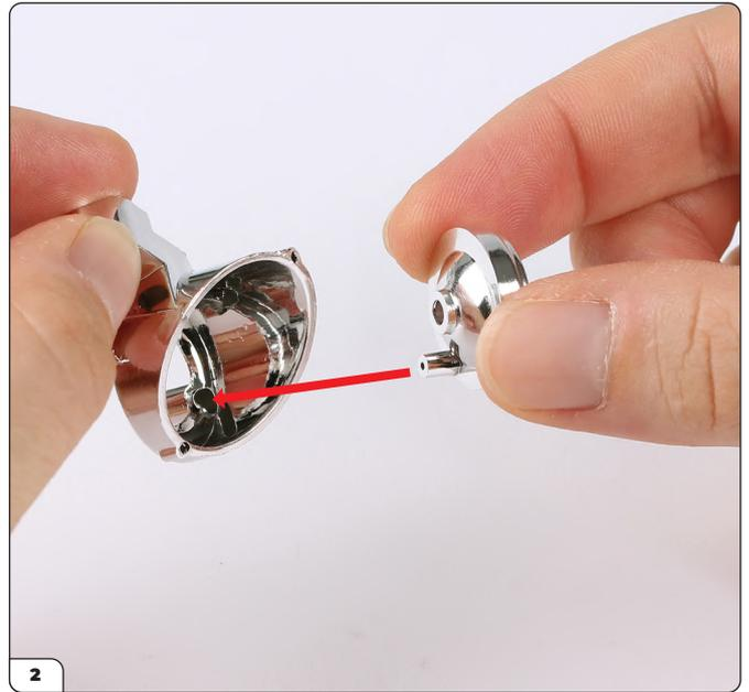
Drücken Sie den Reflektor in das Scheinwerfergehäuse (95-A).
