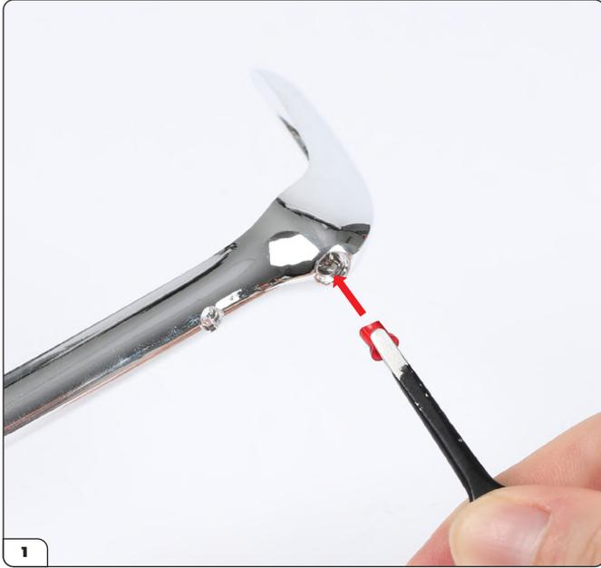
Drücken Sie einen der Reflektoren der hinteren Stoßstange (93-D) in die hintere Stoßstange (93-A). Der Reflektor ist so geformt, dass er nur in einer Richtung passt.
