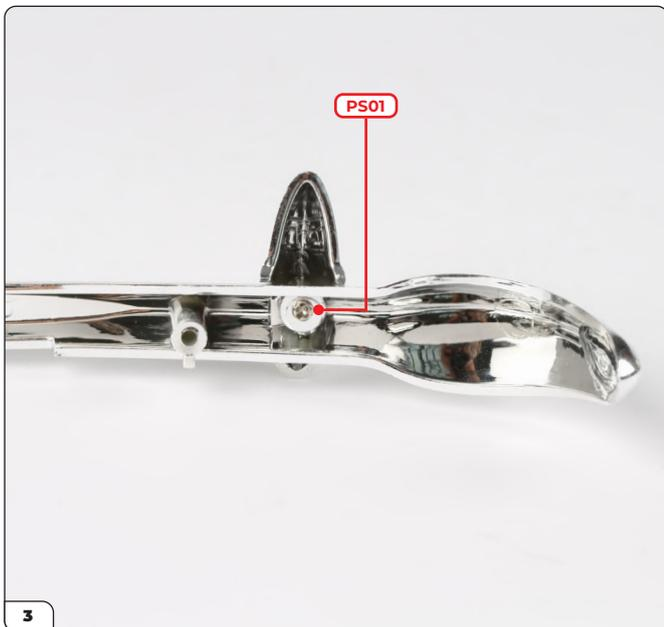
Schrauben Sie den Stoßfänger mit einer PS01-Schraube an die vordere Stoßstange.
