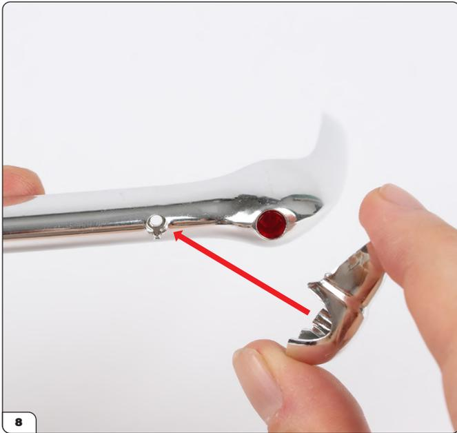
Nehmen Sie den hinteren rechten Stoßfänger (93-C), der mit "R R" markiert ist. Drücken Sie ihn in die hintere Stoßstange.
