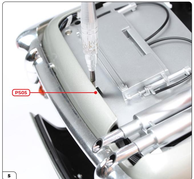
Schrauben Sie eine PS05-Schraube in das hintere Ende des Fahrgestells.
