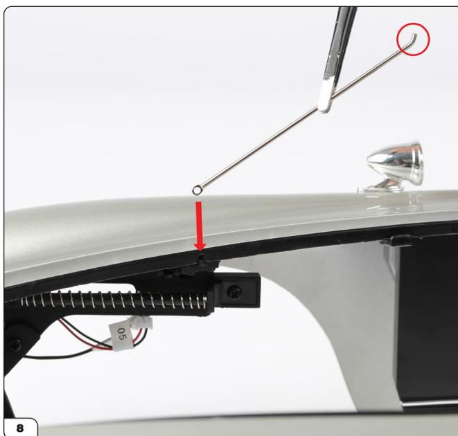
Richten Sie eine der Motorhaubenstützen (99-A) wie abgebildet an der Hauptkarosserie aus. Achten Sie darauf, dass das Ende (eingekreist) nach oben zeigt.
