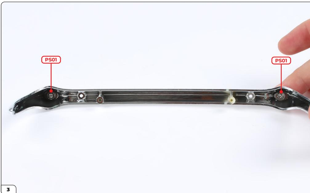
Schrauben Sie die Reflektoren mit 2x PS01-Schrauben an die hintere Stoßstange.
