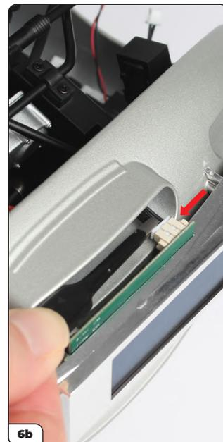
Nehmen Sie die Fahrgestellbaugruppe (Phase 068). Richten Sie sie an der Hauptkarosserie aus und führen Sie das Kabel Nr. 08 (eingekreist) durch die Öffnung. Stecken Sie das Kabel in die Platine des vorderen Nummernschilds (6b).
