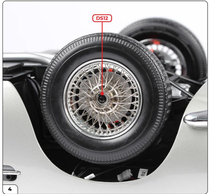
Drücken Sie das andere Rad (Phase 029) auf die vordere linke Nabe und schrauben Sie eine DS12-Schraube ein.
