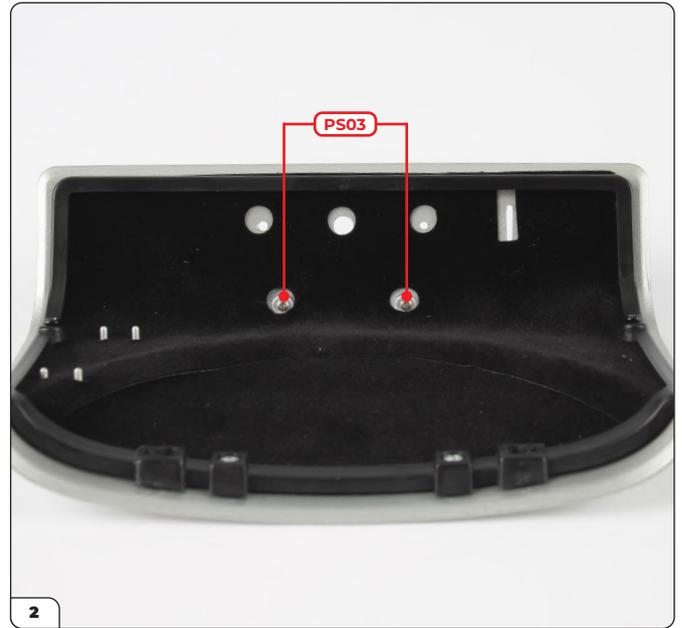
Von innen mit 2x PS03-Schrauben (aus Phase 092) sichern.
