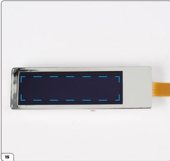
Drehen Sie das Nummernschild um und prüfen Sie, ob die Anzeige zentriert ist (gestrichelte Linie). Passen Sie die Position bei Bedarf vorsichtig an, indem Sie die Anzeige verschieben.
