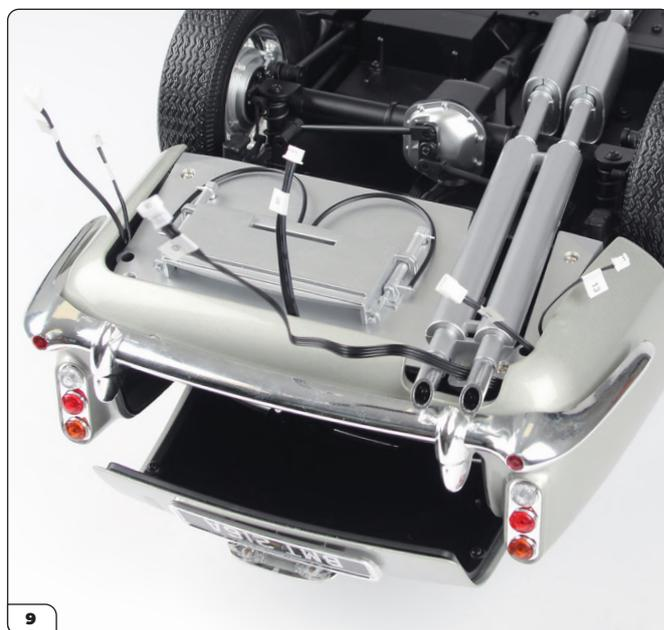
Während Sie Druck ausüben, senken Sie das hintere Ende des Fahrgestells in die Karosserie. Achten Sie darauf, dass das im vorherigen Schritt hervorgehobene Schraubenloch die Karosserie nicht beschädigt.
