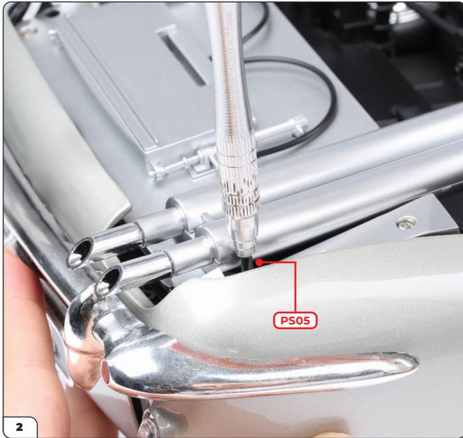
Schrauben Sie eine PS05-Schraube in die hintere linke Ecke.
