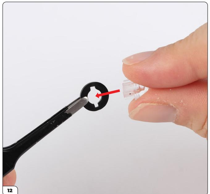
Drücken Sie die Nebelscheinwerferlinse (97-F) in die Halterung des Nebelscheinwerfers (97-G).
