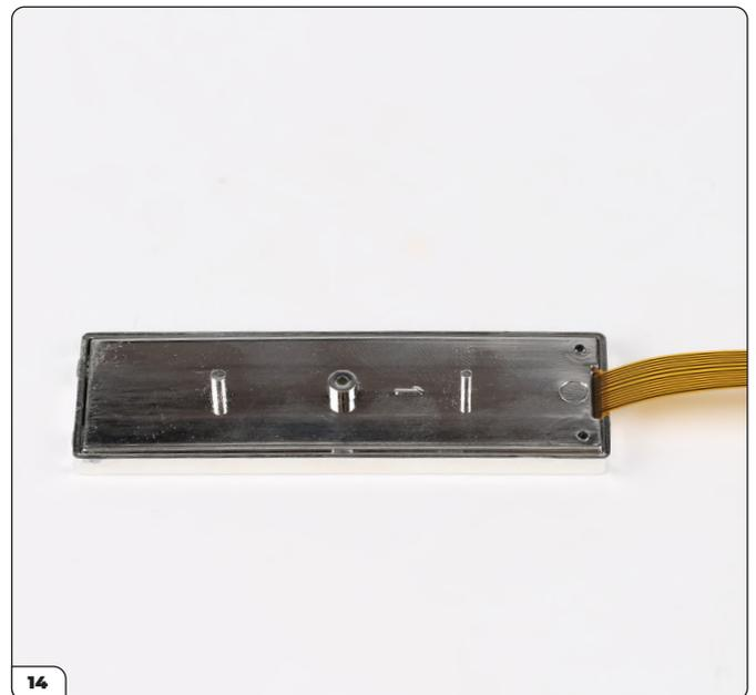
Bringen Sie die Rückseite an. Möglicherweise müssen Sie die Position der Anzeige leicht anpassen, damit die Vorder- und Rückseite zusammenpassen.
