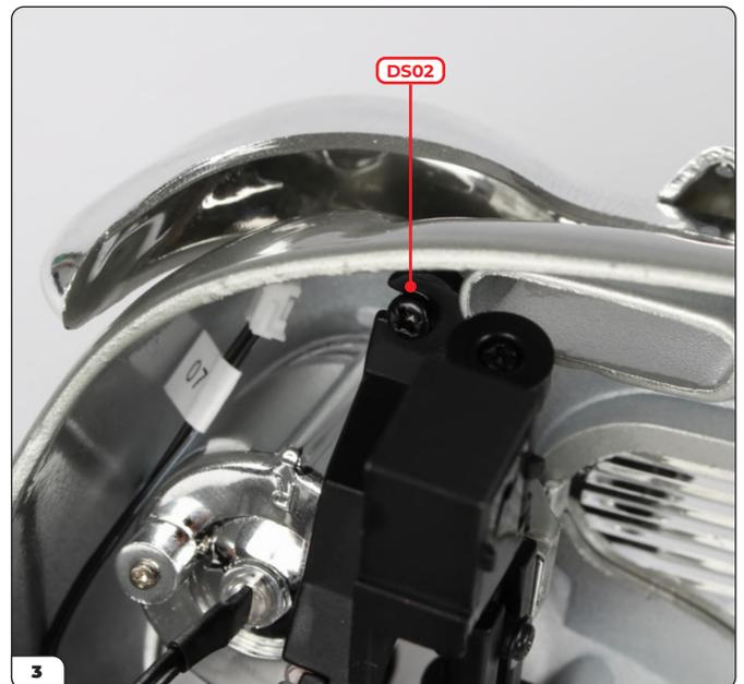
Schrauben Sie den Mechanismus mit einer DS02-Schraube an den zweiten Schraubpfosten.
