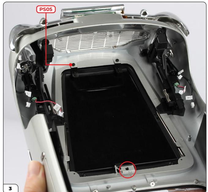
Schließen Sie die Motorhaube und achten Sie darauf, dass das Motorhaubenschloss in das Loch (eingekreist) passt. Schrauben Sie eine PS05-Schraube zur Hälfte in das andere Scharnier. Ziehen Sie beide Schrauben fest an, sobald Sie mit der Platzierung der Motorhaube zufrieden sind.
