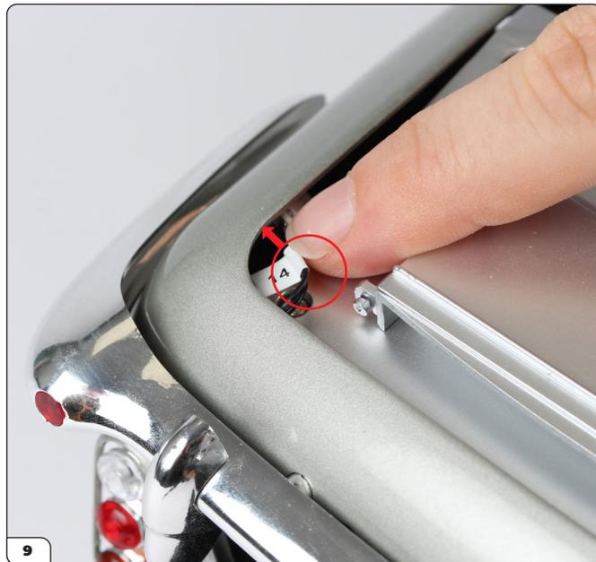
Verstauen Sie die Kabel am hinteren Ende des Modells in den Lücken zwischen der Karosserie und dem Fahrgestell.
