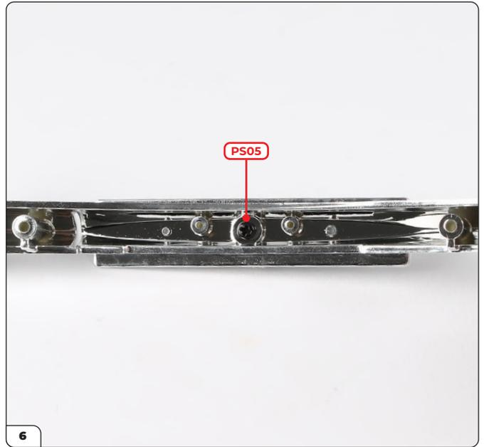
Schrauben Sie das vordere Nummernschild mit einer PS05-Schraube an die vordere Stoßstange.
