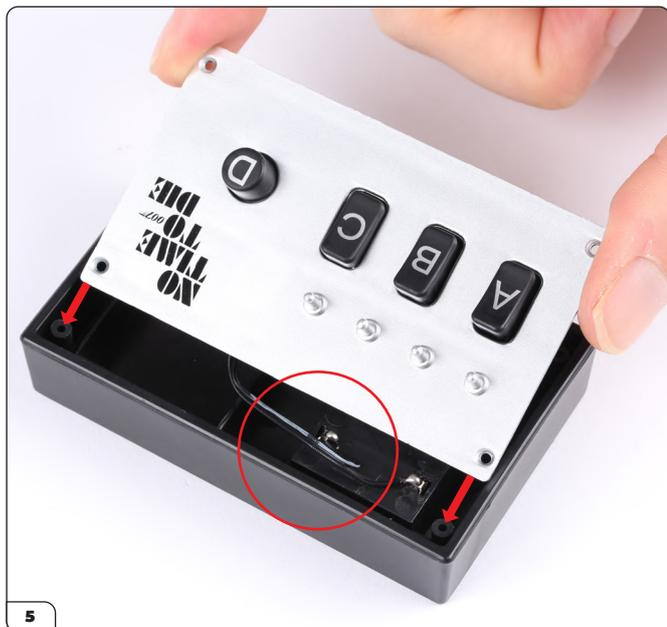
Setzen Sie die Vorderseite der Fernbedienung auf das Gehäuse. Achten Sie darauf, dass das Kabel nicht eingeklemmt wird (eingekreist).
