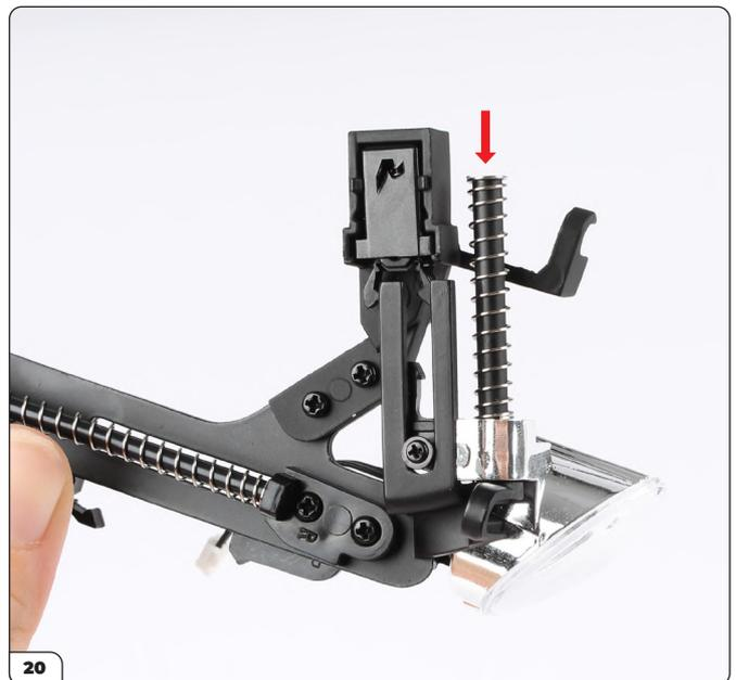
Setzen Sie die kurze Feder (96-J) auf die Scheinwerferwelle.
