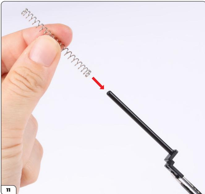
Setzen Sie die lange Feder (98-K) auf die Welle (98-I).
