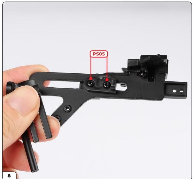
Schrauben Sie die Teile mit 2x PS05-Schrauben zusammen.
