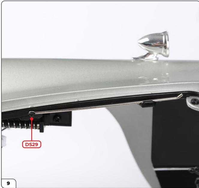
Schrauben Sie die Motorhaubenstütze mit einer DS29-Schraube an die Hauptkarosserie.
