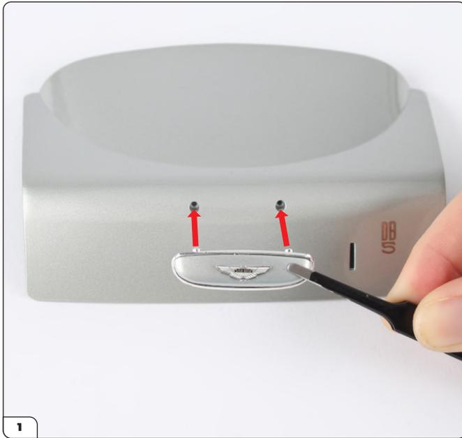
Nehmen Sie die hintere Nummernschildbeleuchtung (Phase 089) und drücken Sie sie in die beiden oberen Löcher in der Kofferraumklappe (Phase 091).
