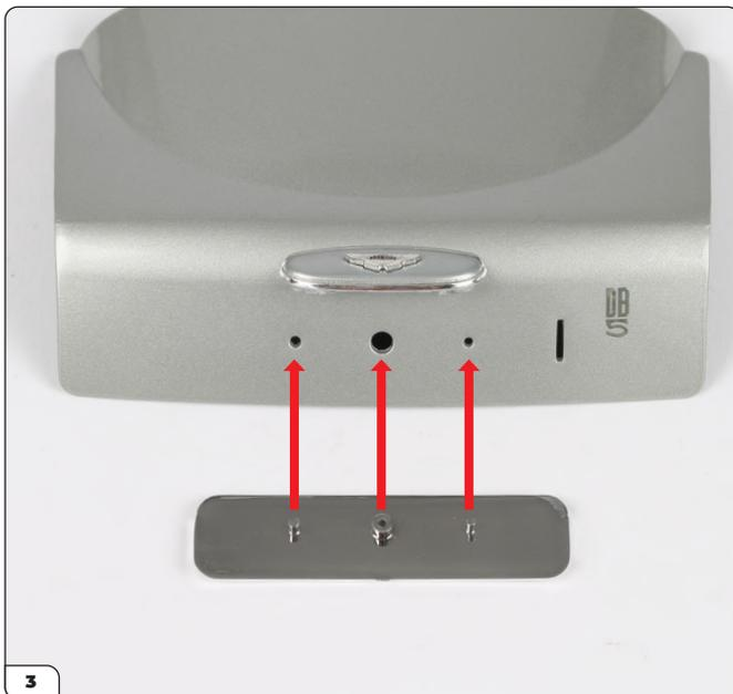
Drücken Sie das hintere Nummernschild (100-F) in die Kofferraumklappe. Die Stifte haben unterschiedliche Größen, um die korrekte Ausrichtung zu gewährleisten.
