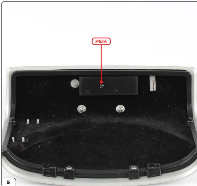
Schrauben Sie die Halterung der Platine mit einer PS14-Schraube (Phase 092) am hinteren Nummernschild fest.
