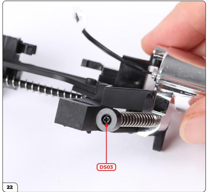
Schrauben Sie die Kappe mit einer DS03-Schraube an die Welle.
