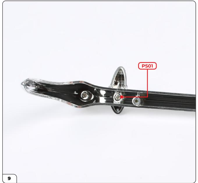
Schrauben Sie den Stoßfänger mit einer PS01-Schraube an die Stoßstange.
