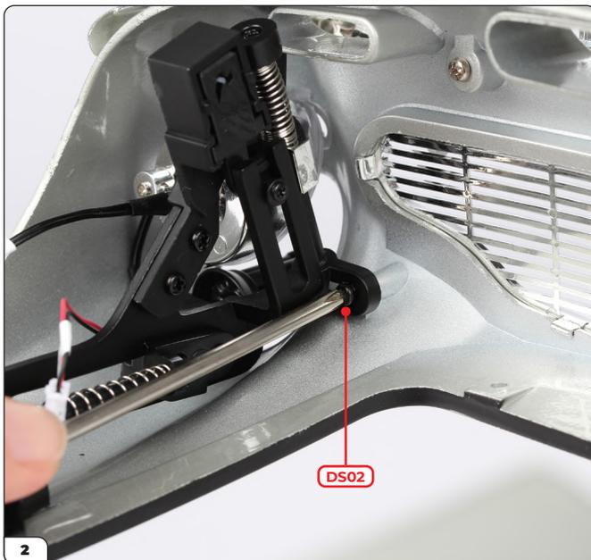
Schrauben Sie den Mechanismus mit einer DS02-Schraube an den ersten Schraubpfosten.
