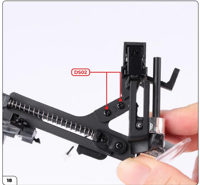
Schrauben Sie die Teile mit 2x DS02-Schrauben zusammen.
