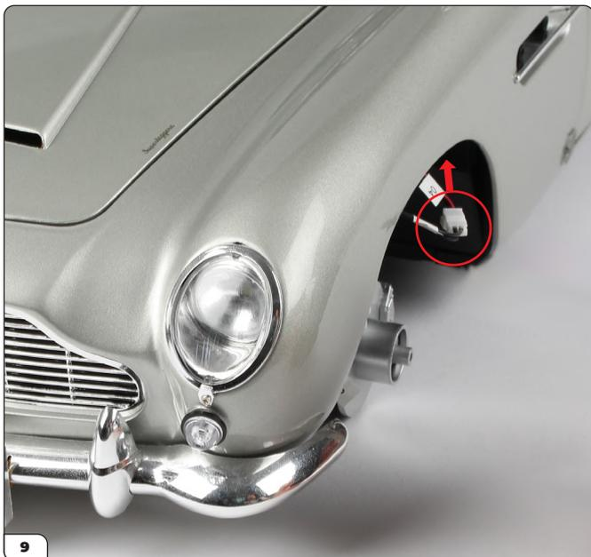
Verstauen Sie die Kabel an der Vorderseite des Modells in den Radkästen.
