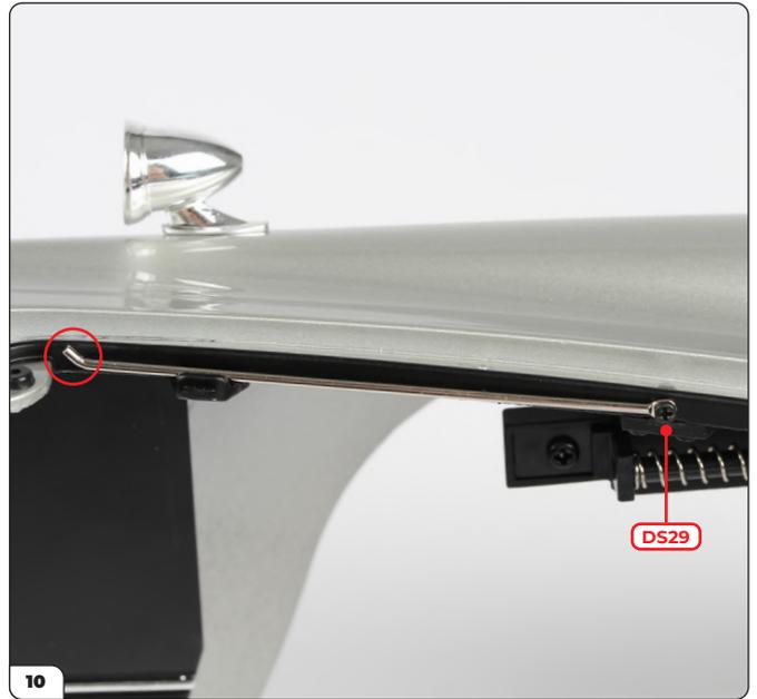
Schrauben Sie die zweite Motorhaubenstütze auf die gleiche Weise mit einer DS29-Schraube an die Hauptkarosserie.
