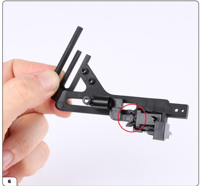
Der Minigun-Stopper wird mit der Klemme ausgerichtet, wenn er entlang der Schiene zurückgeschoben wird.
