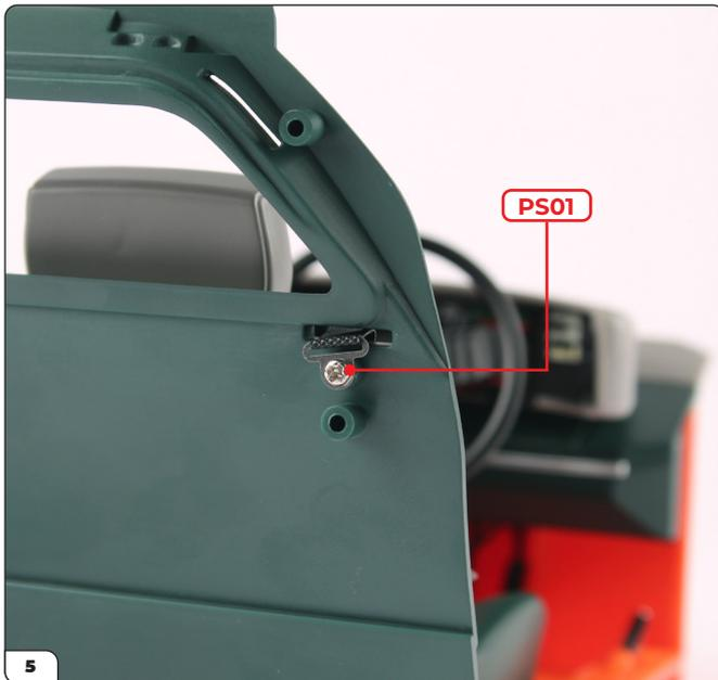
Positionieren Sie das Ende des Sicherheitsgurts über dem Schraubenbolzen und befestigen Sie es mit einer PS01 Schraube.
