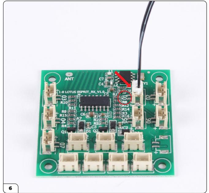
Stecken Sie den Draht in die mit '01' gekennzeichnete Buchse.
