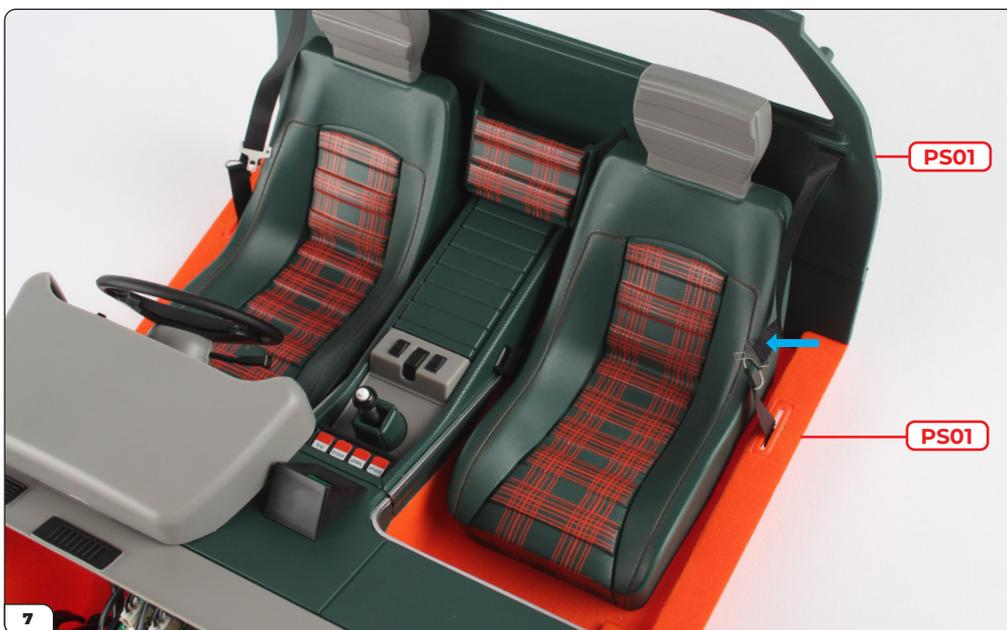
Wiederholen Sie diese Schritte auf der anderen Seite, um den zweiten Sicherheitsgurt anzubringen, und befestigen Sie ihn auf die gleiche Weise mit 2 PS01 Schrauben.
