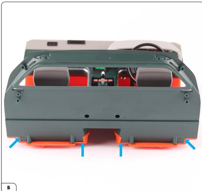
Überprüfen Sie, ob die Schottwand und der Boden korrekt zusammenpassen. Die Kanten sollten bündig sein.
