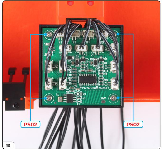
Stellen Sie sicher, dass die Drähte nicht darunter eingeklemmt sind. Sichern Sie es mit 4 PS02 Schrauben.
