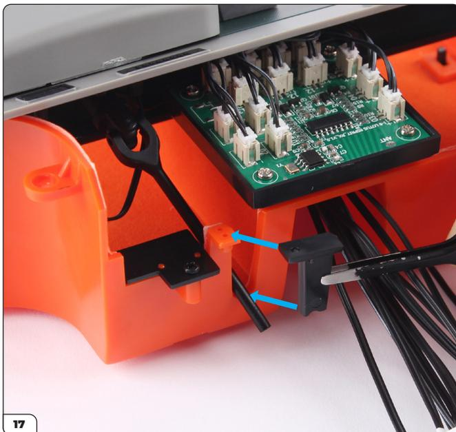
Platzieren Sie die Lenksäulenhalterung in Position.
