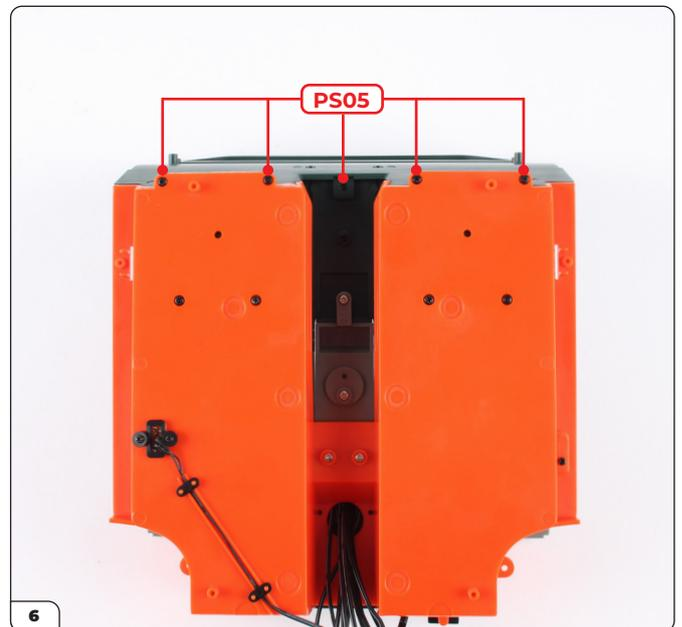
Befestigen Sie sie mit 5 PS05 Schrauben.
