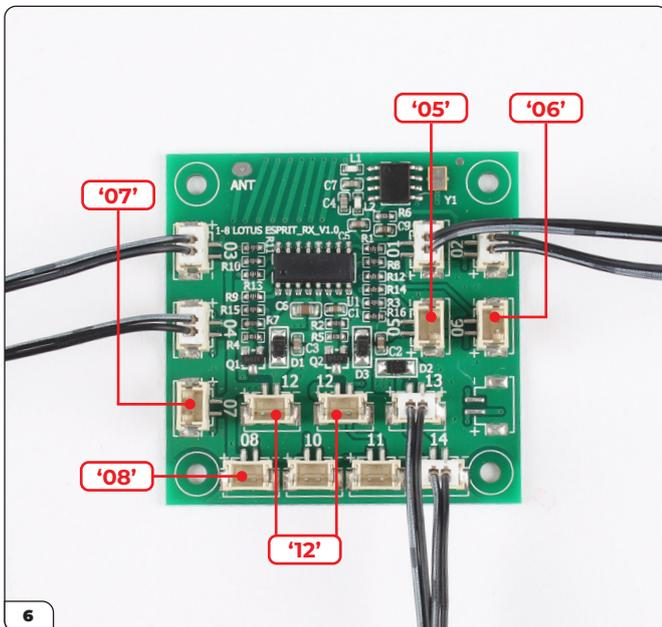
Nehmen Sie die Leiterplatte (Bauphase 043). Sie stecken nun die Drähte aus dieser Bauphase in die entsprechenden Buchsen.
