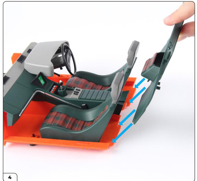
Positionieren Sie die Schottwand auf der Cockpitbaugruppe (Bauphase 047).
