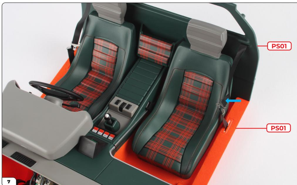
Repite estos pasos en el otro lado para ajustar el segundo cinturón de seguridad, asegurándolo con 2 tornillos PS01 de la misma manera.
