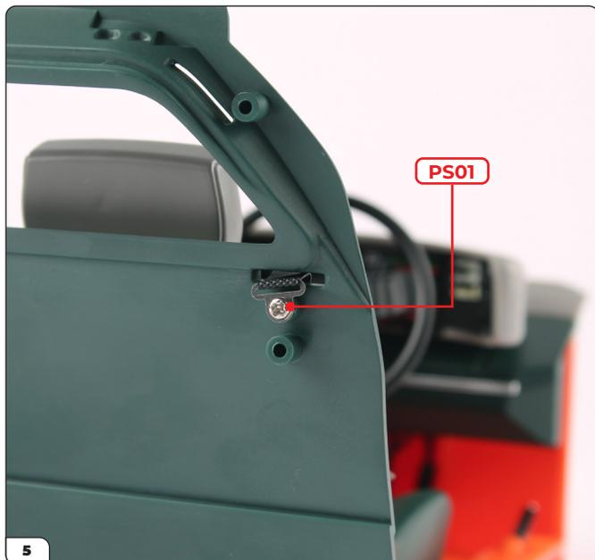
Posiziona l'estremità della cintura di sicurezza sul pilastro delle viti e fissala con una vite PS01.
