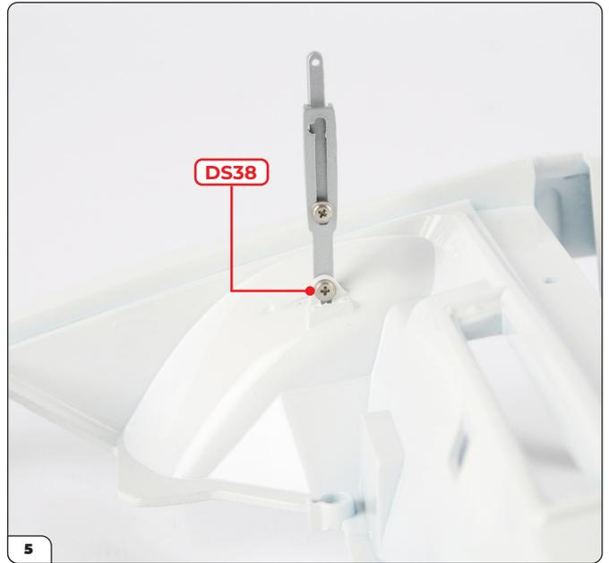
Sichern Sie die Motorhaubenstützstrebe, indem Sie eine DS38 Schraube von innen durchtreiben, wie gezeigt.
