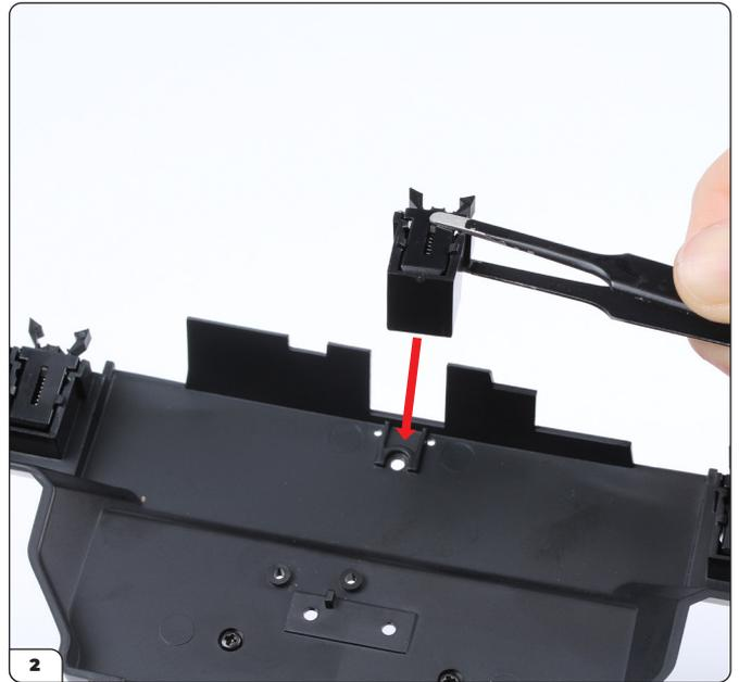
Setzen Sie die Klemmhalterung auf das Frontpanel (Bauphase 058).
