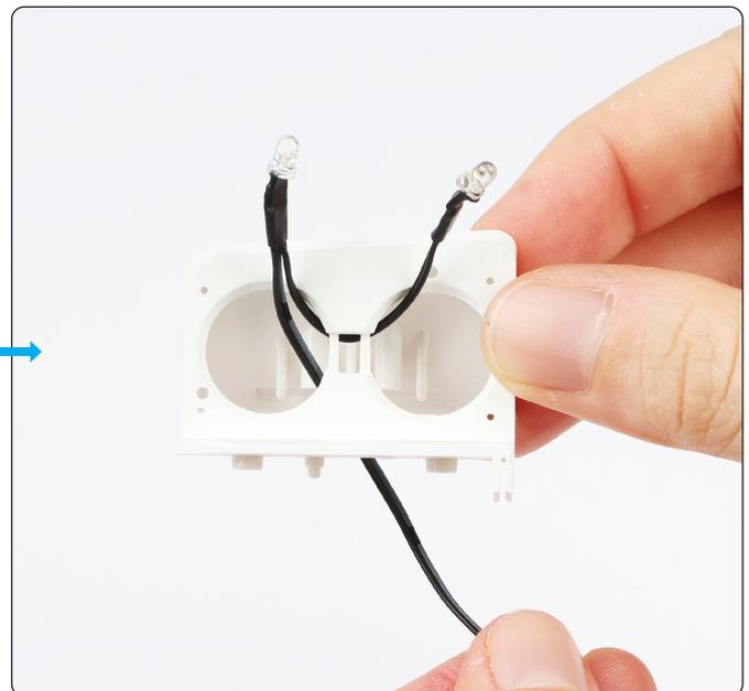
Setzen Sie die LEDs des rechten Scheinwerfers (60-D) in das Gehäuse des rechten Scheinwerfers (60-B) ein. Stellen Sie sicher, dass die Teile wie gezeigt ausgerichtet sind.
