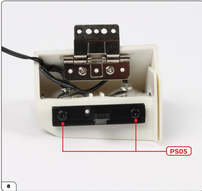
Schrauben Sie den Stopfen mit 2x PS05 Schrauben an das Gehäuse.
