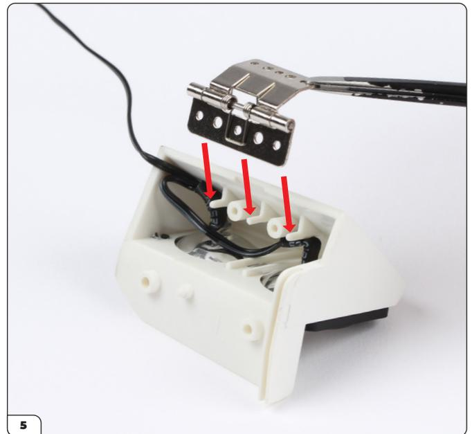
Richten Sie das Scharnier (63-D) wie gezeigt am Gehäuse aus.
