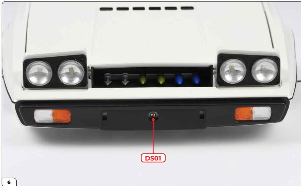
Schrauben Sie eine DS01-Schraube durch den vorderen Stoßfänger in die Karosserie vorne.
