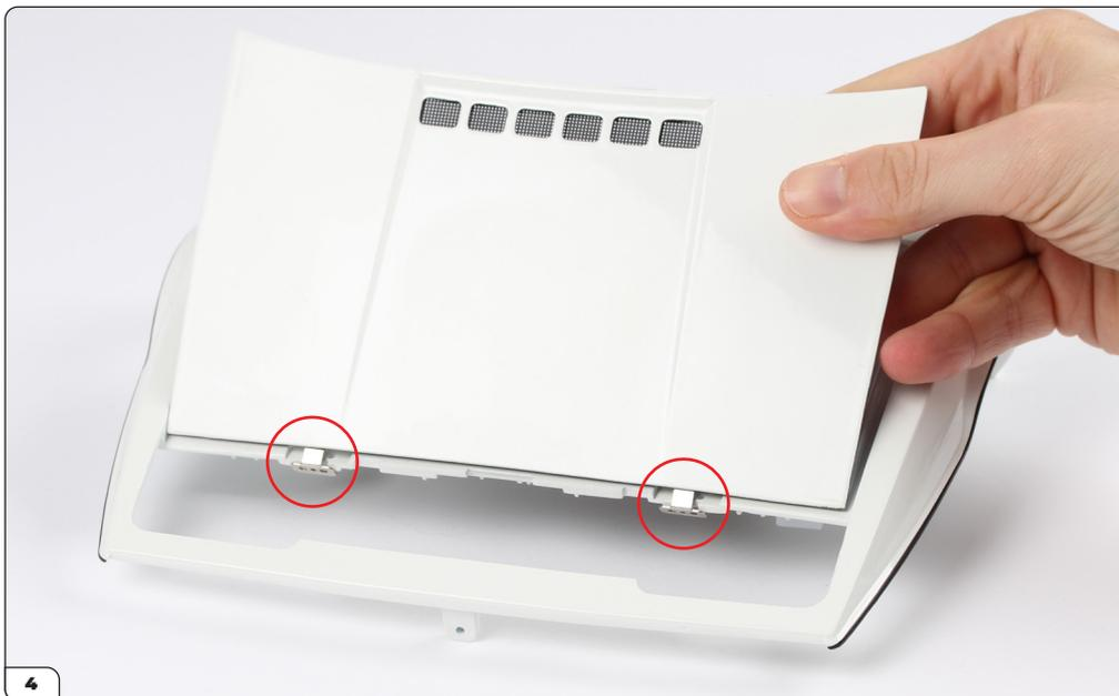
Setzen Sie die Motorhaube auf den vorderen Teil des Fahrzeugs. Lassen Sie die Scharniere vorerst locker.
