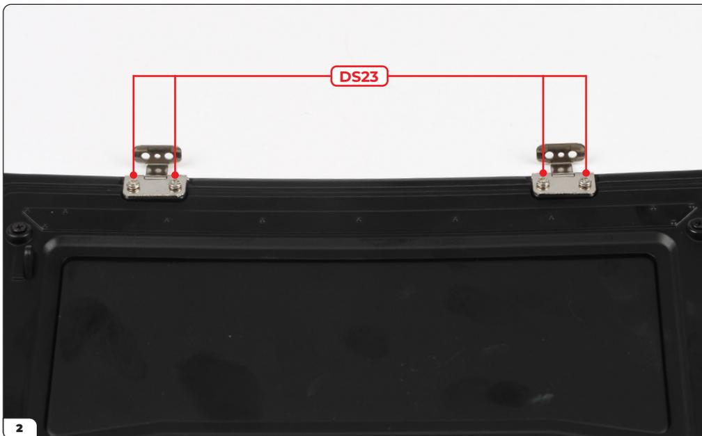
Schrauben Sie die Scharniere mit 4x DS23 Schrauben an die Motorhaube.
