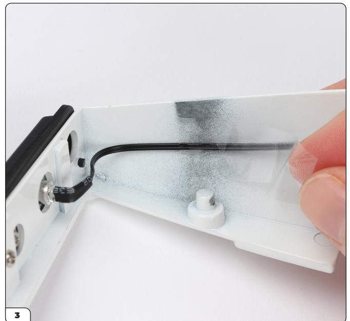
Kleben Sie den Draht mit einem Stück Klebeband (65-F) an den rechten Flügel.
