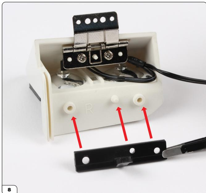
Setzen Sie den Stopper (61-C) auf das Gehäuse.
