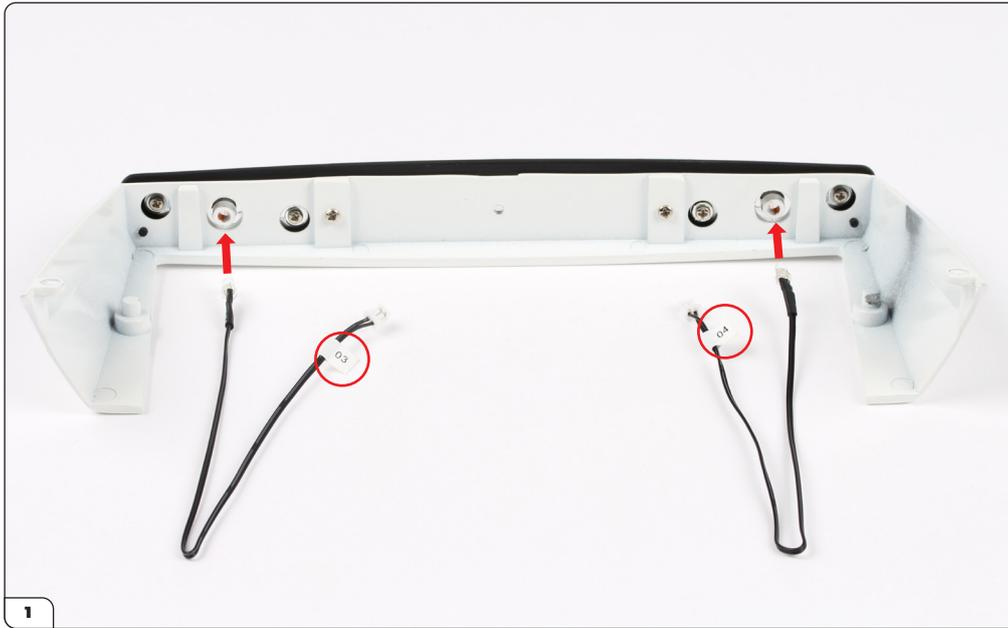
Legen Sie die vorderen Flügel (Bauphase 002) auf Ihre Arbeitsfläche. Drücken Sie die linke Blinker-LED (65-D), beschriftet mit Nr. 3, in den linken Reflektor. Drücken Sie die rechte Blinker-LED (65-E), beschriftet mit Nr. 4, in den rechten Reflektor.
