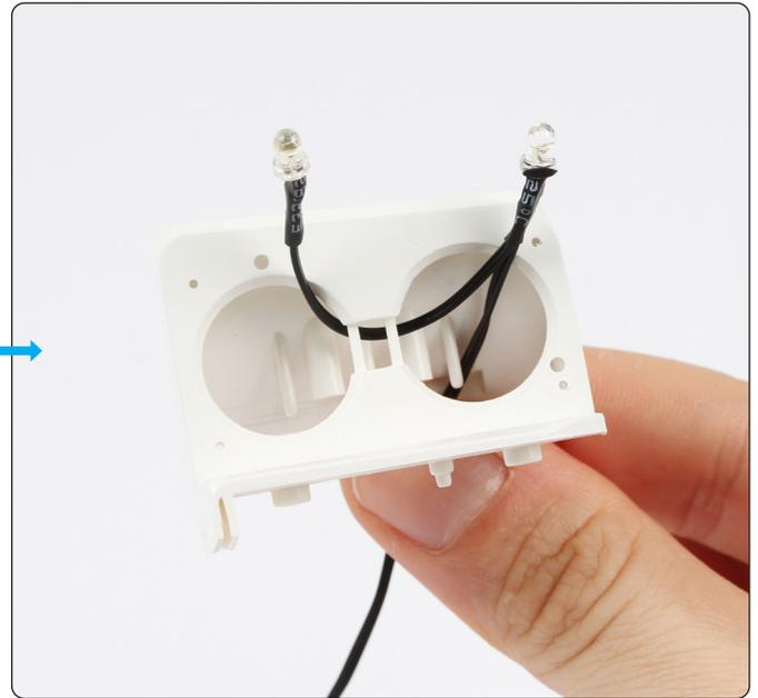
Setzen Sie die LEDs des linken Scheinwerfers (62-C) in das Gehäuse des linken Scheinwerfers (62-A) ein. Stellen Sie sicher, dass die Teile wie gezeigt ausgerichtet sind.
