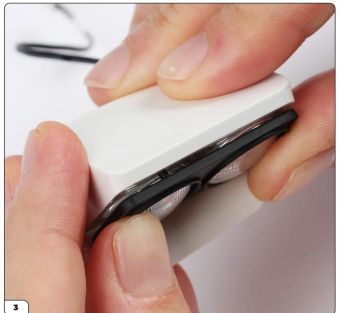
Drücken Sie den Rahmen über die Reflektoren und in das Scheinwerfergehäuse.
