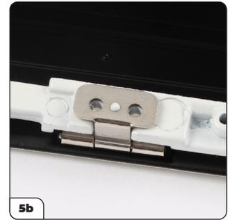
Drehen Sie die Montage um und drücken Sie die Scharniere auf die Stifte.
