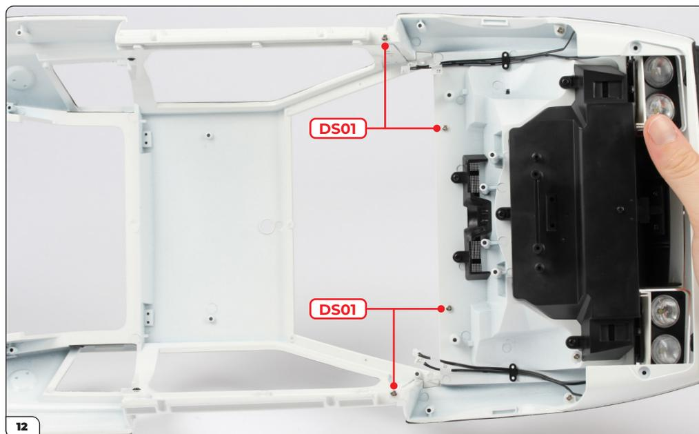
Schrauben Sie die Teile mit 4x DS01 Schrauben zusammen.
