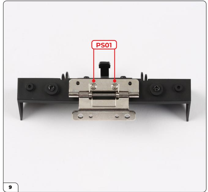
Schrauben Sie das Scharnier mit 2x PS01 Schrauben an den Launcher.
