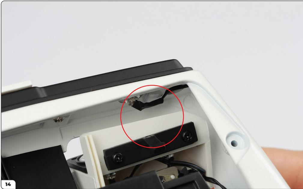
Drücken Sie die Scheinwerfer nach unten, bis sie in die Klammern einrasten. Stellen Sie sicher, dass genügend Platz zwischen den Blinkerkabeln und den Scheinwerfern ist.
