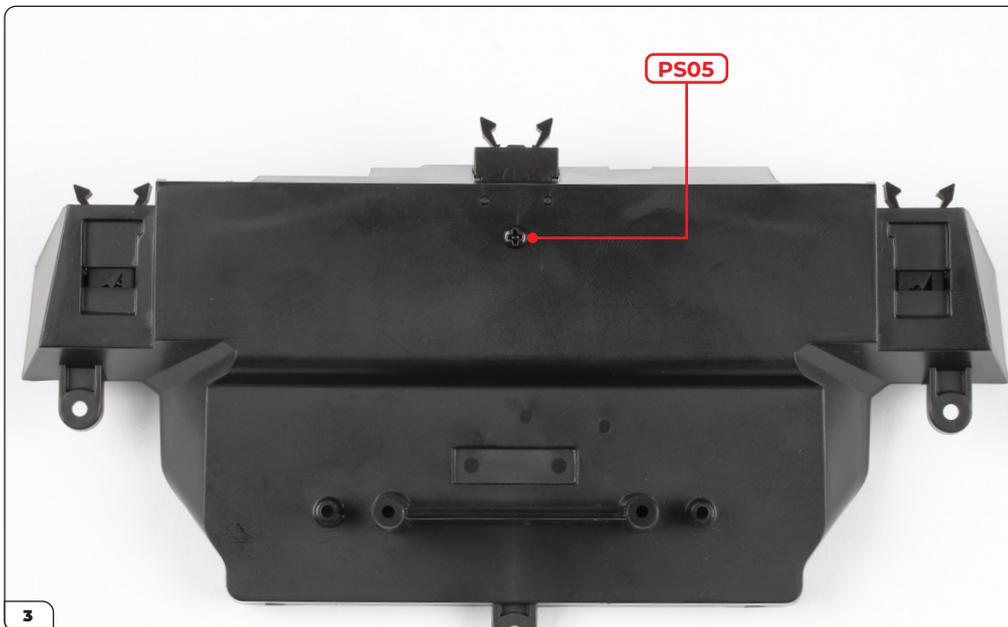
Schrauben Sie die Klemmhalterung mit einer PS05-Schraube an die Frontplatte.
