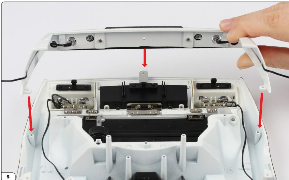
Setzen Sie den Frontflügel auf die vordere Karosseriemontage (Bauphase 063).
