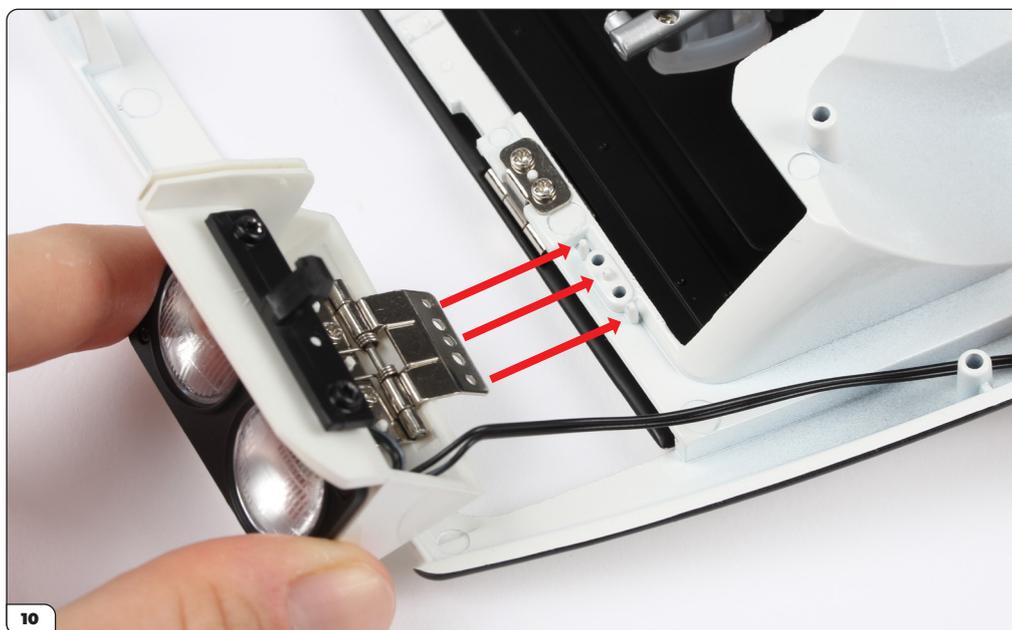
Legen Sie die Vorderseite kopfüber auf Ihre Arbeitsfläche. Setzen Sie das Scharnier auf die Halterung. Möglicherweise müssen Sie das Scharnier zusammendrücken, um es einzusetzen.
