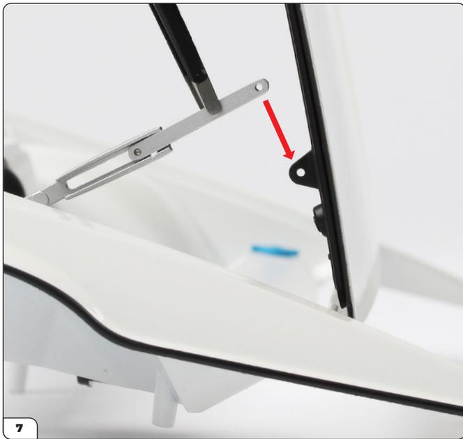
Öffnen Sie die Motorhaube. Platzieren Sie die Motorhaubenstützstrebe hinter dem Schraubenloch.
