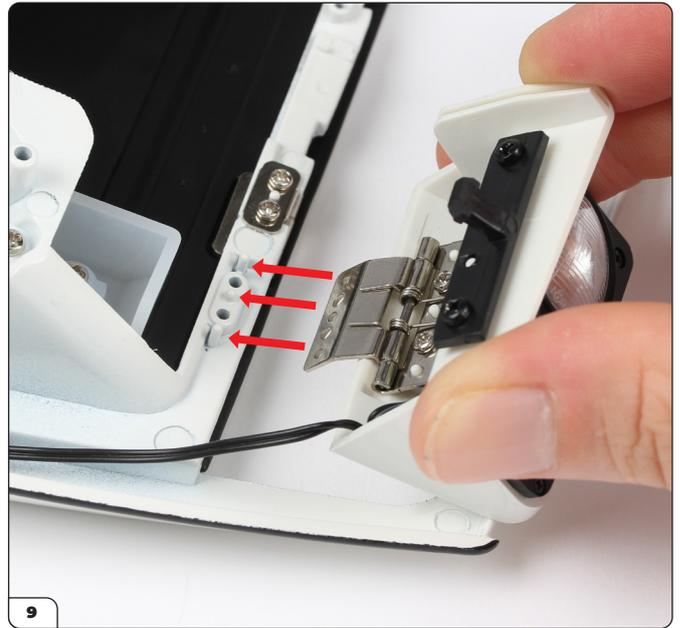
Platzieren Sie die Vorderseite nach unten und positionieren Sie das Scharnier auf der Halterung. Sie müssen möglicherweise das Scharnier zusammendrücken, um es einzusetzen.
