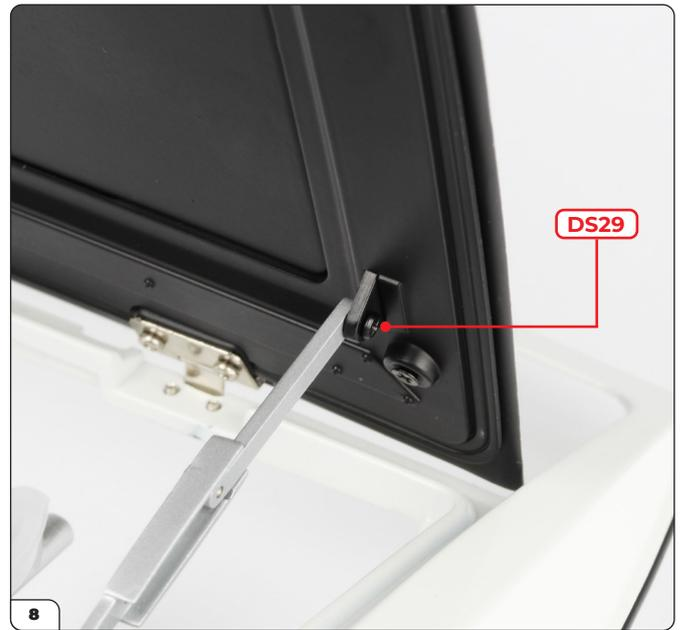
Schrauben Sie die Motorhaubenstütze mit einer DS29 Schraube an die Motorhaube.
