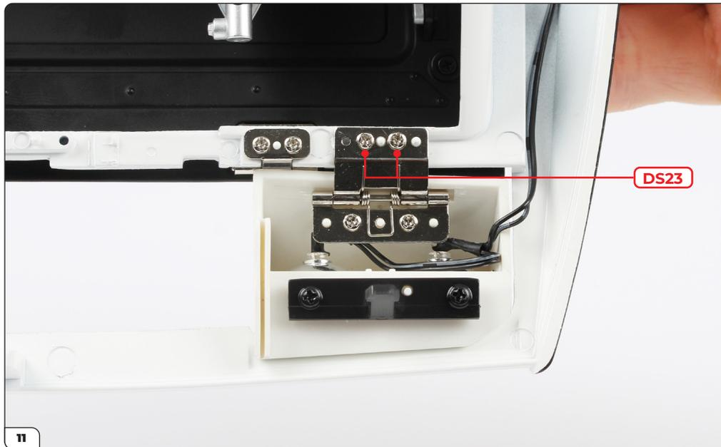
Schrauben Sie das Scharnier mit 2x DS23 Schrauben fest an den vorderen Körper.
