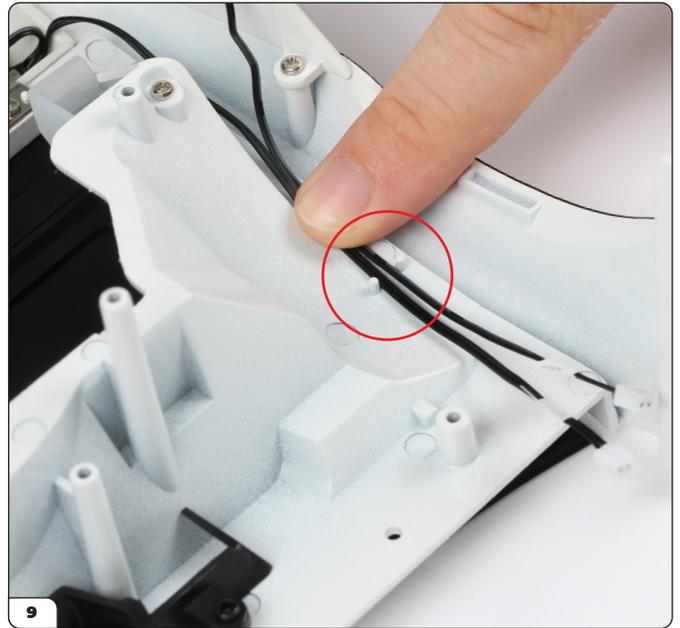
Positionieren Sie die linken LED-Kabel (Nr. 01 und 03) zwischen den beiden Pins.
