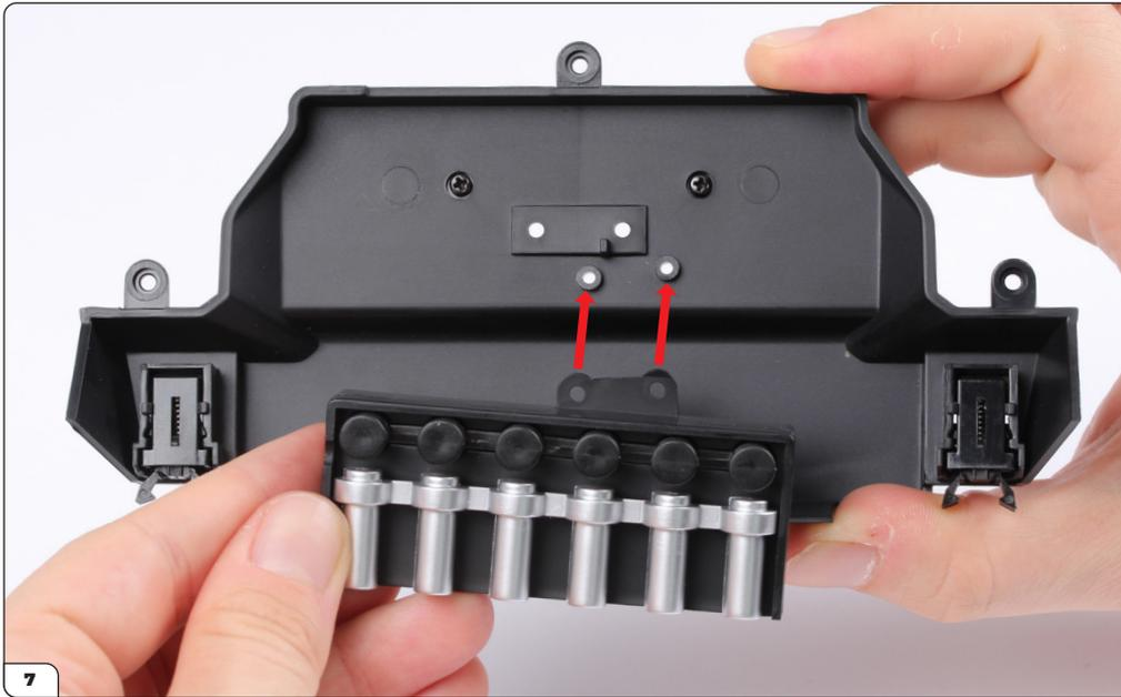
Setzen Sie das Torpedopaneel auf das Frontpaneel (Phase 058).
