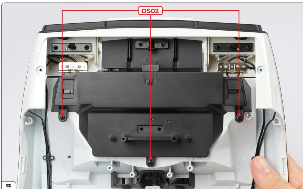
Schrauben Sie die Frontplatte mit 3x DS02 Schrauben an das Frontgehäuse.
