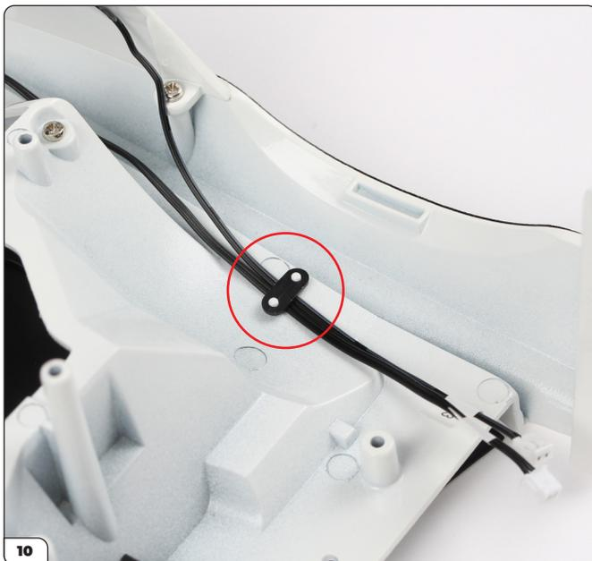
Drücken Sie eine Drahtklammer auf die Stifte, um die Drähte zu sichern.
