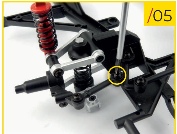
60/05 Schrauben Sie eine zweite Typ-J-Schraube (im Lieferumfang von Phase 59 enthalten) in das angegebene Loch, um die Zugstange am Umlenkhebel zu befestigen.
