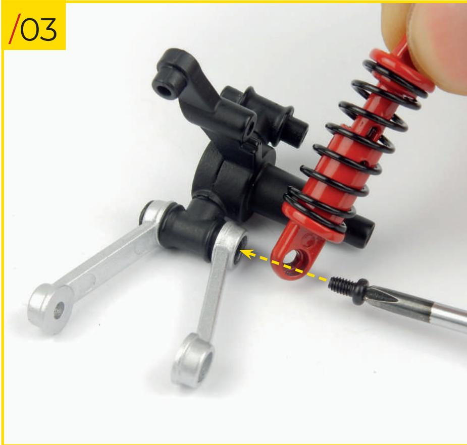
57/03 Bringen Sie nun den Stoßdämpfer am Rest der Baugruppe an und richten Sie die Teile wie abgebildet aus. Befestigen Sie alles mit einer Typ-C-Schraube.
