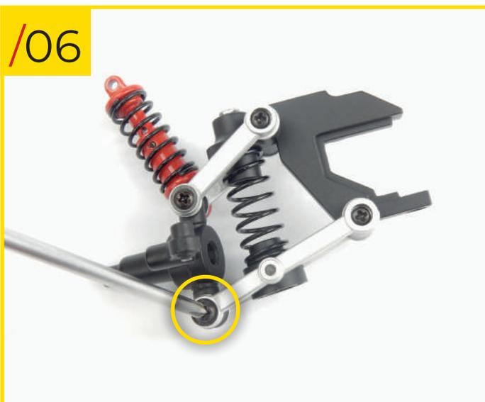
58/06 Schrauben Sie eine Typ-J-Schraube in das angegebene Loch, um den Arm am Achsschenkel zu befestigen.
