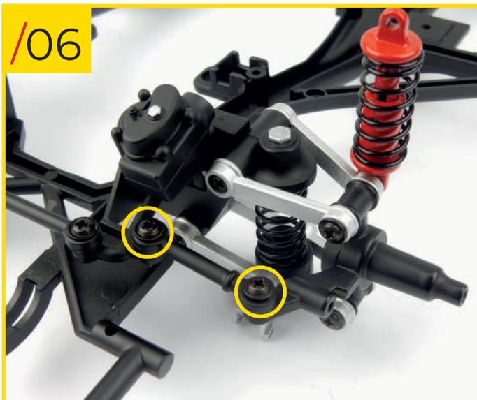
60/06 Gehen Sie auf der linken Seite genauso vor: Verbinden Sie den Arm und den Achsschenkel mit Hilfe der zweiten Spurstange (Phase 59) und befestigen Sie die Teile, indem Sie zwei Typ-J-Schrauben (Phase 59) in die angegebenen Löcher einschrauben.
