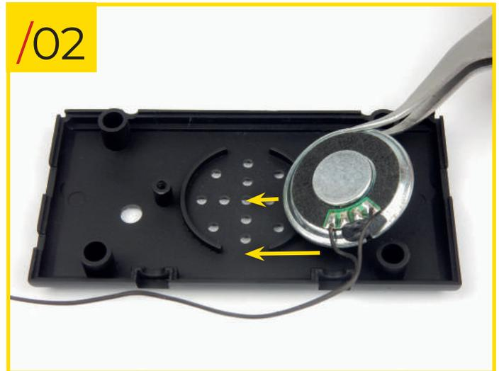
64/02 Setzen Sie den Lautsprecher in das Gehäuse ein und richten Sie die Teile wie auf dem Foto gezeigt aus. Stellen Sie sicher, dass das Kabel in die Lücke des runden Gehäuses gelegt wird.
