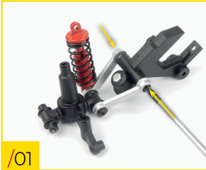
58/01 Legen Sie die vordere rechte Aufhängungsbaugruppe, die Sie in Schritt 57 bearbeitet haben, und die Verbindungshalterung auf Ihre Arbeitsfläche. Richten Sie die Teile wie abgebildet aus und befestigen Sie sie durch Einschrauben von zwei Typ-B-Schrauben in die angegebenen Löcher.
