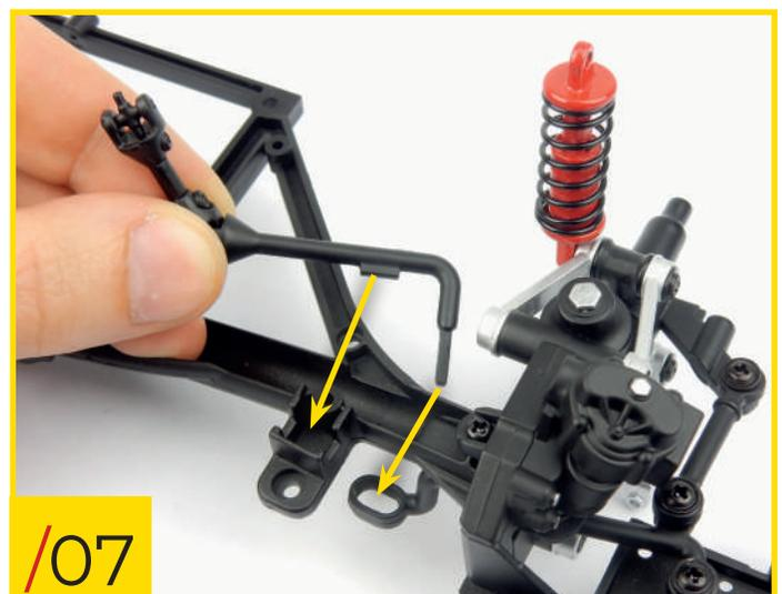
60/07 Montieren Sie die Lenkwelle am Fahrgestell und am Lenkstockhebel und richten Sie die Teile wie gezeigt aus.
