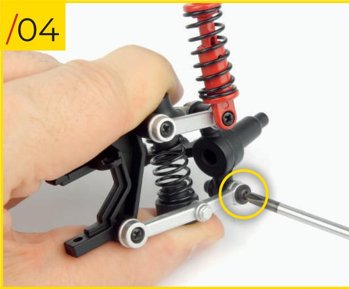
58/04 Befestigen Sie den Arm mit einer Typ-J-Schraube am Achsschenkel.
