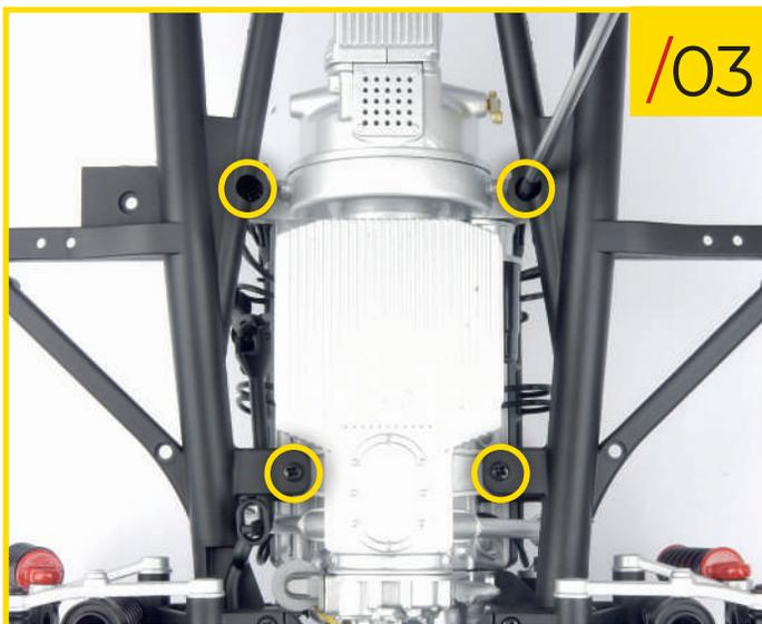
61/03 Drehen Sie die Baugruppe um und befestigen Sie die Teile mit vier Typ-C-Schrauben.
