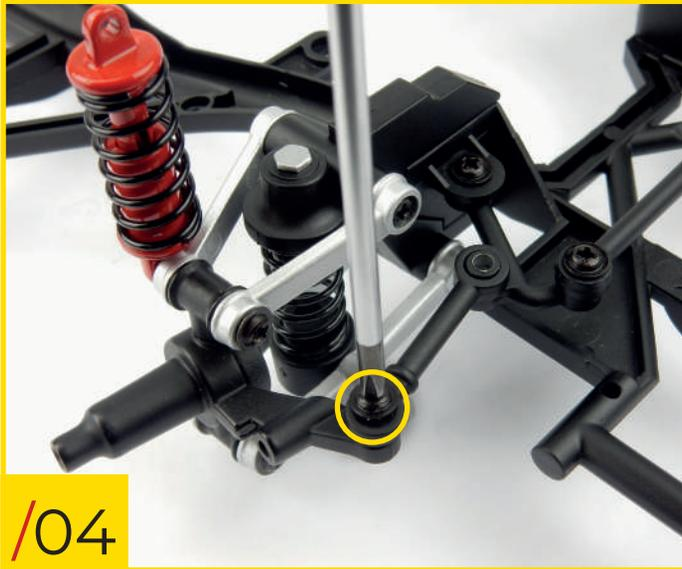
60/04 Verbinden Sie den Achsschenkel der rechten Vorderradaufhängung mit dem rechten Lenker mithilfe einer der mit Phase 59 gelieferten Zugstangen. Richten Sie die Spurstange wie abgebildet aus und befestigen Sie sie mit einer Typ-J-Schraube (im Lieferumfang von Phase 59 enthalten) am Achsschenkel. Die Vorderradaufhängung muss zusammengedrückt werden, damit die Zugstangen passen.
