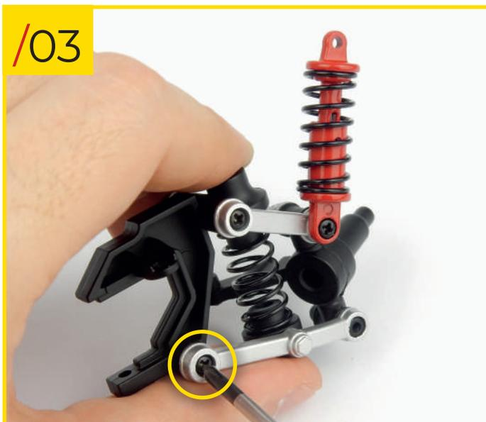
58/03 Verbinden Sie den unteren Arm B (der ohne zentrales Loch) mit dem Rest der Baugruppe, indem Sie die Teile wie gezeigt ausrichten. Richten Sie das längere Ende des Arms mit der Halterung und das kürzere Ende mit dem Achsschenkel aus und stecken Sie dann den Bolzen in der Mitte des Arms in eines der Löcher der Federhalterung. Schrauben Sie eine Typ-B-Schraube in das Loch, das auf dem Foto durch einen Kreis gekennzeichnet ist.
