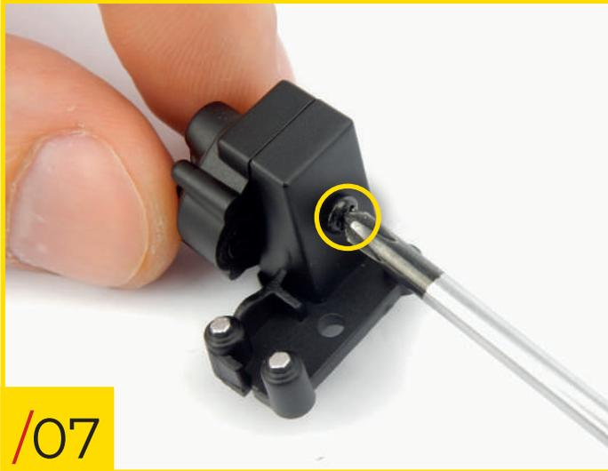
59/07 Montieren Sie das Lenkgehäuse an seiner Halterung und richten Sie die Teile wie abgebildet aus. Befestigen Sie die Teile mit einer Typ-B-Schraube.
