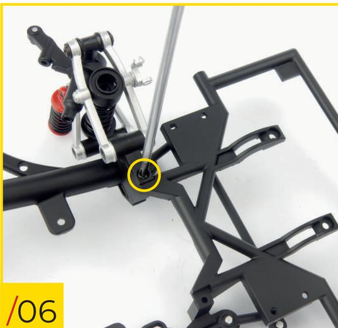
59/06 Drehen Sie das Gehäuse auf den Kopf und schrauben Sie eine zweite Typ-B-Schraube in das angegebene Loch auf der Unterseite.
