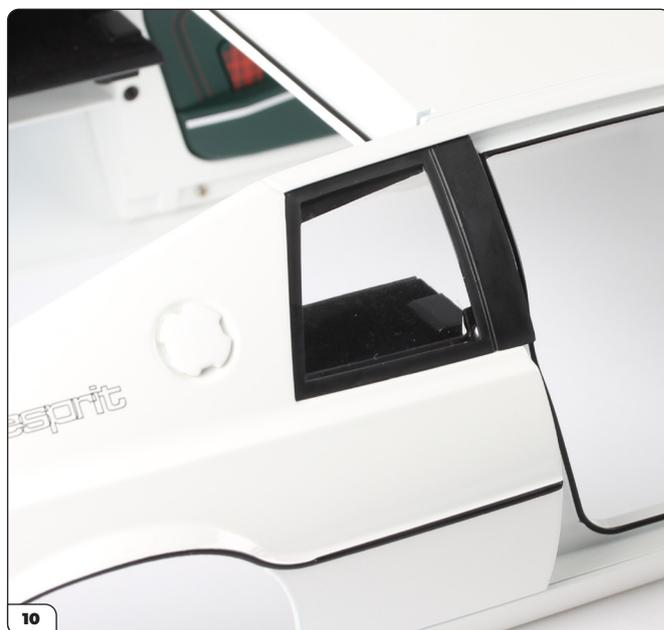
Spingere le linguette in posizione e poi premere il telaio laterale nel corpo principale.
