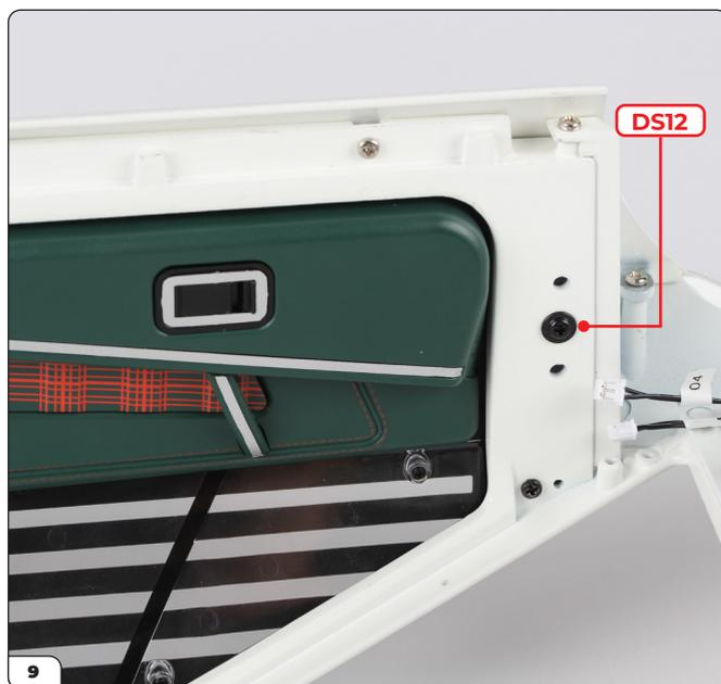
Avvita la portiera alla carrozzeria con una vite DS12. Assicurati che la vite sia ben stretta.
