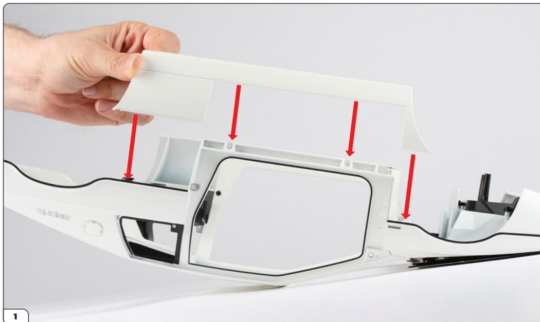
Posizionare con attenzione la carrozzeria (Fase 069) capovolto, utilizzando una superficie morbida per proteggere la vernice. Allineare il pannello laterale sinistro (70-A) con la carrozzeria.
