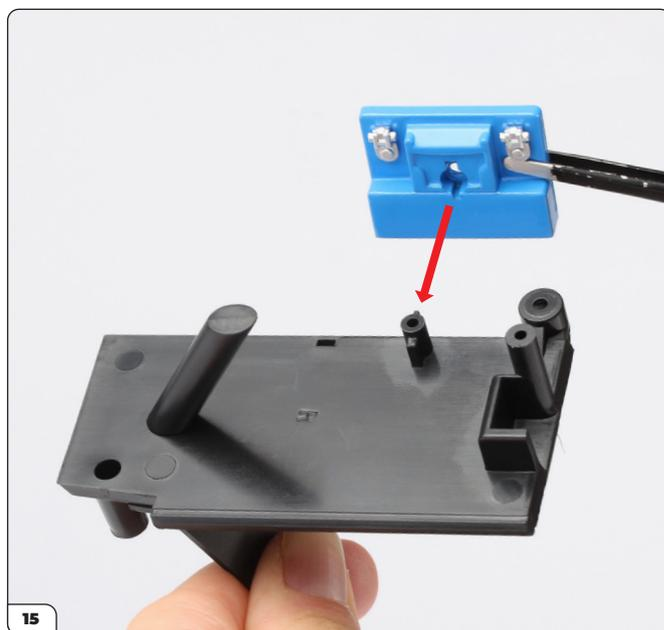
Allinea il coperchio della batteria con la piastra del telaio.
