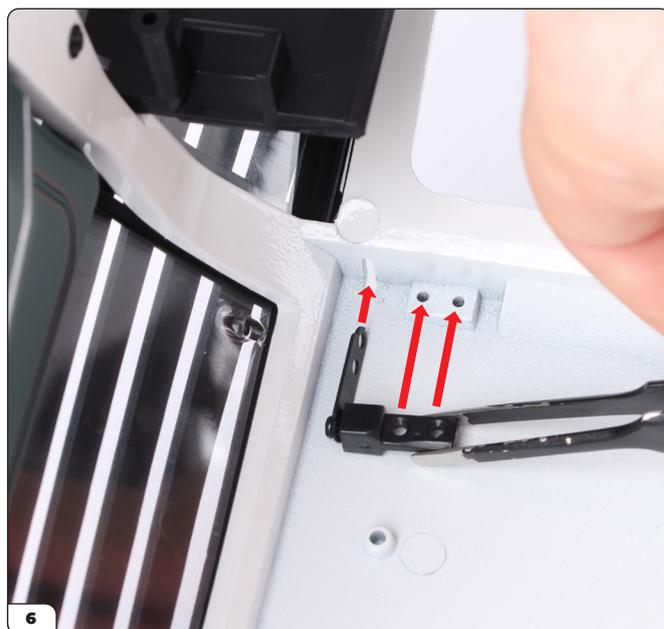
Posizionare con attenzione la carrozzeria (Fase 074) a testa in giù. Allineare la staffa del portellone posteriore sinistro (contrassegnata con "L") e la cerniera con la carrozzeria.
