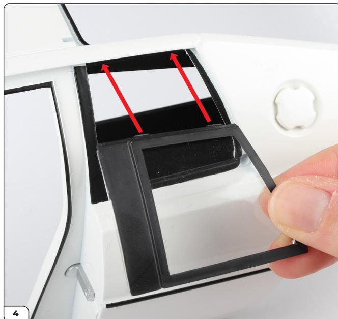
Prendi la carrozzeria e apri la portiera sinistra. Allinea le due linguette sulla parte superiore del telaio con la carrozzeria.
