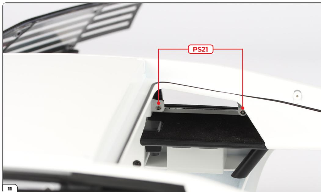
Avvita il telaio laterale alla carrozzeria utilizzando 2 viti PS21.
