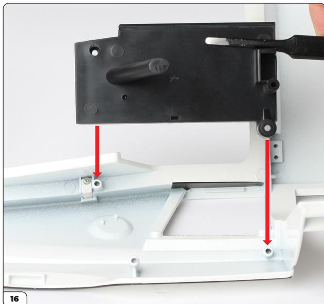
Allinea la piastra del telaio con la carrozzeria.
