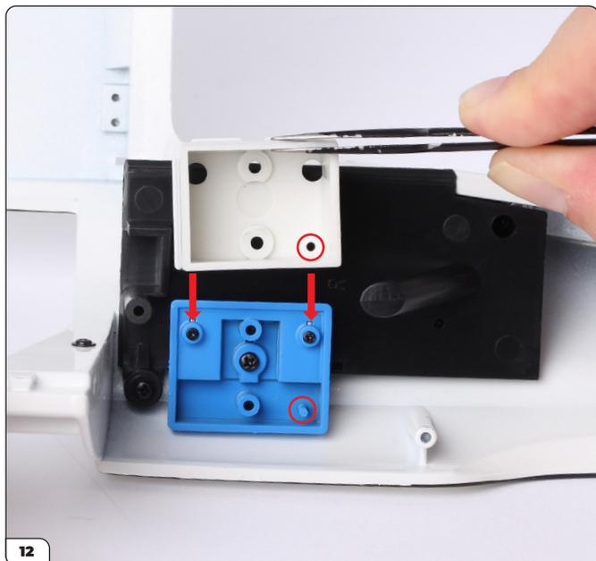
Allinea la batteria (68-B) con il coperchio della batteria (Fase 067). C'è un perno (cerchiato) per garantire che i pezzi siano assemblati correttamente.
