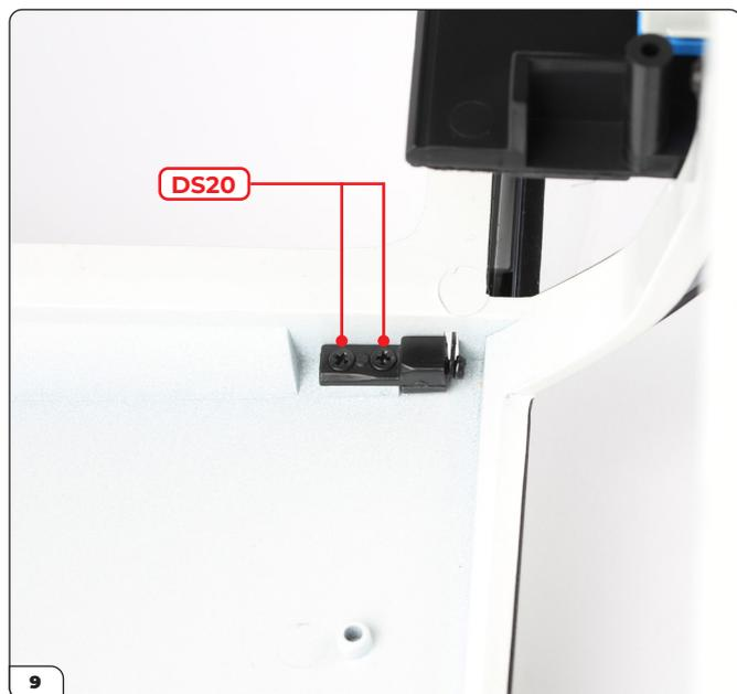
Spingere la cerniera attraverso l'apertura, quindi posizionare la staffa e avvitare alla carrozzeria con 2 viti DS20.
