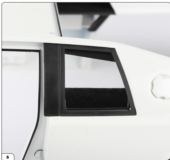
Spingere le linguette in posizione e poi premere il telaio laterale sul corpo principale.
