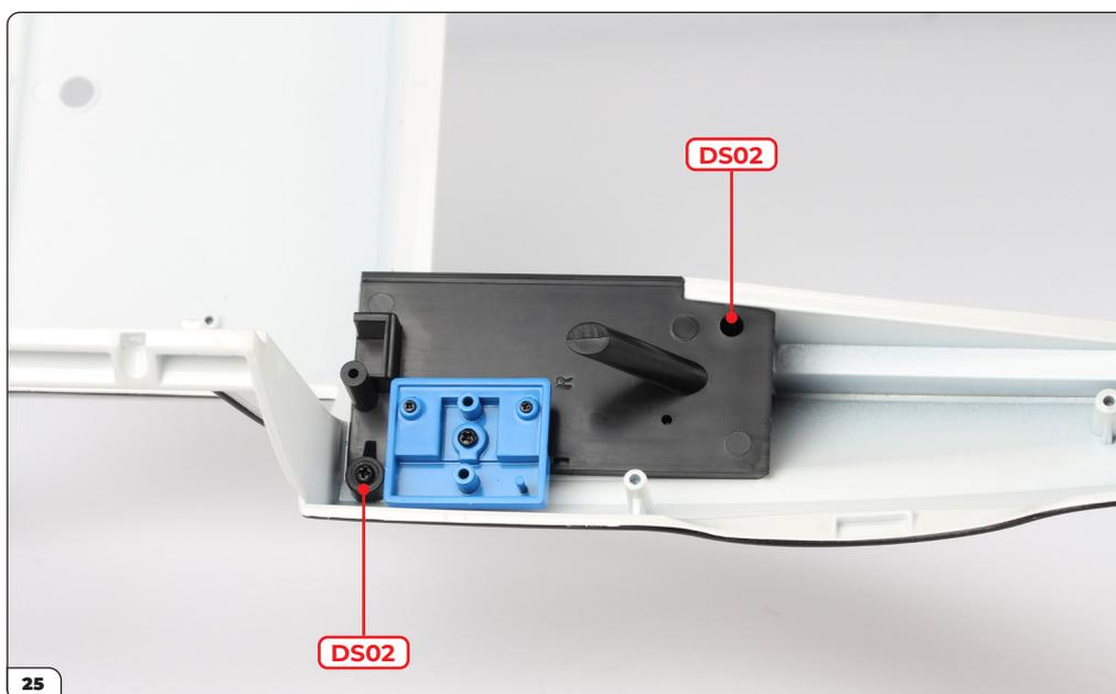
Avvita la piastra destra del telaio alla carrozzeria utilizzando 2 viti DS02.
