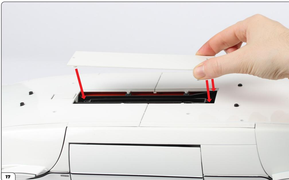
Setzen Sie die Batterieabdeckung (98-A) auf die Baugruppe.
