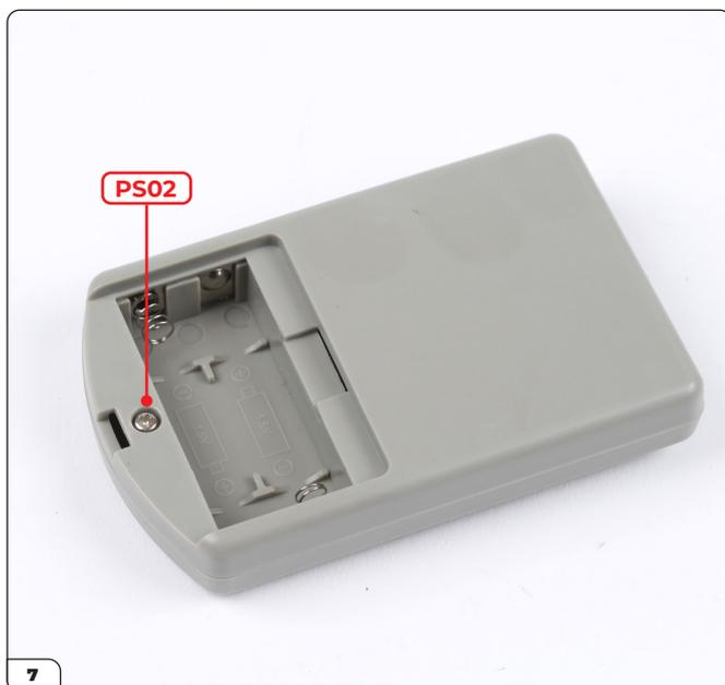
Sichern Sie mit einer PS02 Schraube.
