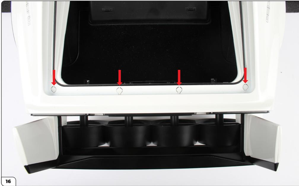
Wenn Sie sie nicht in einer früheren Phase angebracht haben, bringen Sie die vier Kappen (Phase 091) über den Schrauben an.
