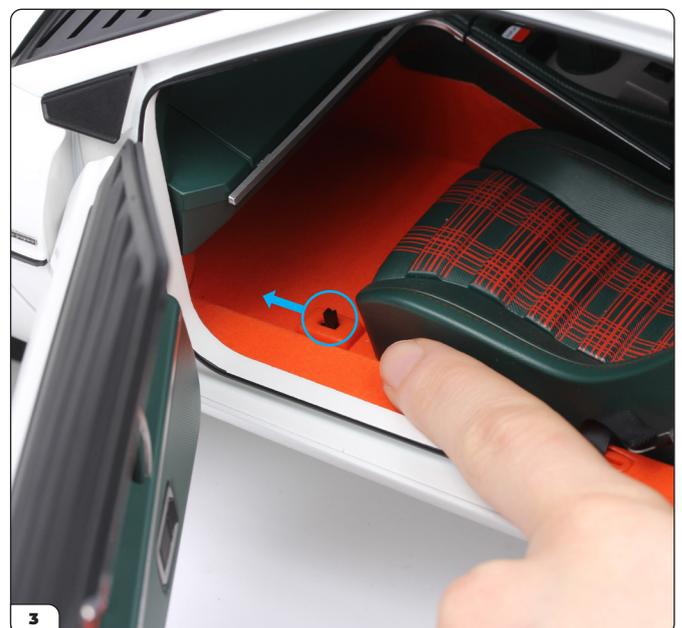
Öffnen Sie die Tür und drücken Sie den Ein/Aus-Schalter in die „ON“-Position.
