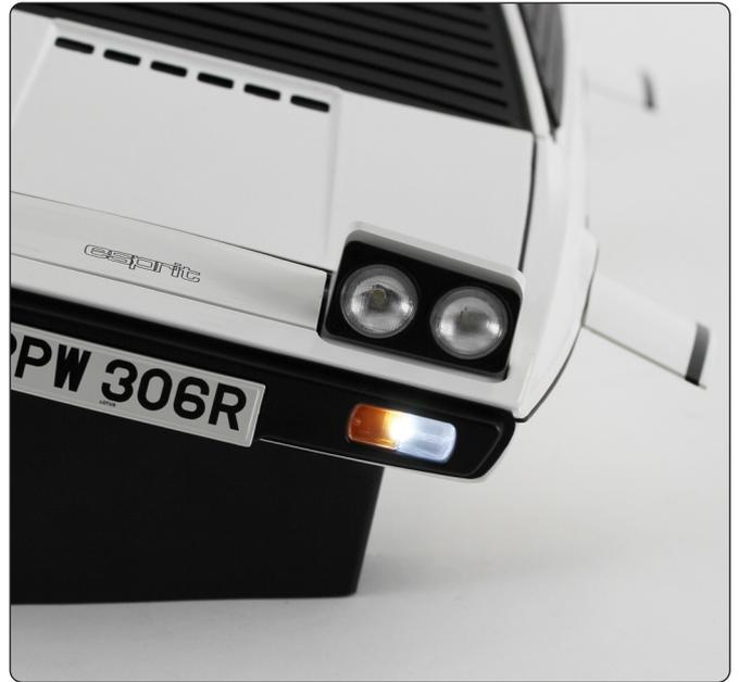
Drücken Sie die Taste 3, um die linken Blinker zu testen. Die linken Blinker vorne und hinten werden blinken.
