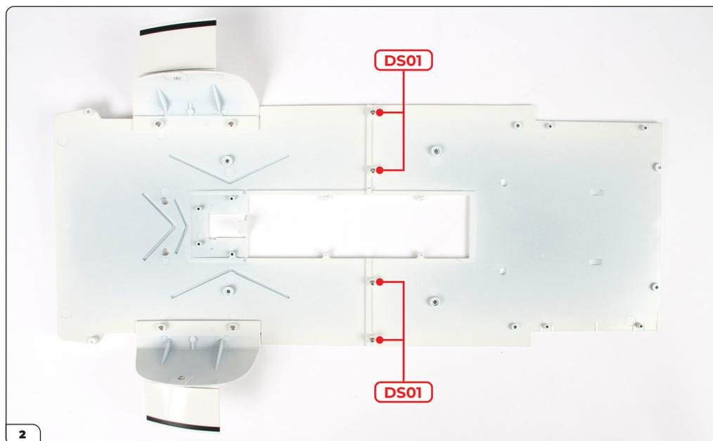
Asegure las partes juntas con 4x tornillos DS01.
