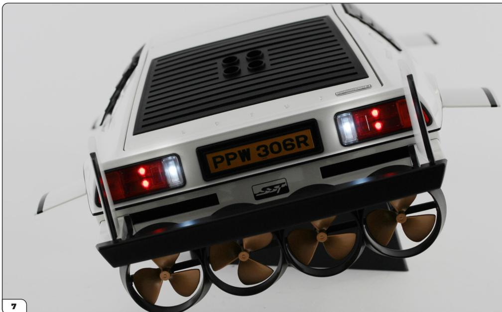
Presione el botón 2 para probar las luces de freno. Las luces traseras brillarán más intensamente.
