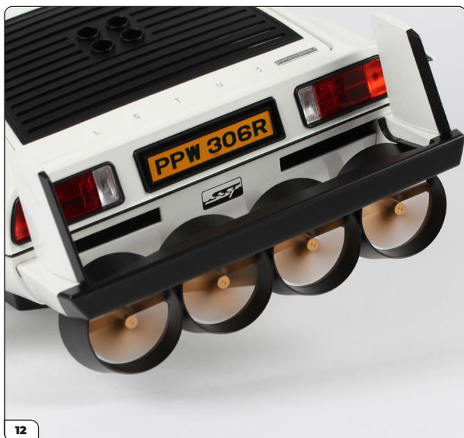
Presione el botón 7 para probar las hélices. Las hélices comenzarán a girar. Todas las funciones eléctricas han sido probadas. Ahora puede mover el interruptor de encendido a la posición 'OFF'.
