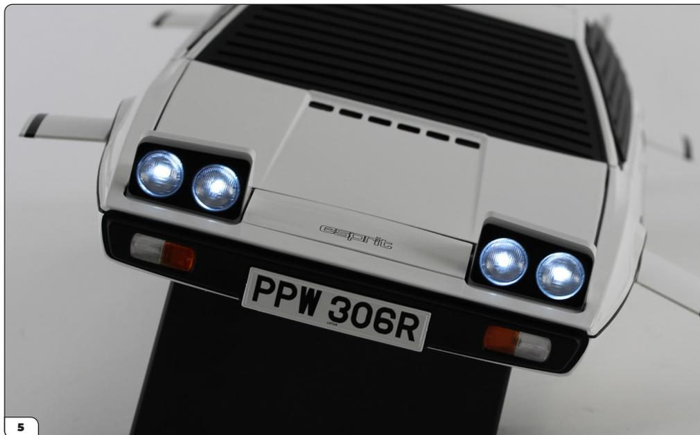
Presione hacia abajo en los faros para abrirlos. Presione el botón 1 para probar las luces delanteras y traseras.
