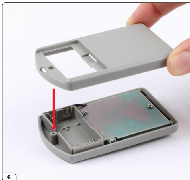
Coloque la parte trasera del control remoto (100-B) en el ensamblaje.
