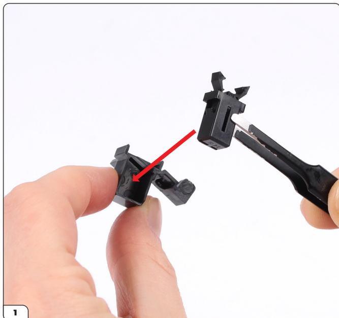
Presione la abrazadera (98-E) en el soporte de la abrazadera (98-C).
