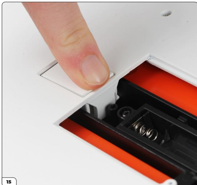
Presione la escotilla de la mina lapa hacia abajo hasta que encaje en la abrazadera para cerrarla.
