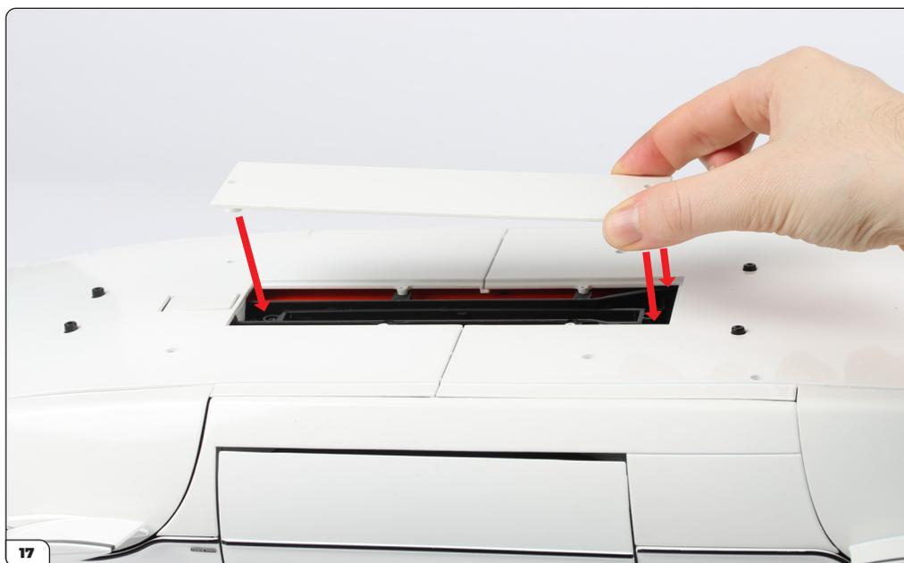
Posiziona il coperchio del vano batterie (98-A) sull'assemblaggio.
