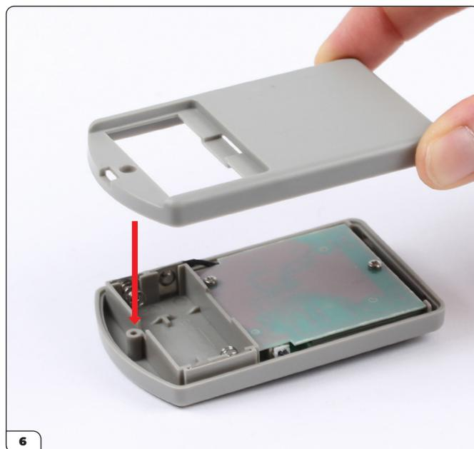
Posiziona il retro del telecomando (100-B) sull'assemblaggio.
