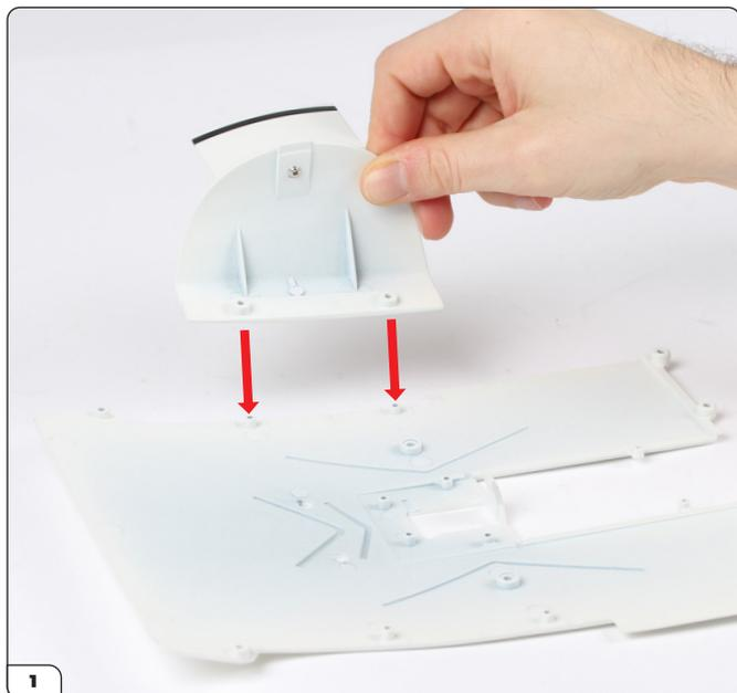
Monta la pinna idroplana anteriore destra (fase 092) sul sottoscocca inferiore anteriore (93-A).
