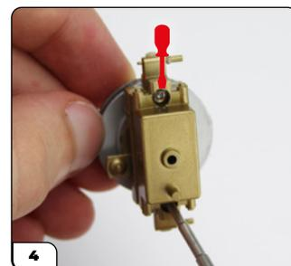
Alinea la lengüeta del conjunto del carburador con el orificio de la carcasa del carburador y coloca el conjunto en la carcasa. Asegúralo en su sitio con un tornillo TIPO OP03.
