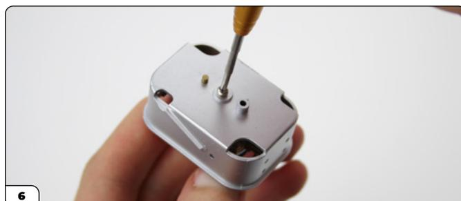
Alinea los lengüetas y los orificios del bloque con la carcasa del carburador y asegúralos con un tornillo TIPO OP03.
