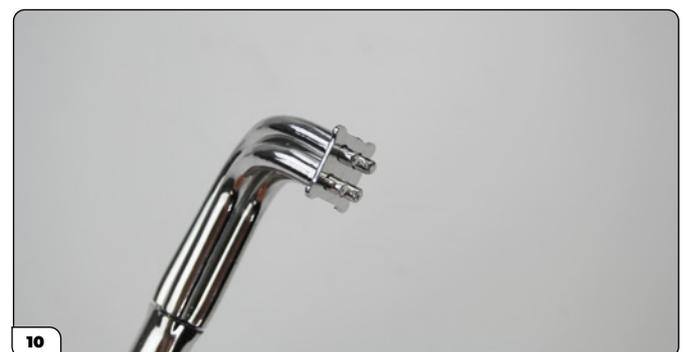
Ten en cuenta la orientación correcta de la placa de escape: las esquinas levantadas deben mirar hacia el exterior, hacia los tubos (imagen 10).
