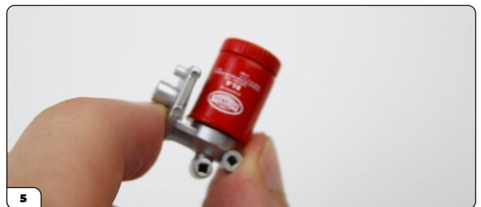
Orienta el espaciador como se muestra y colócalo en el lado del soporte del filtro de aceite. Fijalo con un tornillo TIPO OP03.
