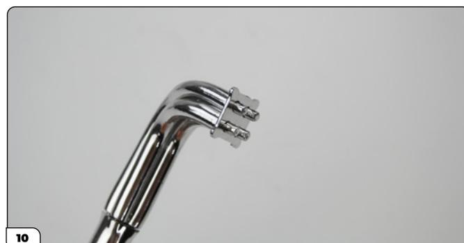
Osserva l'orientamento corretto della piastra di scarico – gli angoli sollevati devono guardare verso i tubi (figura 10).
