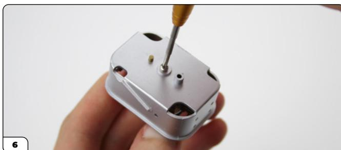
Allinea i perni e i fori sul blocco motore con quelli sull'alloggiamento del carburatore e fissali insieme con una vite di TIPO OP03.
