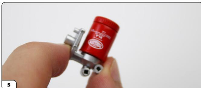
Orienta il distanziatore come mostrato e posizionalo sul supporto del filtro dell'olio. Fissalo in posizione con una vite di TIPO OP03.
