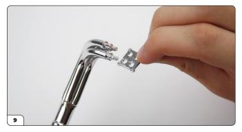
Achten Sie darauf, dass die Auspuffplatte richtig ausgerichtet ist. Die Zapfen müssen nach außen zu den Rohren hin zeigen (Abb. 10).
