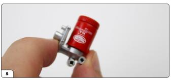
Setzen Sie den Abstandshalter wie gezeigt an der Seite des Ölfilterhalters auf. Befestigen Sie ihn mit einer OP03-Schraube.
